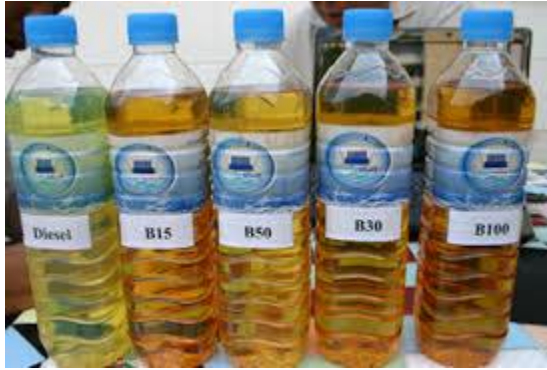
รูปที่ 8.9 แสดงลักษณะน้ำมัน ไบโอดีเซล ที่มา : http://www.manager.co.th,2558
