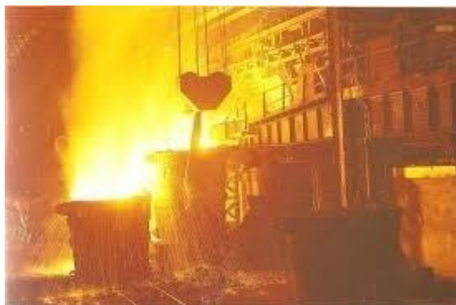
รูปที่ 2.14 แสดงลักษณะการผลิตเหล็กกล้าด้วยเตาโอเพ่นฮาร์ท
