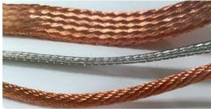
รูปที่ 11.9 แสดงลักษณะสายไฟฟ้าที่ไม่มีฉนวนหุ้ม
