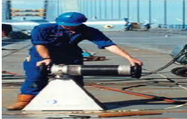
รูปที่ 13.6 แสดงลักษณะการตรวจสอบด้วยรังสีเอกซเรย์ ที่มา : http://www.industry4u.com , 2558
