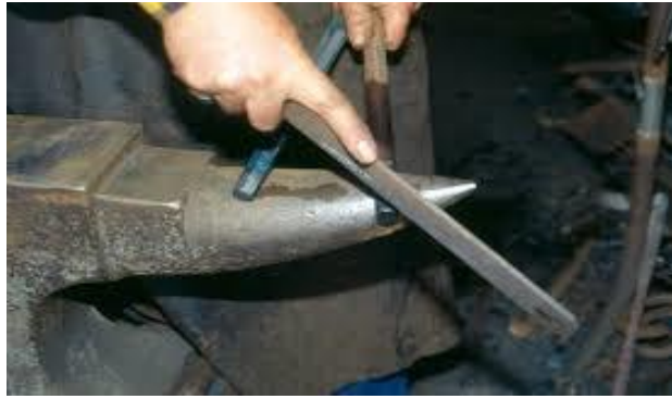
รูปที่ 13.7 แสดงลักษณะการตรวจสอบโดยการตะไบ
