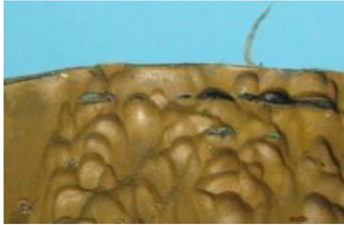
รูปที่ 12.7 แสดงลักษณะการกัดกร่อนแบบเลือก
