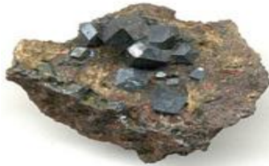
รูปที่ 2.1 แสดงลักษณะสินแร่เหล็กแมกนีไทต์
