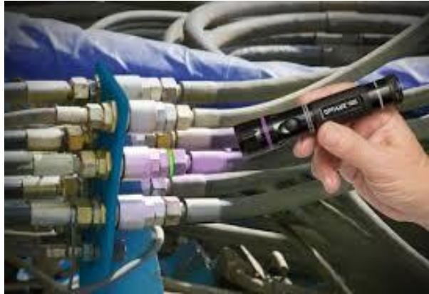
รูปที่ 13.4 แสดงลักษณะการตรวจสอบด้วยน้ำมัน
