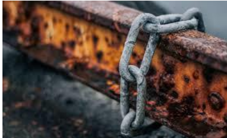
รูปที่ 12.1 แสดงลักษณะการกัดกร่อนของชิ้นงาน
