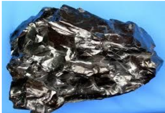
รูปที่ 8.5 แสดงลักษณะแอนทราไซต์ ที่มา : http://www.thaicapital.co.th/index,2558
