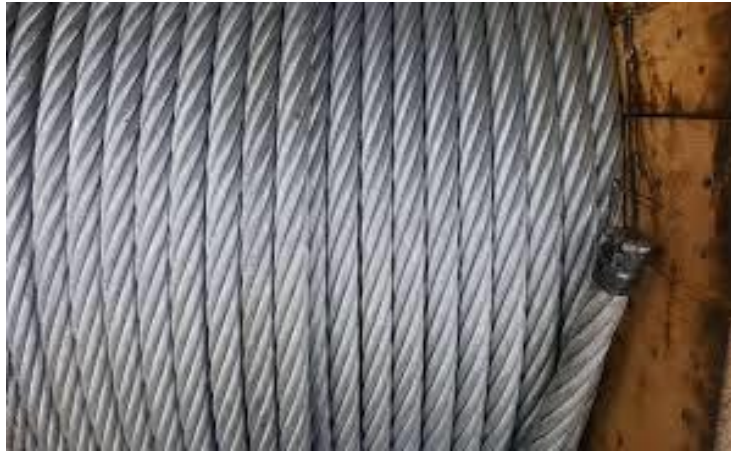
รูปที่ 7.3 แสดงลักษณะลวดเหล็กกล้าตีเกลียว
