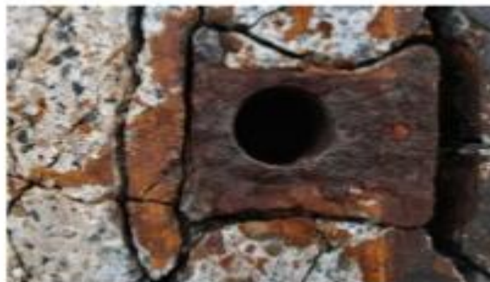
รูปที่ 12.4 แสดงลักษณะการกัดกร่อนแบบช่องแคบ
