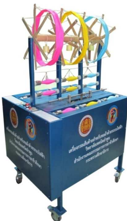
ภาพที่ 1 เครื่องกรอเส้นด้ายสำหรับทอผ้าด้วยระบบไฟฟ้า
