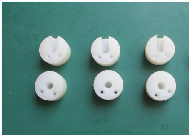
ภาพที่ 99 ซุปเปอร์ที่เจาะรูและกัดร่องเรียบรื้อแล้วตามแบบ ที่มา : สมพร อ่อนเกตุพล, 2557
