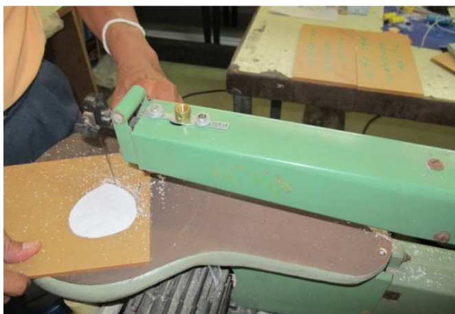
ภาพที่ 79 การตัดงานหมุนหลอดเล็กด้วยเครื่องเลื่อยฉลุ ที่มา : สมพร อ่อนเกตุพล, 2557
