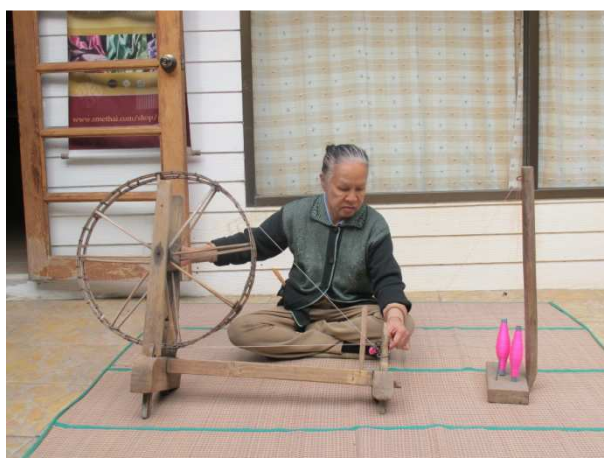
ภาพที่ 68 การกรอเส้นด้ายสำหรับทอผ้าโดยใช้เครื่องกรอเส้นด้ายแบบดั้งเดิม (2) ที่มา : สมพร อ่อนเกตุพล, 2557
