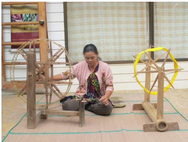
ภาพที่ 2 เครื่องกรอเส้นด้ายสำหรับทอผ้าแบบดั้งเดิม ที่มา : สมพร อ่อนเกตุพล, 2557
