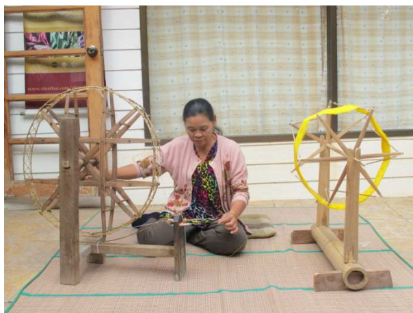
ภาพที่ 67 การกรอเส้นด้ายสำหรับทอผ้าโดยใช้เครื่องกรอเส้นด้ายแบบดั้งเดิม (1) ที่มา : สมพร อ่อนเกตุพล, 2557
