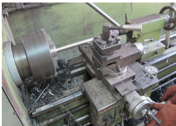
ภาพที่ 90 การกลึงแกนสแตนเลสตามแบบ ที่มา : สมพร อ่อนเกตุพล, 2557
