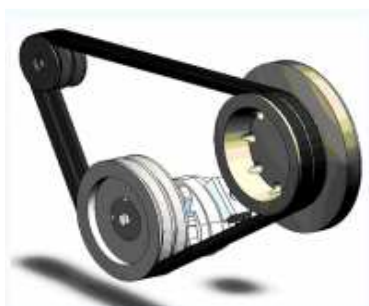
ภาพที่ 31 การทำงานของสายพานส่งกำลัง ที่มา : บุญธรรม นิธิอุทัย และชลดา เลวิส, 2541
