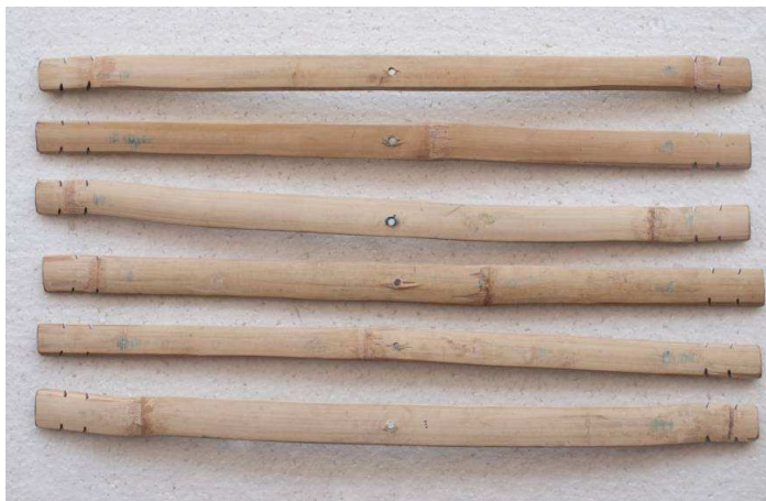
ภาพที่ 103 ไม้ไผ่ที่ตัดแบ่งเป็นซี่ เจาะรูตรงกลาง และ ข้วนขอบตรงปลายไม้ทั้ง 2 ด้าน ที่มา : สมพร อ่อนเกตุพล, 2557
