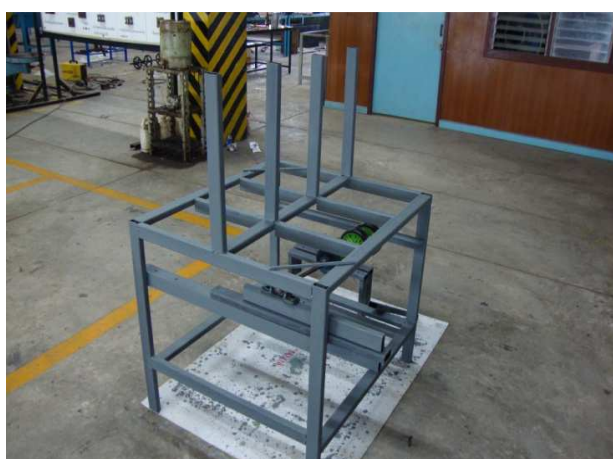
ภาพที่ 73 โครงสร้างเครื่องกรอเส้นด้ายสำหรับทอผ้าด้วยระบบไฟฟ้าที่ทาสีกันสนิมแล้ว ที่มา : สมพร อ่อนเกตุพล, 2557
