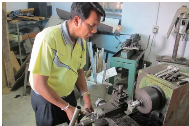
ภาพที่ 89 การกลึงสแตนเลสตามแบบ ที่มา : สมพร อ่อนเกตุพล, 2557
