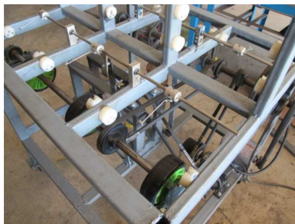
ภาพที่ 75 การติดตั้งกลไกการทำงานของเครื่องกรอเส้นด้ายสำหรับทอผ้าด้วยระบบไฟฟ้า ที่มา : สมพร อ่อนเกตุพล, 2557
