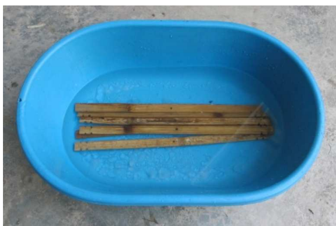
ภาพที่ 104 การแช่ซี่ไม้ไผ่ลงในน้ำที่ละลายสารส้ม ที่มา : สมพร อ่อนเกตุพล, 2557
