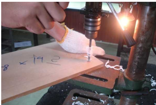
เจาะรูแผ่นอะคริลิกเพื่อยึดมอเตอร์และฐานรอง
