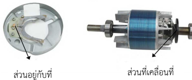
ภาพที่ 106 สวิตช์แรงเหวี่ยงหนีศูนย์กลาง (2)
