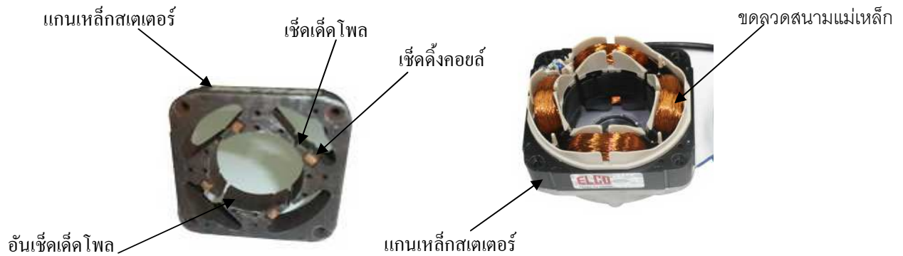
ภาพที่ 153 สเตเตอร์ของเซ็ดเค็ด โพลมอเตอร์ ที่มา : สมพร อ่อนเกตุพล, 2557
