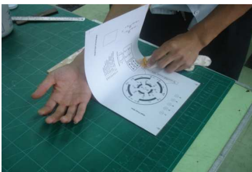
ติดแผ่นร่างวงจรบนแผ่นอะคริลิค
