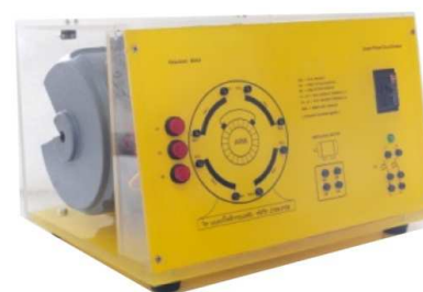
ภาพที่ 231 ชุดฝึกทักษะรีฟลักซ์สตาร์ทอินดักชั่นมอเตอร์ (3)
