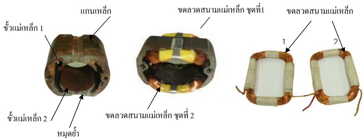
ภาพที่ 163 สเตเตอร์และขดลวดสนามแม่เหล็กของยูนิเวอร์แซลมอเตอร์
