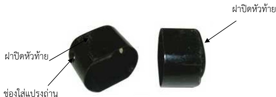
ภาพที่ 165 ฝาปิดหัวท้ายของยูนิเวอร์แซลมอเตอร์
