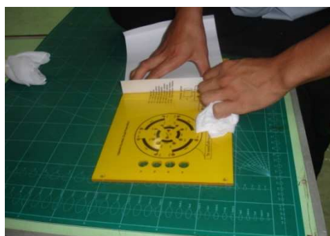
ติดแผ่นสติ๊กเกอร์วงจรซิงเกิลเฟสมอเตอร์ลงบน แผ่นอะคริลิก และรีดให้เรียบ
