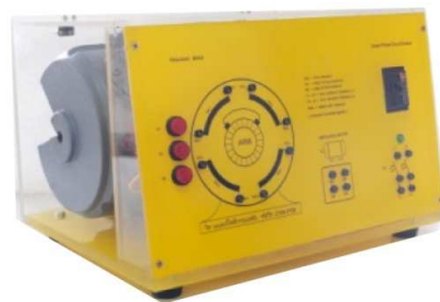
ภาพที่ 227 ชุดฝึกทักษะรีฟลัชนั้สตาร์ทอินคั้ชั้นมอเตอร้
