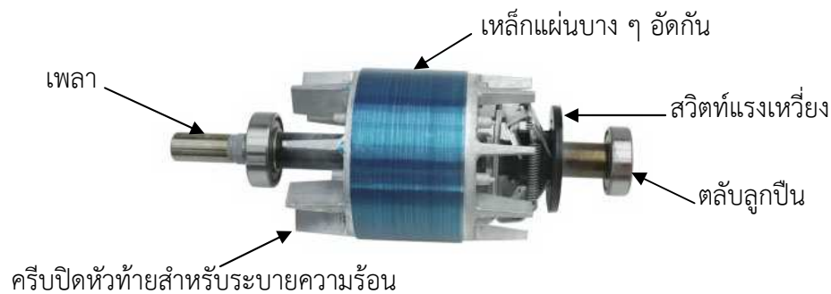
ภาพที่ 105 โรเตอร์แบบกรงกระรอก (2)
