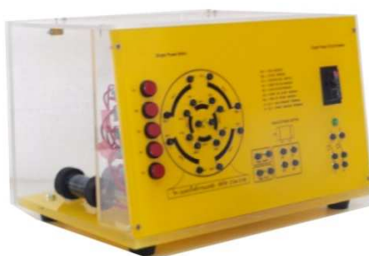
ภาพที่ 203 ชุดฝึกทักษะซิงเกิลเฟสมอเตอร์ (6)
