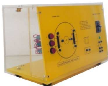
ภาพที่ 221 ชุดฝึกทักษะยูนิเวอร์แซลมอเตอร์ ที่มา : สมพร อ่อนเกตุพล, 2557
