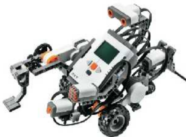
รูปที่ 10.1 หุ่นยนต์อัตโนมัติขนาดเล็ก Lego Mindstorms 22
