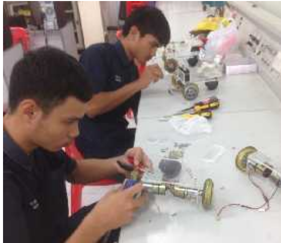
รูปที่ 3.2 การประกอบมอเตอร์กับล้อเข้ากับตัวหุ่นยนต์
