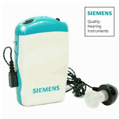
แผนภาพที่ 7 เครื่องช่วยฟังแบบกล่องระบบอนาล็อก
