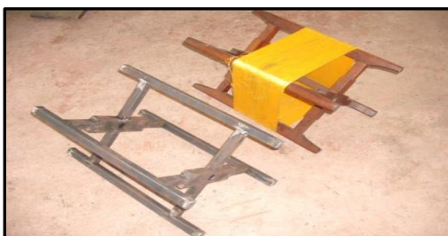
ภาพที่ 3-6 แสดง การเชื่อมประกอบอักษว์ไกใหม่แบบโลหะ
