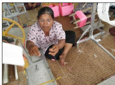
ภาพแสดง การคล้องปลายเส้นไหมเข้ากับอ๊กกวักไหม
