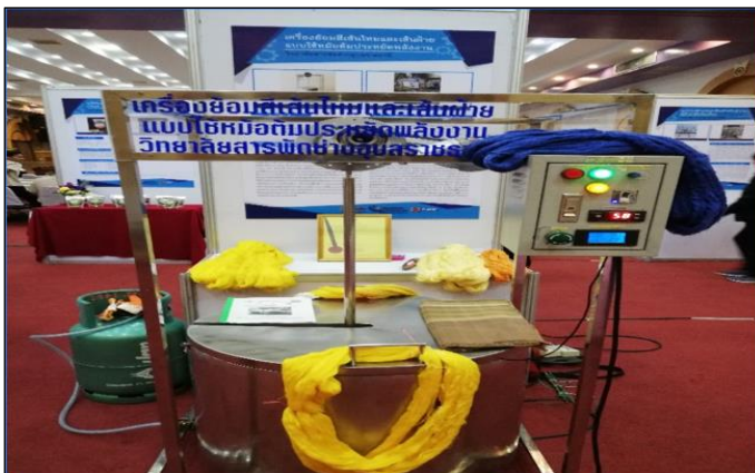
ภาพที่ 3 แสดงโครงการทดลองและวิจัยเครื่องย้อมสีเส้นไหมและฝ้าย (ที่มา : วทัญญู บุตรศรี, 2561)
