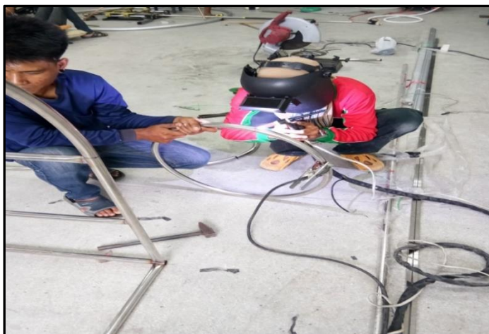
ภาพที่ 3-18 แสดง การเชื่อมประกอบเพื่อขึ้นรูปโครงสร้างเครื่อง
