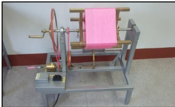
ภาพที่ 3-26 แสดง เครื่องกักเส้นไหมและเส้นฝ้ายมีระบบปั่นหลอดด้ายที่ประดิษฐ์ขึ้น
