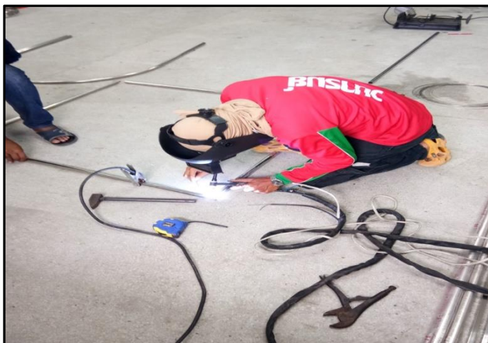
ภาพที่ 3-9 แสดง การเชื่อมท่อสแตนเลสเพื่อจัดทำโครงสร้างเครื่อง
