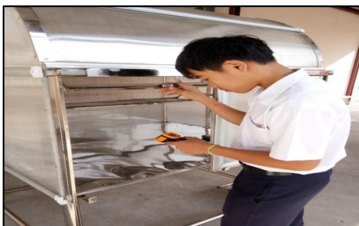
ภาพที่ 4-6 แสดง การทดสอบเพื่อวัดอุณหภูมิภายในเครื่อง
