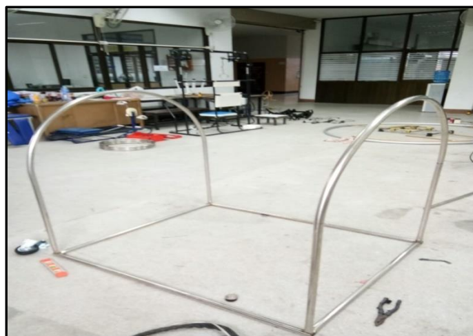
ภาพที่ 3-17 แสดง การประกอบเพื่อขึ้นรูปโครงสร้างเครื่อง ตามขนาดที่ออกแบบไว้
