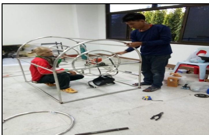
ภาพที่ 3-20 แสดง การขึ้นรูปและการประกอบชุดถาดหมุนเข้ากับเครื่องอบปลาแก้ว
