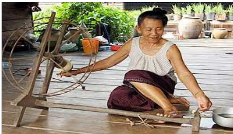
ภาพที่ 1-2 แสดง โนเป็นเครื่องมือที่ใช้ในการปั่นหลอดด้ายของชาวบ้าน
