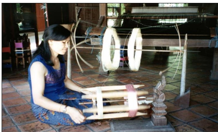
ภาพที่ 1-1 แสดง กงและอ๊กกวกไหมเป็นเครื่องมือที่ใช้ในการรวักเส้นไหมของชาวบ้าน
