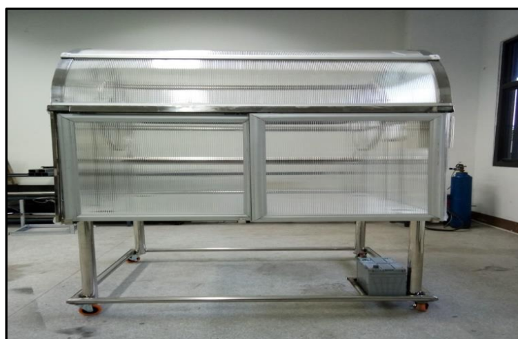
ภาพที่ 3-26 แสดง ประตูด้านหน้าของเครื่องอบแห้งปลาแก้วระบบหมุนวนโดยใช้พลังงานแสงอาทิตย์
