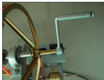
ภาพแสดง การสวมด้ามจับประกอบเข้ากับแกนเพลลาเครื่อง
