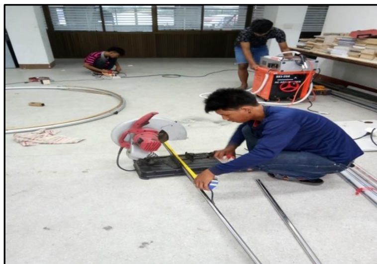
ภาพที่ 3-5 แสดง การวัดระยะความยาวของท่อสแตนเลสเพื่อจัดทำโครงสร้างเครื่อง
