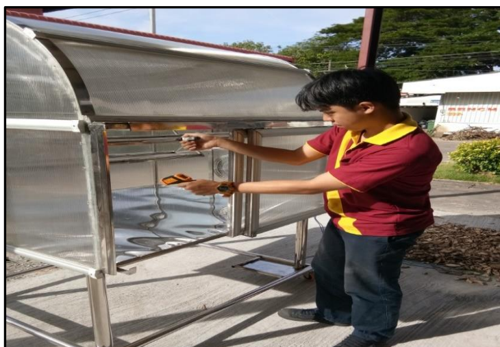
ภาพที่ 4-2 แสดง การทดสอบเพื่อวัดจุดดุนหภูมิภายในเครื่อง
