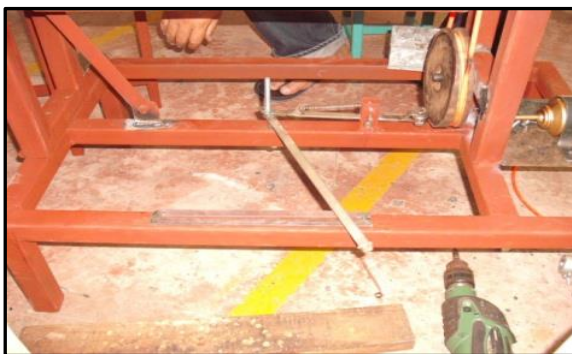
ภาพที่ 3-11 แสดง การติดตั้งลูกเบี้ยวช่วยกระจายเส้นไหมและทดสอบลูกกลิ้งบนผิวหน้า
