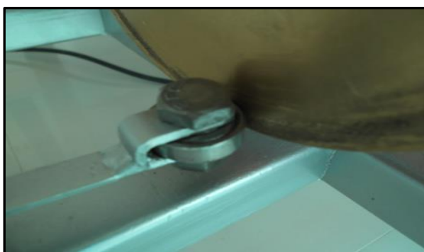
ภาพที่ 3-18 แสดง การติดตั้งลูกกลิ้งให้สัมผัสกับผิวหน้าของชุดลูกเบี้ยวช่วยกระจายเส้นไหม
