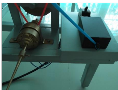
ภาพแสดง การปรับชุดควบคุมความเร็วรอบเพื่อให้เครื่องทำงาน
