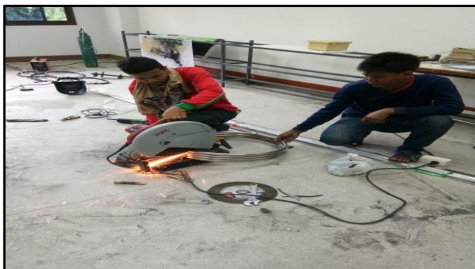
ภาพที่ 3-12 แสดง การตัดท่อสแตนเลสเพื่อจัดทำชุดถาดหมุน
