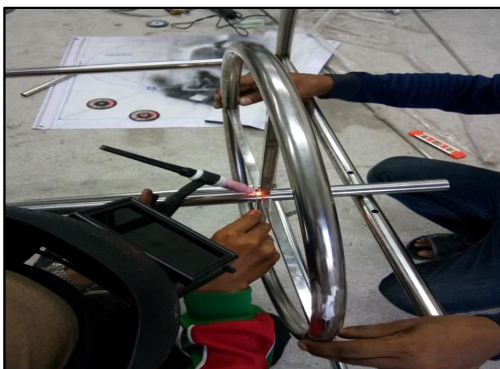
ภาพที่ 3-13 แสดง การเชื่อมท่อสแตนเลสเพื่อจัดทำชุดถาดหมุน
