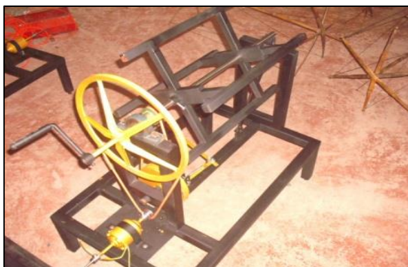
ภาพที่ 3-8 แสดง การประกอบโครงสร้างเครื่อง และการติดตั้งพูลเลย์ที่แกนเพลลาเครื่อง
