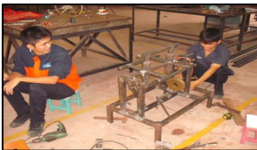
ภาพที่ 3-3 แสดง การประกอบและขึ้นรูปโครงสร้างเครื่อง
