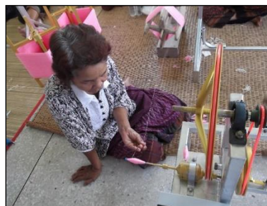
ภาพแสดง การปั่นหลอดด้ายไปพร้อมกับการกักเส้นไหมและเส้นฝ้าย
