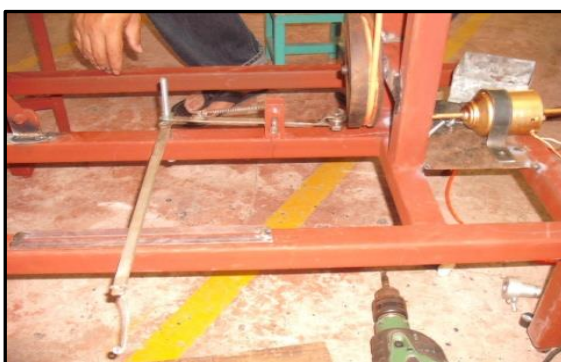
ภาพที่ 3-10 แสดง การติดตั้งชุดแขนสายแกนกวักเส้นไหม
