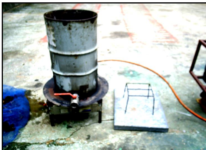
ภาพที่ 21 แสดง ชิ้นส่วนของหม้อต้มแบบดั้งเดิมของเกษตรกร
