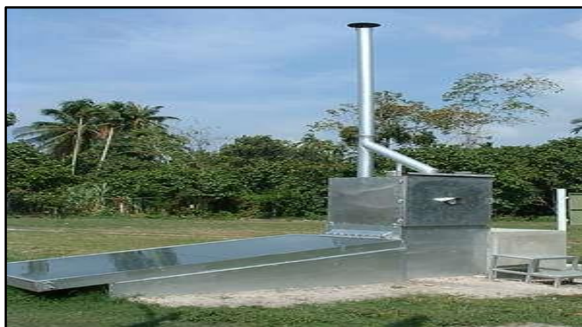
ภาพที่ 2-3 แสดง เครื่องอบแห้งพลังงานแสงอาทิตย์แบบผสมผสาน
