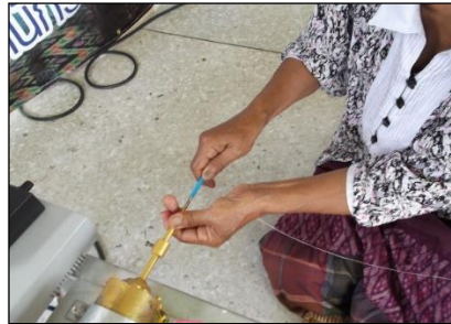
ภาพแสดง การสวมแกนปั่นหลอดด้ายเข้าที่ปลายเพลลาของมอเตอร์
