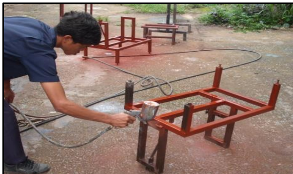
ภาพที่ 3-9 แสดง การพ่นสีรองพื้นกันสนิมตัวเครื่อง
