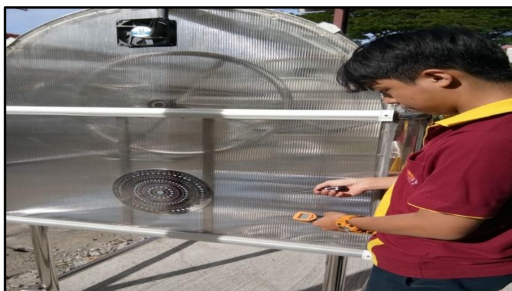
ภาพที่ 4-3 แสดง การทดสอบเพื่อวัดจุดดุนหภูมิภายนอกเครื่อง
