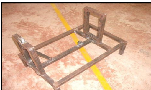
ภาพที่ 3-4 แสดง การประกอบขึ้นรูปโครงสร้างเครื่อง
