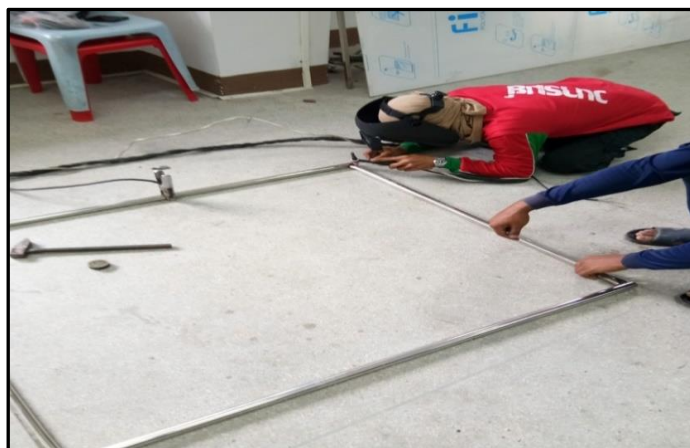
ภาพที่ 3-7 แสดง การเชื่อมต่อสแตนเลสเพื่อจัดทำโครงสร้างเครื่อง
