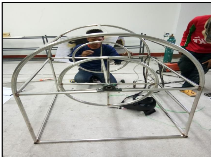
ภาพที่ 3-21 แสดง การขึ้นรูปและการประกอบชุดเฟลาหมุนเข้ากับเครื่องอบปลาแก้ว
