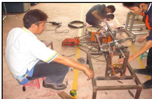
ภาพที่ 3-7 แสดง การเชื่อมประกอบโครงสร้างเครื่อง และการทดสอบติดตั้งอักษว์ไกใหม่แบบโลหะ
