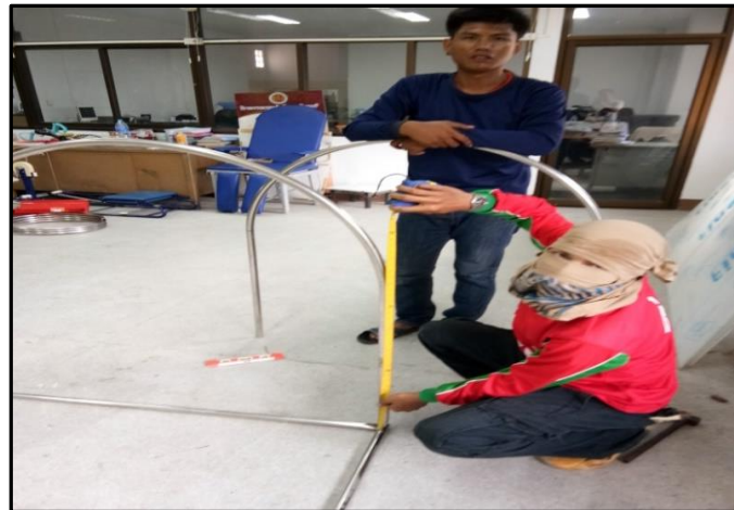
ภาพที่ 3-16 แสดง การวัดระยะเพื่อจัดทำโครงสร้างเครื่อง ตามขนาดที่ออกแบบไว้
