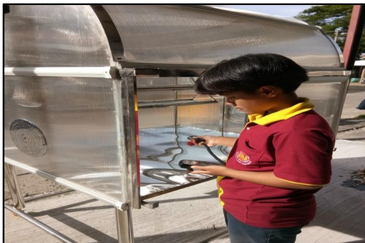
ภาพที่ 4-4 แสดง การทดสอบเพื่อวัดอุณหภูมิภายในเครื่อง
