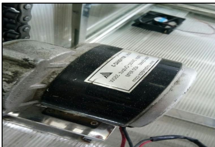
ภาพที่ 3-22 แสดง การติดตั้งต้นกำลังชุดถาดหมุนของเครื่องอบปลาแก้ว
