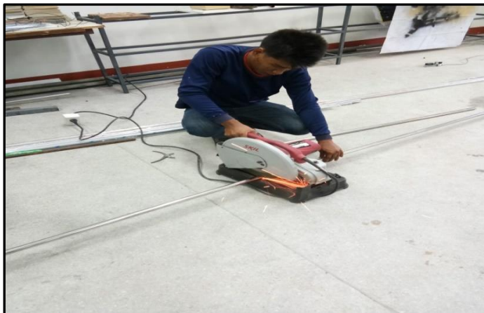
ภาพที่ 3-6 แสดง การตัดท่อสแตนเลสเพื่อจัดทำโครงสร้างเครื่อง
