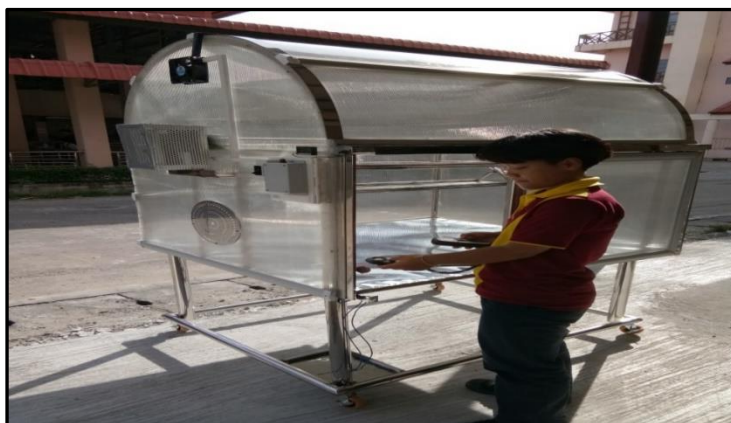
ภาพที่ 4-5 แสดง การทดสอบเพื่อวัดความเข้มของแสงภายนอกเครื่อง
