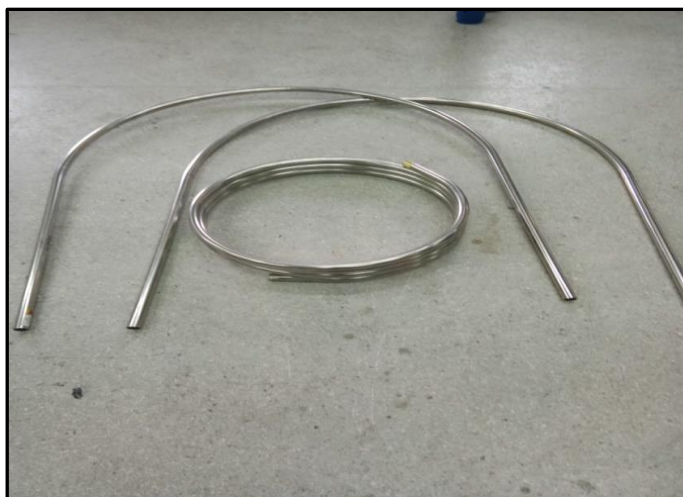
ภาพที่ 3-10 แสดง การตัดท่อสแตนเลสเพื่อจัดทำโครงสร้างเครื่อง ส่วนโครงหลังคาและชุดถาดหมุน
