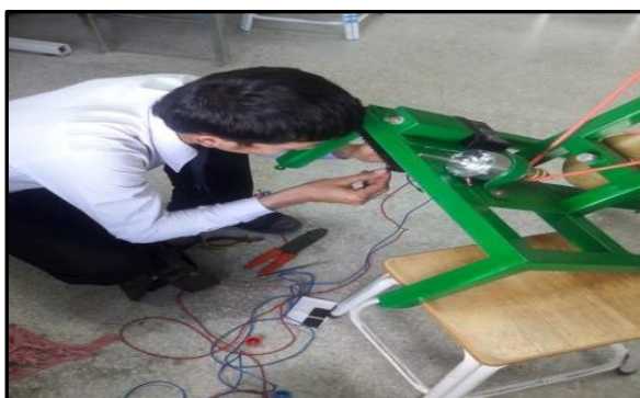
ภาพที่ 3-12 แสดง การติดตั้งชุดควบคุมระบบไฟฟ้าและประกอบวงจร
