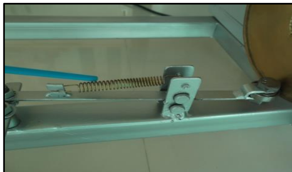
ภาพที่ 3-19 การติดตั้งชุดสปริงช่วยในการดึงกลับไปในระหว่างที่ลูกกลิ้งสัมผัสกับผิวหน้า
