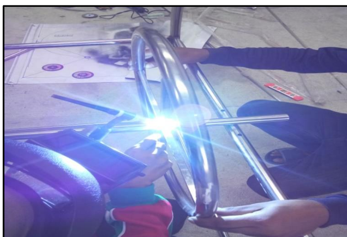
ภาพที่ 3-14 แสดง การเชื่อมท่อสแตนเลสเพื่อจัดทำชุดถาดหมุน
