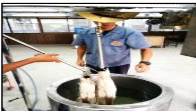
ภาพที่ 3-72 แสดงการทดสอบใส่เส้นไหมประกอบเข้ากับชุดแกนยกเส้นไหม (ที่มา : วทัญญู บุตรศรี, 2561)
