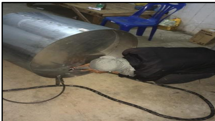
ภาพที่ 3-29 แสดงการเชื่อมและประกอบหม้อย้อมสีของเครื่องในรุ่นที่ 2 (ที่มา : วทัญญู บุตรศรี, 2560)
