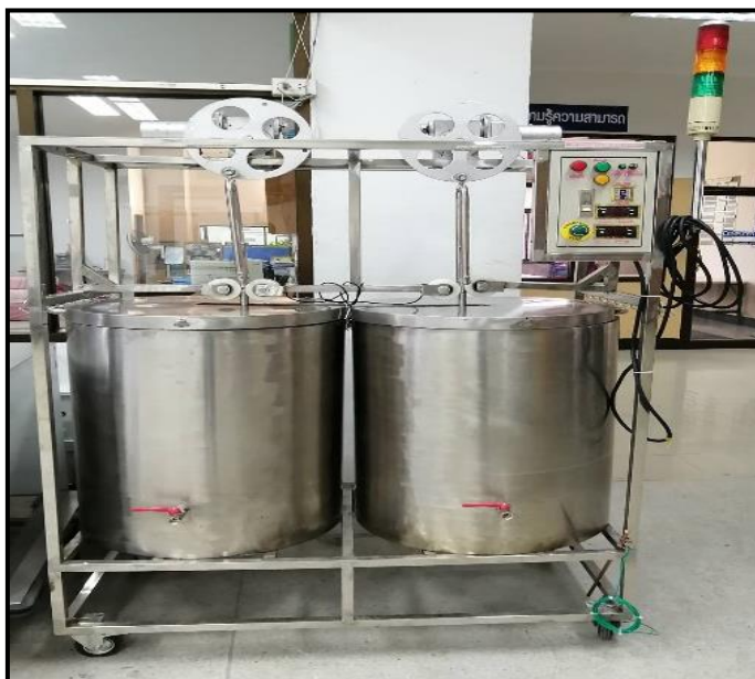
ภาพที่ 3-166 แสดงเครื่องย้อมสีเส้นไหมและฝ้ายแบบใช้หม้อต้มประหยัดพลังงาน ในวงจรที่ 5 (ที่มา : วทัญญู บุตรศรี, 2562)
