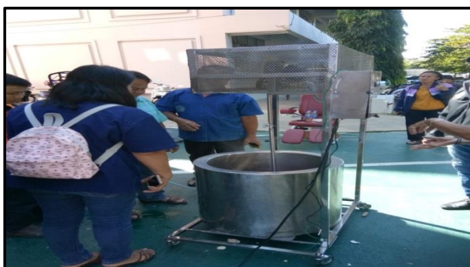
ภาพที่ 3-105 แสดงตัวแทนชุมชนบ้านคำขวางได้นำเครื่องข้อมสีเส้นไหมและฝ้าย แบบใช้หม้อต้มประหยัดพลังงาน รุ่นที่ 4 ไปใช้งานจริง (ที่มา : วทัญญู บุตรศรี, 2561)
