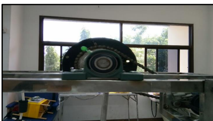
ภาพที่ 3-67 แสดงชุดต้นกำลังประกอบเข้ากับมอเตอร์ไฟฟ้ากระแสตรง ขนาด 24 โวลต์ (ที่มา : วทัญญู บุตรศรี, 2561)
