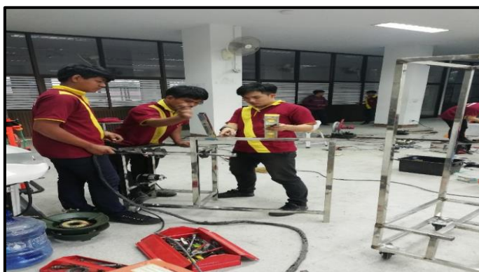
ภาพที่ 3-7 แสดงการประกอบโครงสร้างเครื่อง และชุดฐานรองเครื่อง (ที่มา : วัทัญญ บุตรศรี, 2560)
