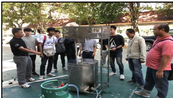
ภาพที่ 3-103 แสดงการทดสอบระบบในการทำงานของเครื่องข้อมสีเส้นไหมและฝ้าย แบบใช้หม้อต้มประหยัดพลังงาน รุ่นที่ 4 (ที่มา : วทัญญู บุตรศรี, 2561)
