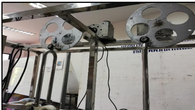
ภาพที่ 3-131 แสดงการทดสอบชุดเพลาส่งกำลังเข้ากับมอเตอร์เกียร์ขนาดแรงดันไฟฟ้า 24 โวลต์ (ที่มา : วทัญญู บุตรศรี, 2562)
