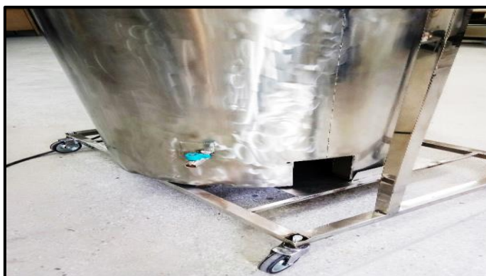
ภาพที่ 3-65 แสดงการประกอบหม้อย้อมสีเข้ากับโครงสร้างเครื่อง (ที่มา : วทัญญู บุตรศรี, 2561)
