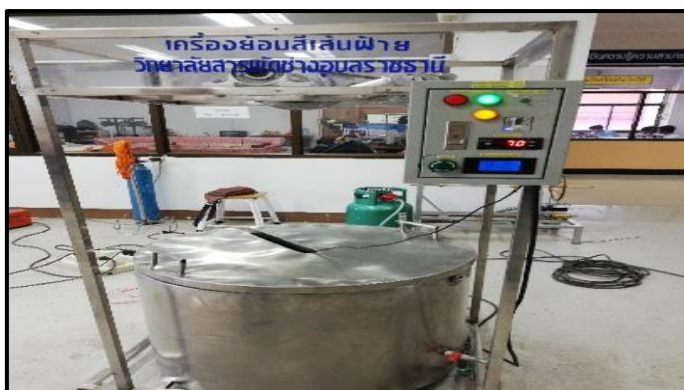
ภาพที่ 3-102 แสดงการทดสอบระบบการทำงานของเครื่องต้มสีเส้นไหมและฝ้ายในรุ่นที่ 4 (ที่มา : วทัญญู บุตรศรี, 2561)
