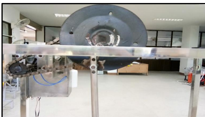
ภาพที่ 3-36 แสดงการประกอบและติดตั้งระบบช่วยส่งกำลังของชุดแกนยกเส้นไหม (ที่มา : วทัญญู บุตรศรี, 2560)
