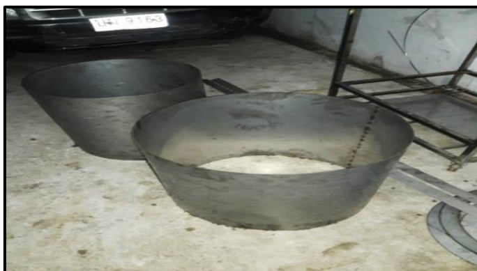
ภาพที่ 3-82 แสดงการเชื่อมและประกอบหม้อย้อมสีชั้นในและชั้นนอก (ที่มา : วัทัญญ บุตรศรี, 2561)
