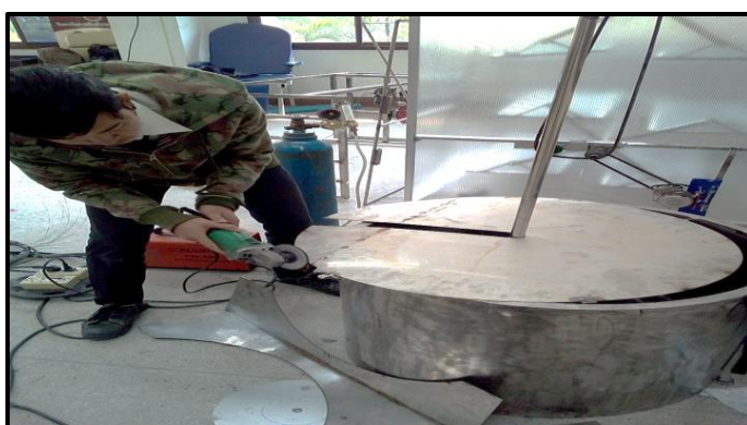
ภาพที่ 3-61 แสดงการประกอบฝาปิดหม้อย้อมสีเส้นไหมและเส้นฝ้าย (ที่มา : วทัญญู บุตรศรี, 2561)
