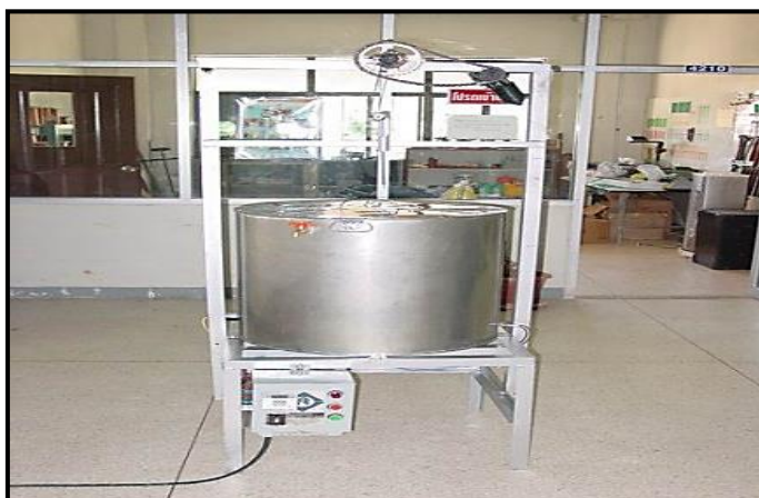
ภาพที่ 3-45 แสดงเครื่องย้อมสีเส้นไหมและฝ้ายแบบใช้หม้อต้มประหยัดพลังงาน รุ่นที่ 2 (ที่มา : วัทัญญ บุตรศรี, 2560)
