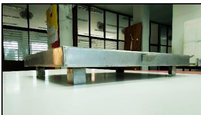
ภาพที่ 3-9 แสดงฝาปิดหม้อย้อมสีแบบสี่เหลี่ยมและที่จับบริเวณด้านข้าง (ที่มา : วัทัญญ บุตรศรี, 2560)
