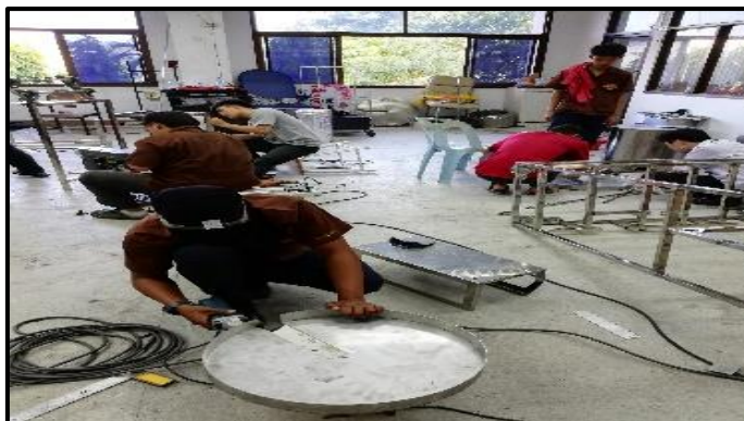
ภาพที่ 3-128 แสดงการตัดแผ่นสแตนเลสเพื่อจัดทำฝามือย้อมสี (ที่มา : วทัญญู บุตรศรี, 2562)
