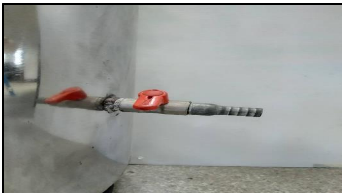
ภาพที่ 3-91 แสดงการติดตั้งท่อระบายน้ำทิ้งของเครื่อง (ที่มา : วทีญญ บุตรศรี, 2561)
