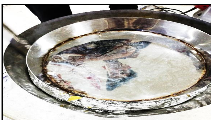
ภาพที่ 3-31 แสดงการติดตั้งไส้ฉนวนกันความร้อนรอบหม้อย้อมสี และใช้ไม้กดลงให้แน่น (ที่มา : วทัญญู บุตรศรี, 2560)
