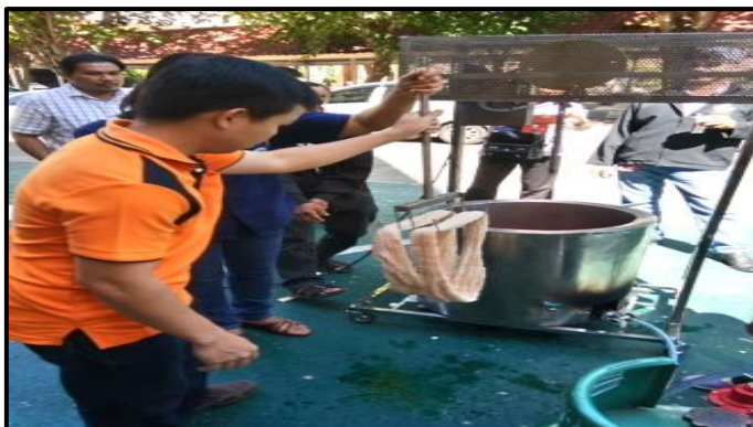
ภาพที่ 3-109 แสดงวิธีการสาธิตการนำเส้นไหมใส่เข้ากับชุดแกนยกเส้นไหม (ที่มา : วทีญญ บุตรศรี, 2561)
