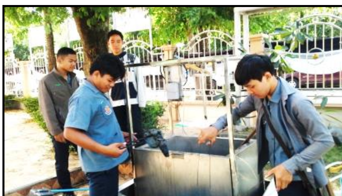
ภาพที่ 3-21 แสดงการนำเครื่องย้อมสีเส้นไหมและฝ้าย ฯ รุ่นที่ 1 ไปทดสอบใช้งานจริง (ที่มา : วทัญญู บุตรศรี, 2560)
