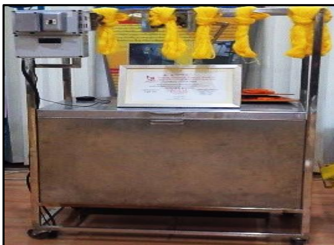
ภาพที่ 3-1 แสดงเครื่องย้อมสีเส้นไหมและฝ้ายแบบใช้หม้อต้มประหยัดพลังงาน รุ่นที่ 1 (ที่มา : วทัญญู บุตรศรี, 2560)
