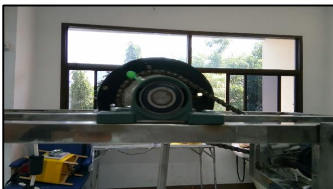
ภาพที่ 3-63 แสดงโครงสร้างของชุดเฟลาส่งกำลังเพื่อใช้ในการช่วยยกเส้นไหมแทนมือชาวบ้าน (ที่มา : วทัญญู บุตรศรี, 2561)
