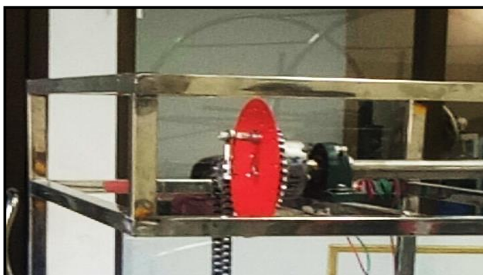
ภาพที่ 3-60 แสดงการติดตั้งงานเพลลาส่งกำลังเข้ากับชุดแกนยกเส้นไหม (ที่มา : วทัญญู บุตรศรี, 2561)
