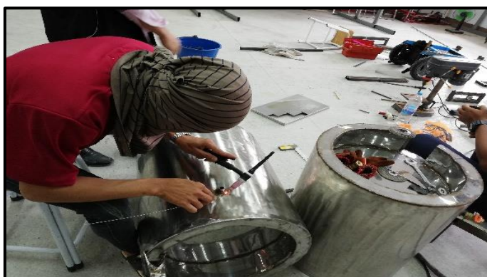
ภาพที่ 3-124 แสดงการเชื่อมประกอบเพื่อจัดทำหม้อย้อมสี (ที่มา : วทัญญู บุตรศรี, 2562)
