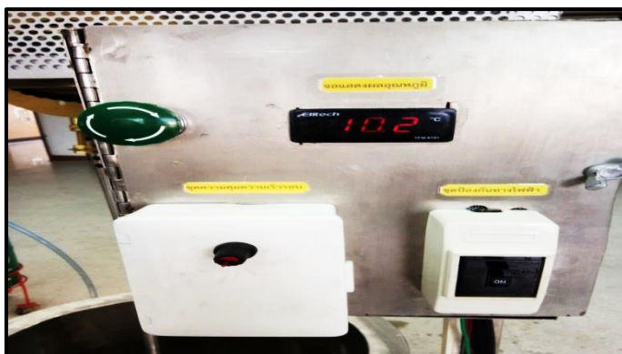
ภาพที่ 3-74 แสดงหน้าจอแสดงผลและตู้ควบคุมไฟฟ้าขณะเครื่องทำงาน (ที่มา : วัทัญญ บุตศรี, 2561)
