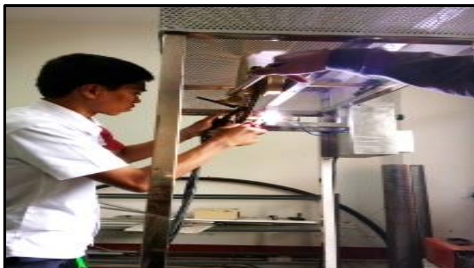
ภาพที่ 3-59 แสดงการเชื่อมประกอบระบบชุดโซ่ส่งกำลังเข้ากับแกนเพลลาของมอเตอร์ไฟฟ้า (ที่มา : วทัญญู บุตรศรี, 2561)
