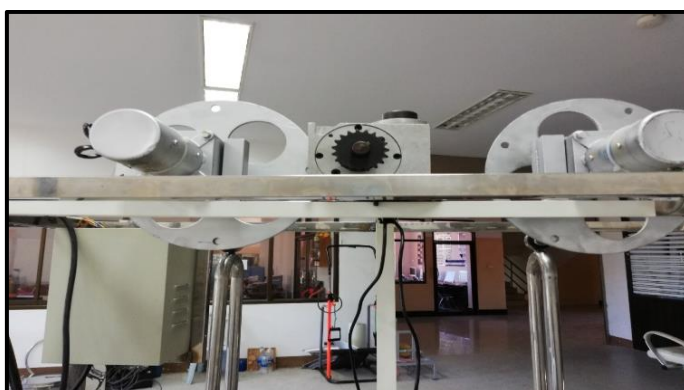
ภาพที่ 3-132 แสดงการทดสอบชุดเพลาส่งกำลังเข้ากับมอเตอร์เกียร์ขนาดแรงดันไฟฟ้า 24 โวลต์ (ที่มา : วทัญญู บุตรศรี, 2562)
