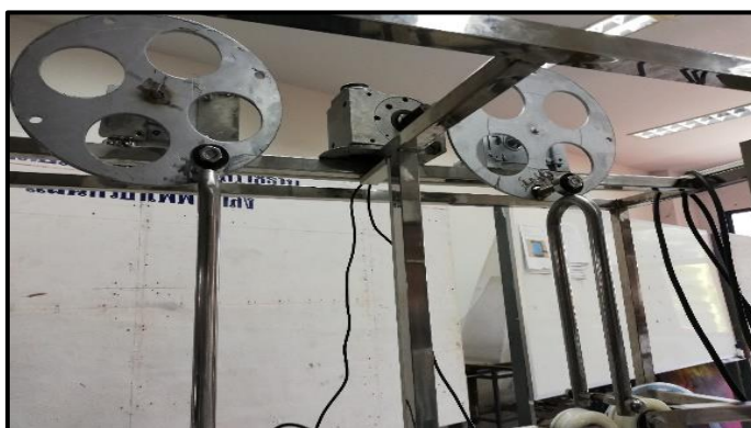
ภาพที่ 3-130 แสดงการติดตั้งชุดเพลาส่งกำลังเข้ากับมอเตอร์เกียร์ขนาดแรงดันไฟฟ้า 24 โวลต์ (ที่มา : วทัญญู บุตรศรี, 2562)
