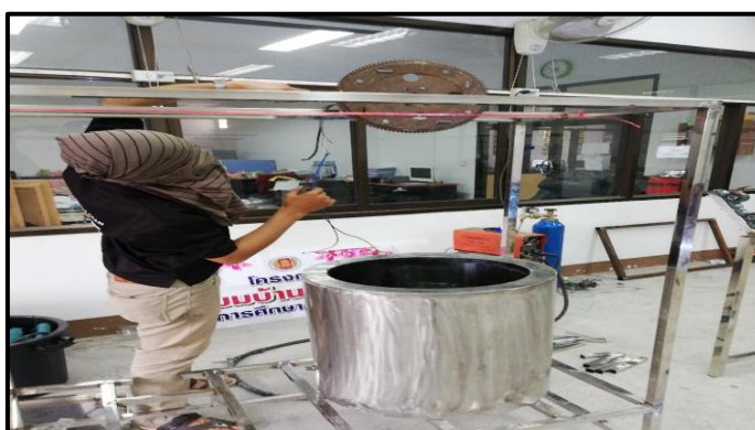
ภาพที่ 3-57 แสดงการประกอบหม้อย้อมสีเข้ากับโครงสร้างเครื่อง (ที่มา : วทีญญ บุตรศรี, 2561)
