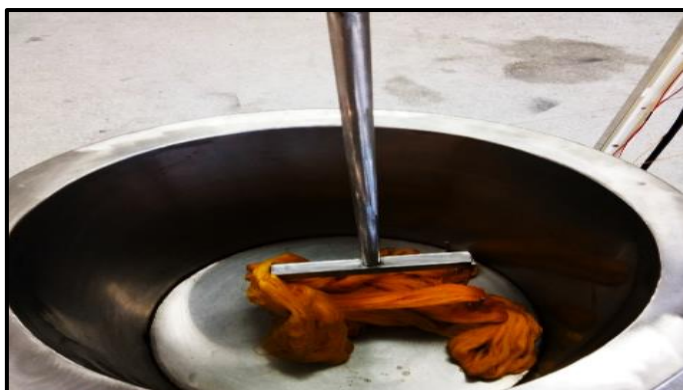
ภาพที่ 3-98 แสดงการทดสอบระบบของชุดแกนยกเส้นไหม (ที่มา : วทิญญ บุตรศรี, 2561)
