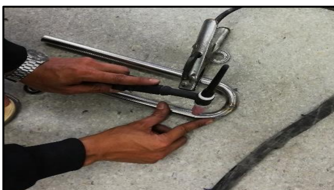
ภาพที่ 3-133 แสดงการเชื่อมประกอบเพื่อจัดทำชุดแกนยกเส้นไหม (ที่มา : วทัญญู บุตรศรี, 2562)
