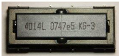
รูปที่ 7.4 แสดงหม้อแปลงแรงดันสูงเบอร์ 4014L
