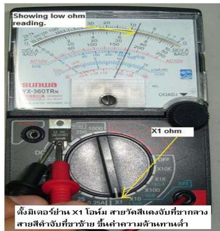
รูปที่ 3.20 แสดงการวัดไดโอดแบบชอคกีแบบคอมมอนแคโอด ขั้นตอนที่ 1
