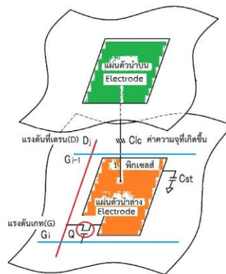
รูปที่ 9.18 แสดงการทำงานของ TFT ที่มีผลึกคริสตัลเหลวอยู่ระหว่างแผ่นกระจก
