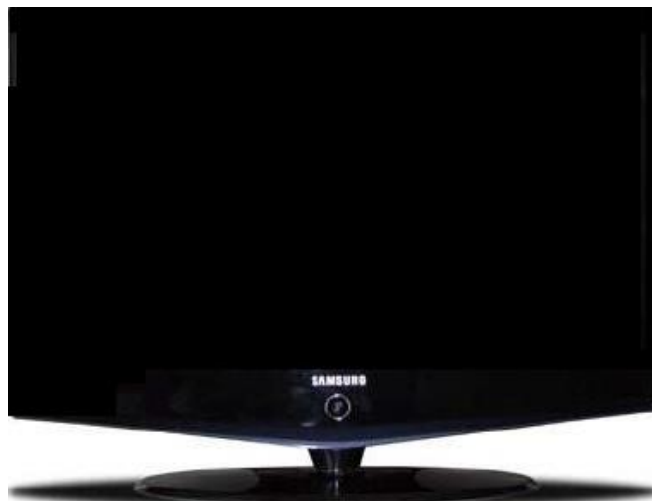
รูปที่ 11.7 แสดงอาการเครื่องรับสีเสียงปกติ แต่ไม่มีแสง บางครั้งเครื่องตัดภายใน 3 วินาที
