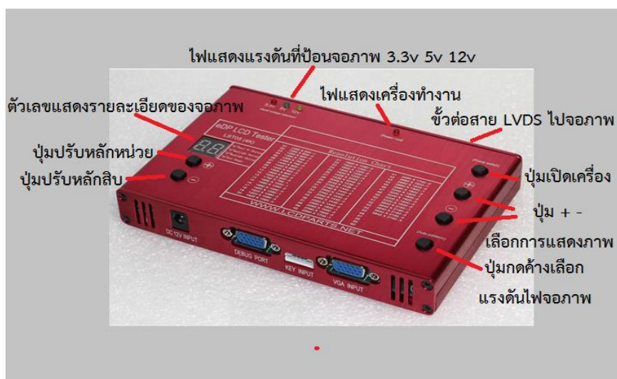
รูปที่ 11.16 แสดงรูปร่างของปุ่มการใช้งานของเครื่องตรวจจอภาพรุ่น T100
