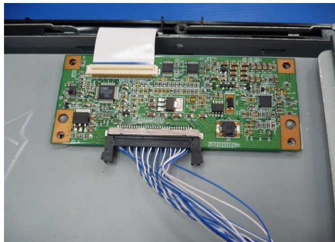
รูปที่ 8.25 แสดงการต่อเชื่อมสัญญาณ LVDS จากเมนบอร์ดไปยัง T-CONบอร์ด
