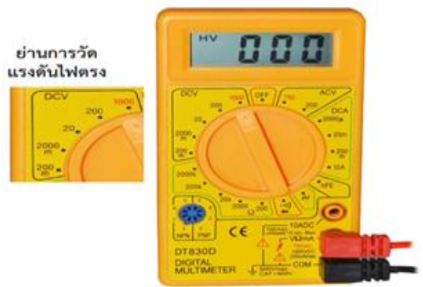
รูปที่ 2.17 แสดงการปรับหมุนย่านการวัดไปที่ตำแหน่ง DCV
