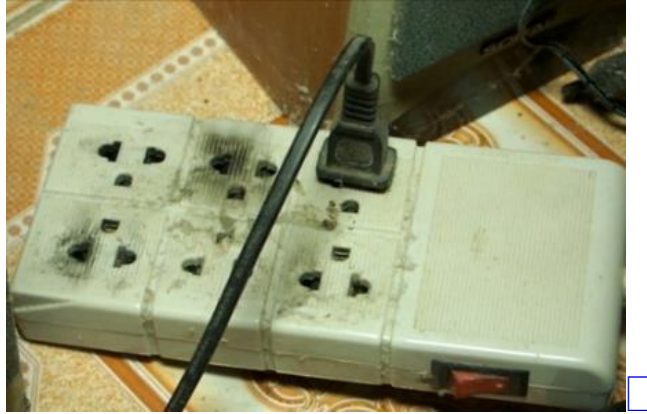
รูปที่ 1.33 แสดงเต้ารับอันเดียวกับหลายอุปกรณ์ ทำให้เกิดความร้อนสะสม เกิดการชำรุด
