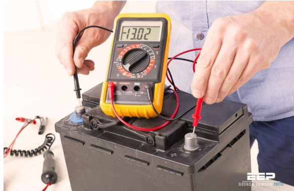
รูปที่ 2.18 แสดงการวัดแรงดันไฟฟ้ากระแสตรงของแบตเตอรี่
