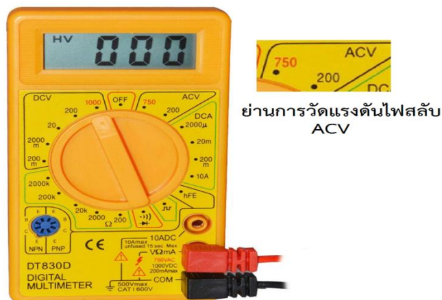
รูปที่ 2.19 แสดงการปรับหมุนย่านการวัดไปที่ตำแหน่ง ACV
