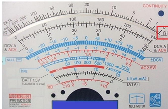
รูปที่ 2.11 แสดงสเกลหน้าปัดการวัดค่าความต้านทาน
