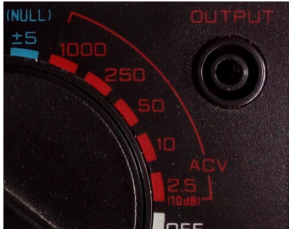
รูปที่ 2.7 แสดงตำแหน่งการเสียบสายวัดที่ OUTPUT
