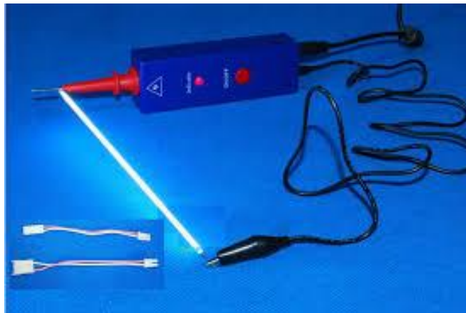
รูปที่ 11.8 แสดงการตรวจหลอด CCFL ด้วยเครื่องตรวจสอบสภาพหลอด
