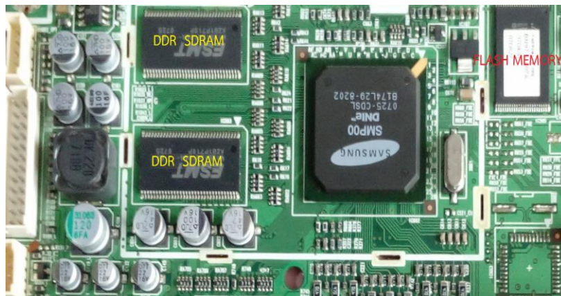
รูปที่ 8.16 แสดงแผงวงจรไอซีประมวลผลภาพและไอซีควบคุม สัญญาณภาพ
