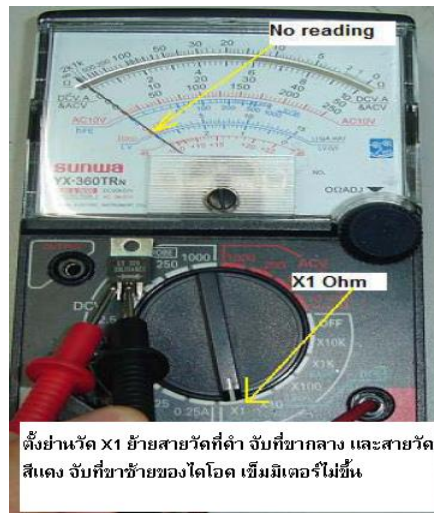
รูปที่ 3.22 แสดงการวัดไดโอดแบบซอกกีแบบคอมมอนแคโอด ขั้นตอนที่ 3
