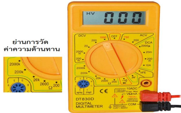
รูปที่ 2.15 แสดงตำแหน่งปรับหมุนย่านการวัดไปที่ตำแหน่ง โอห์ม
