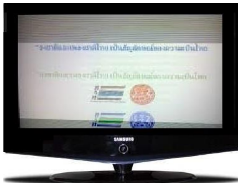
รูปที่ 11.11 แสดงอาการเสียมีเส้นรบกวนด้านบนจอภาพ
