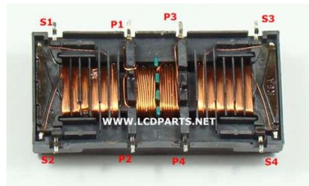
รูปที่ 7.4 แสดงหม้อแปลงแรงดันสูงเบอร์ 4014L
