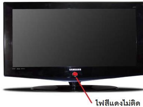
รูปที่ 11.1 แสดงอาการเครื่องรับที่ไม่มีไฟสีแดงขึ้นหน้าเครื่องรับ
