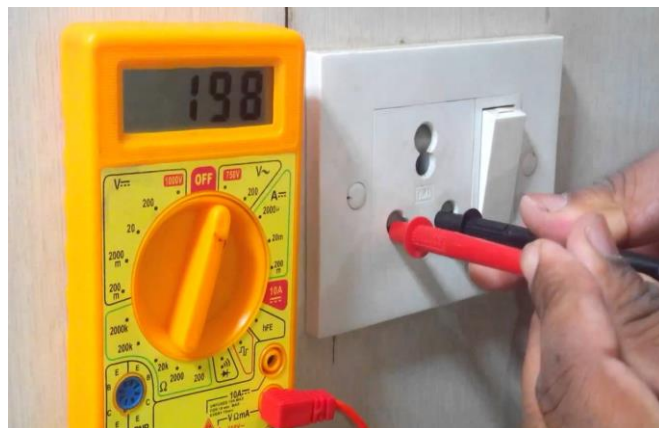
รูปที่ 2.19 แสดงการปรับหมุนย่านการวัดไปที่ตำแหน่ง ACV
