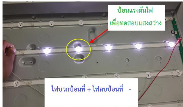
รูปที่ 11.9 แสดงการตรวจหลอด LED ด้วยการป้อนแรงดันไฟตรง
