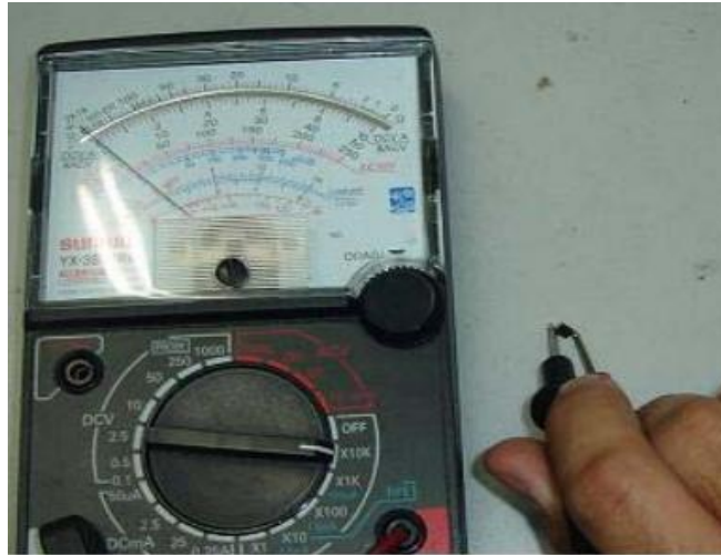
รูปที่ 3.16 แสดงการวัดแบบ SMD ด้วยมัลติมิเตอร์
