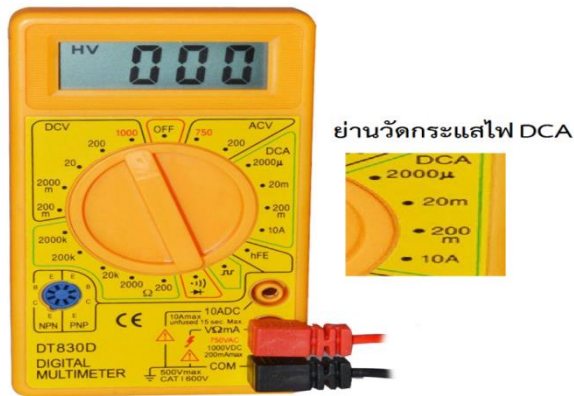
รูปที่ 2.21 แสดงย่านการวัดตำแหน่ง DCA
