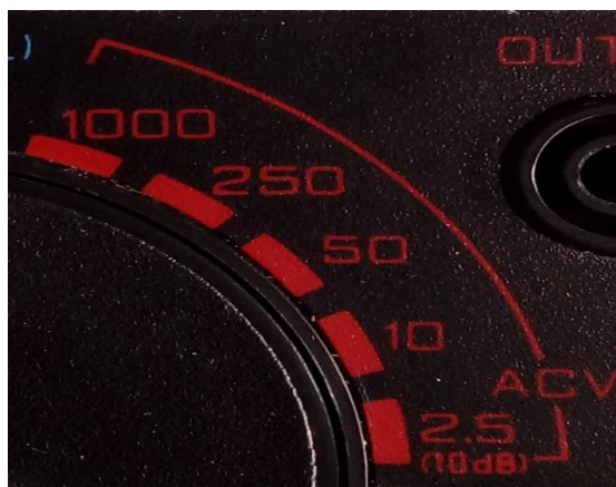
รูปที่ 2.6 แสดงย่านการวัดแรงดันไฟฟ้ากระแสสลับ
