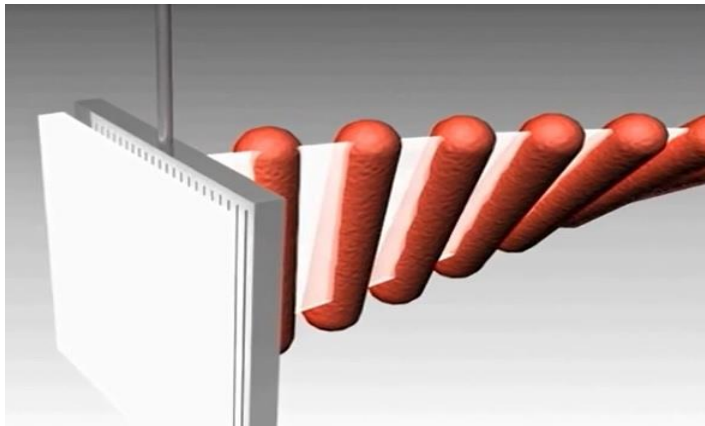
รูปที่ 4.7 แสดงโมเลกุลของผลึกคริสตัลเหลวเมื่อบิดตัวครบ 90 องศา ทำให้แสงผ่านแผ่นโพลาไรส์ได้
