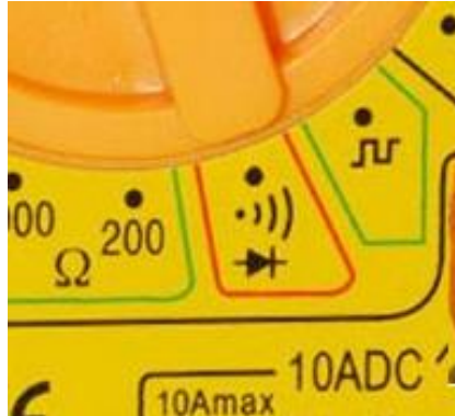
รูปที่ 2.24 แสดงการปรับย่านการวัดต่อเนื่อง
