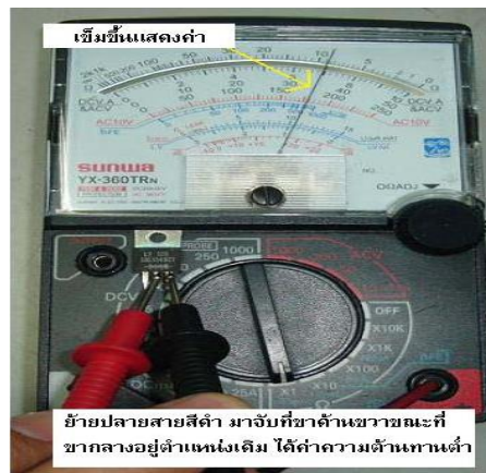
รูปที่ 8.21 แสดงการวัดไดโอดแบบชอคกีแบบคอมมอนแคโอด ขั้นตอนที่ 2
