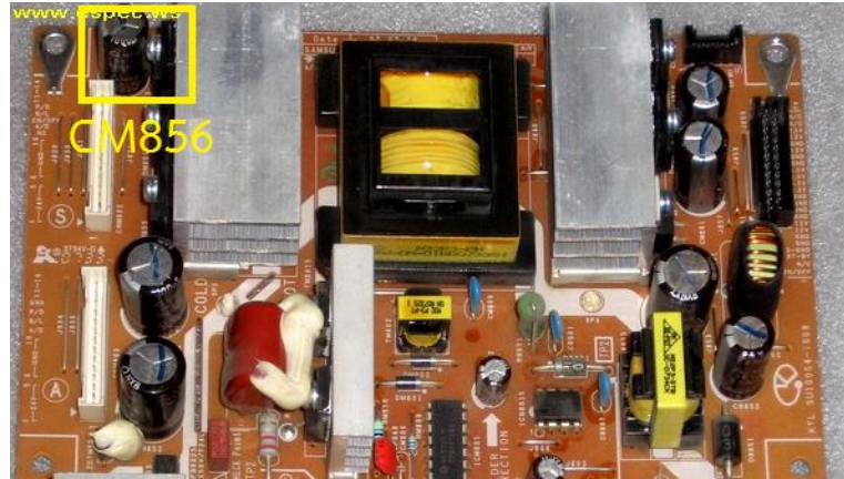
รูปที่ 6.25 แสดงตำแหน่งของคอนเด็นเซอร์ CM856
