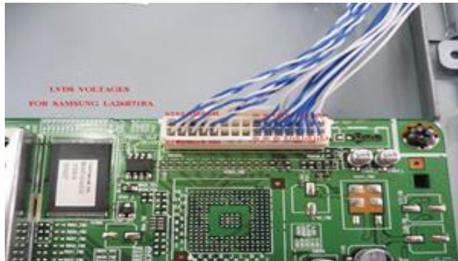
รูปที่ 9.23 แสดงตำแหน่งและแรงดัน LVDS
