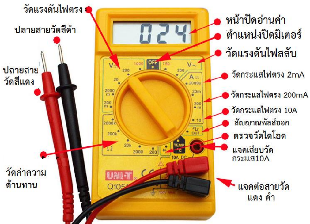
รูปที่ 2.13 แสดงมัลติมิเตอร์แบบตัวเลข
