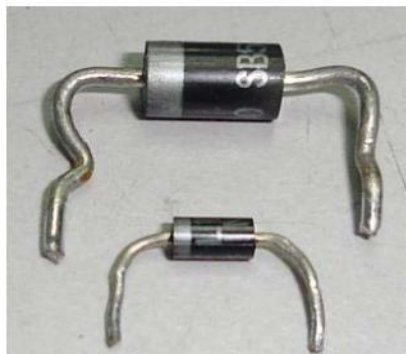
รูปที่ 3.18 แสดงรูปร่างและตำแหน่งของไดโอดแบบชอตคกีตัวถังแบบปกติ
