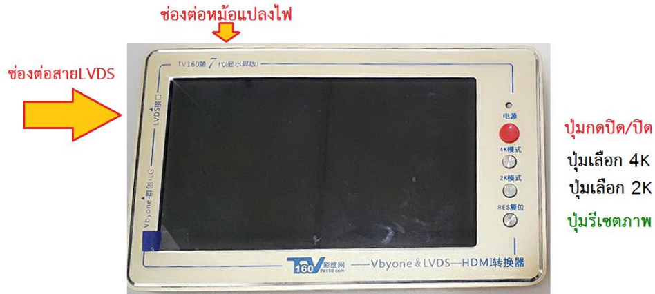
รูปที่ 11.19 แสดงตำแหน่งใช้งานของเครื่องตรวจเมนบอร์ดรุ่น TV160
