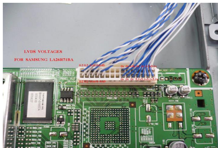
รูปที่ 8.26 แสดงค่าแรงดันLVDS
