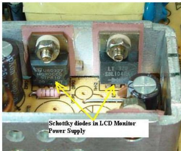
รูปที่ 3.17 แสดงรูปร่างและตำแหน่งของไดโอดแบบชอตคกีตัวถังแบบ TO-220
