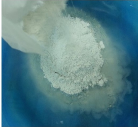
ภาพที่ 7.28 ผสมปูนปลาสเตอร์กับน้ำเป็นพิมพ์ครอบแม่พิมพ์ยางซิลิโคน ที่มา : สุรศักดิ์ เทพทอง, 2557
