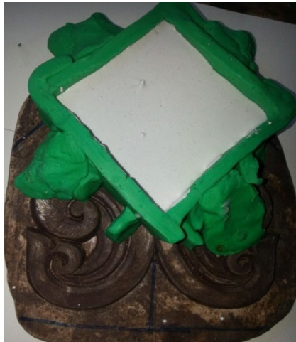
ภาพที่ 4.18 เทปูนปลาสเตอร์ทั่วแบบแม่พิมพ์ชิ้นที่ 1 ที่มา : สุรศักดิ์ เทพทอง, 2557
