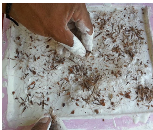
ภาพที่ 4.12 เกลี่ยปูนปลาสเตอร์และปูเส้นใยมะพร้าว ที่มา : สุรศักดิ์ เทพทอง, 2557
