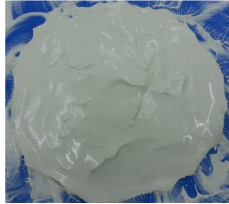
ภาพที่ 7.28 ผสมปูนปลาสเตอร์กับน้ำเป็นพิมพ์ครอบแม่พิมพ์ยางซิลิโคน ที่มา : สุรศักดิ์ เทพทอง, 2557
