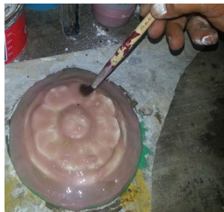
ภาพที่ 4.36 แปรงจุ่มเรซินลงในบริเวณที่ปูใยแก้ว ที่มา : สุรศักดิ์ เทพทอง, 2557
