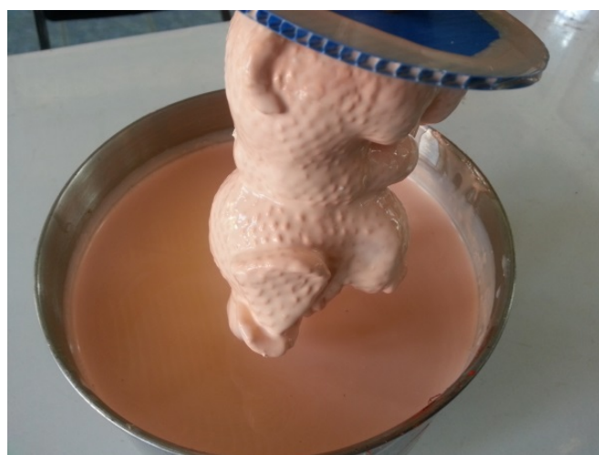
ภาพที่ 7.4 จุ่มรูปต้นแบบปูนปลาสเตอร์ลงในน้ำยาคอมปาวด์ ที่มา : สุรศักดิ์ เทพทอง, 2557
