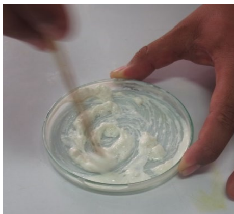
ภาพที่ 3.4 คนจนยางจับตัวกันเป็นก้อน ทดลองดีง ที่มา : สุรศักดิ์ เทพทอง, 2557
