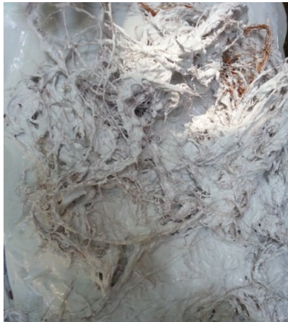
ภาพที่ 4.22 ปูนปลาสเตอร์ผสมเส้นใยมะพร้าวเสริมแรงแม่พิมพ์ครอบ ที่มา : สุรศักดิ์ เทพทอง, 2557
