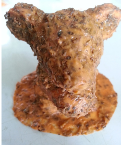
ภาพที่ 7.8 แม่พิมพ์ยางที่มีส่วนชั้นนอกแข็ง ที่มา : สุรศักดิ์ เทพทอง, 2557
