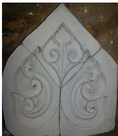
ภาพที่ 4.23 ถอดแม่พิมพ์ครอบและแม่พิมพ์ขึ้นออกจากกัน ที่มา : สุรศักดิ์ เทพทอง, 2557
