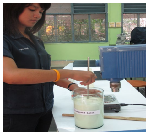
ภาพที่ 3.1.1 แสดงการเตรียมน้ำยางผสมสารเคมี
