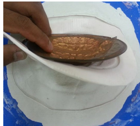
ภาพที่ 7.29 จัดพิมพ์ครอบออกจากแม่พิมพ์ยางซิลิโคน ที่มา : สุรศักดิ์ เทพทอง, 2557
