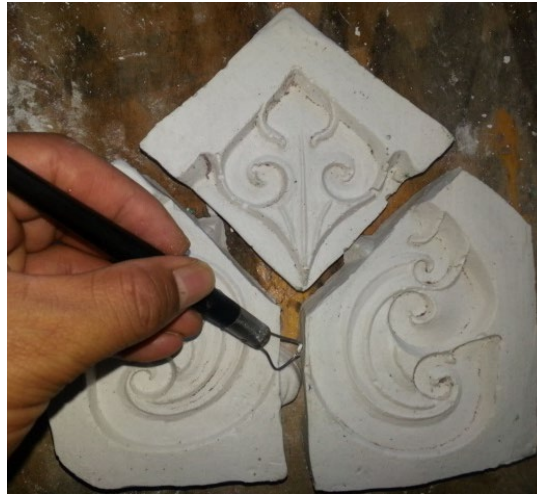
ภาพที่ 4.24 ตกแต่งผิวด้วยเครื่องมือแต่งปูนแต่ละชิ้น ที่มา : สุรศักดิ์ เทพทอง, 2557
