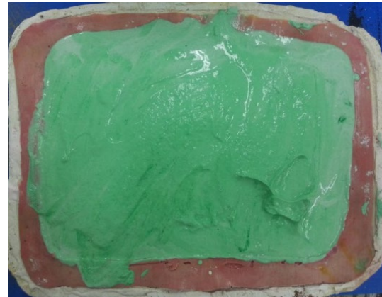
ภาพที่ 7.34 เทส่วนผสมลงในแม่พิมพ์ยาง ที่มา : สุรศักดิ์ เทพทอง, 2557
