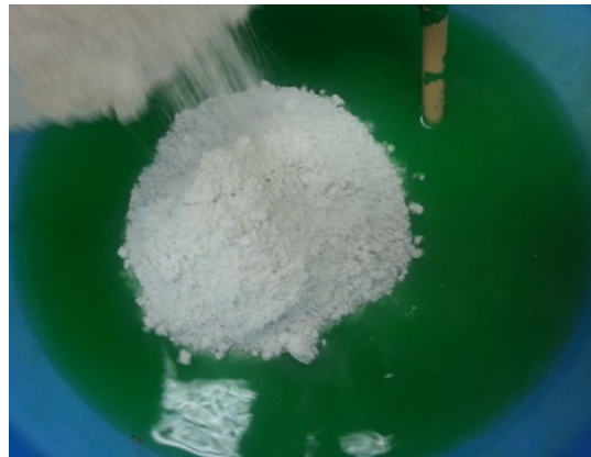
ภาพที่ 7.33 ผสมปูนปลาสเตอร์กับน้ำและสีฝุ่น
