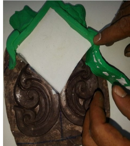
ภาพที่ 4.18 เทปูนปลาสเตอร์ทั่วแบบแม่พิมพ์ชิ้นที่ 1 ที่มา : สุรศักดิ์ เทพทอง, 2557
