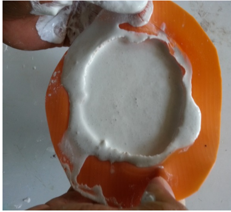
ภาพที่ 7.7 ชิ้นงานปูนปลาสเตอร์ที่หล่อจากแม่พิมพ์ยาง ที่มา : สุรศักดิ์ เทพทอง, 2557
