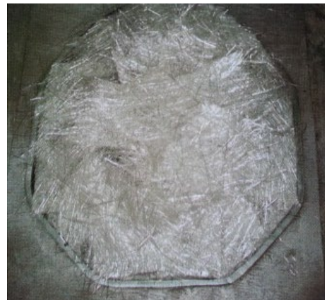
ภาพที่ 4.35 ทาเรซินและเสริมแรงด้วยใยแก้ว
