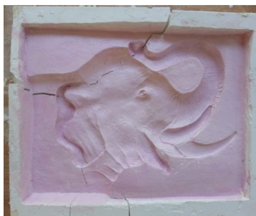
ภาพที่ 4.14 ชิ้นงานหล่อปูนปลาสเตอร์จากแม่พิมพ์ทุบ ที่มา : สุรศักดิ์ เทพทอง, 2557
