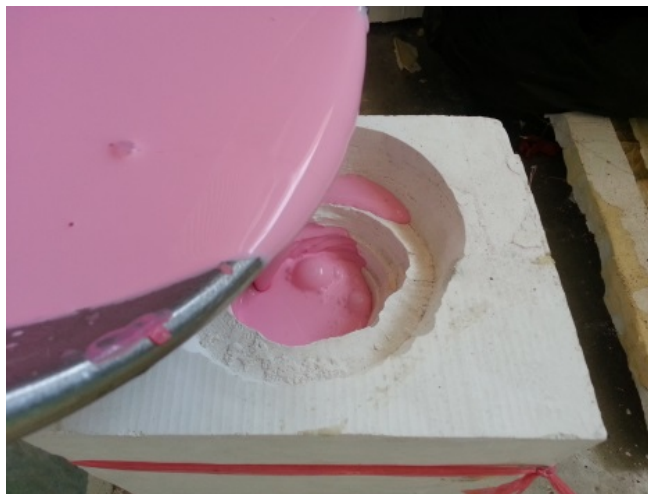
ภาพที่ 6.2.1 การขึ้นรูปผลิตภัณฑ์โดยวิธีหล่อแบบดัน
