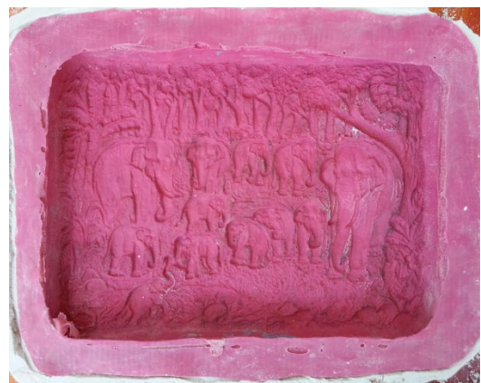
ภาพที่ 7.24 ปูนปลาสเตอร์ผสมเส้นใยมะพร้าวเสริมแรงแม่พิมพ์ครอบ ที่มา : สุรศักดิ์ เทพทอง, 2557
