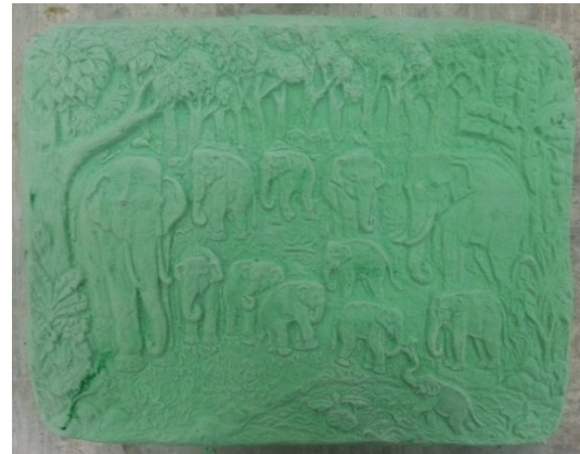
ภาพที่ 7.35 แกะชิ้นงานออกจากแม่พิมพ์ยางได้ชิ้นงานสำเร็จ ที่มา : สุรศักดิ์ เทพทอง, 2557
