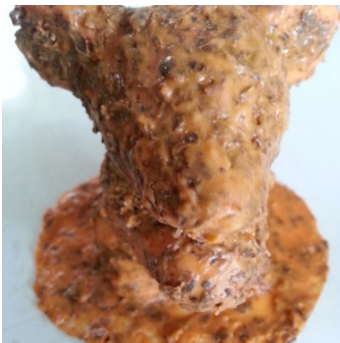
ภาพที่ 7.13 แม่พิมพ์ยางแบบให้มีส่วนชั้นนอกแข็ง ที่มา : สุรศักดิ์ เทพทอง, 2557
