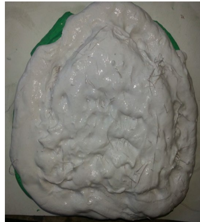
ภาพที่ 4.22 ปูนปลาสเตอร์ผสมเส้นใยมะพร้าวเสริมแรงแม่พิมพ์ครอบ ที่มา : สุรศักดิ์ เทพทอง, 2557
