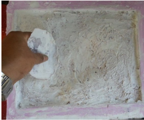
ภาพที่ 4.13 ค้อนไม้ตอกแม่พิมพ์ทุบออกจากผิวของชิ้นงาน ที่มา : สุรศักดิ์ เทพทอง, 2557
