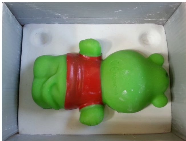
ภาพที่ 5.6 เทปูนปลาสเตอร์ลงในกล่องและกดรูปต้นแบบลงครึ่งหนึ่งของความหนา ที่มา : สุรศักดิ์ เทพทอง, 2557
