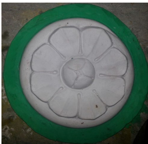
ภาพที่ 4.33 รูปต้นแบบปูนปลาสเตอร์กันกรอบด้วยดินน้ำมัน ที่มา : สุรศักดิ์ เทพทอง, 2557
