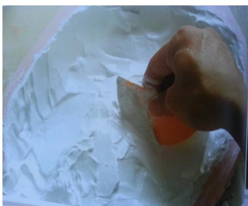
ภาพที่ 4.12 เกลี่ยปูนปลาสเตอร์และปูเส้นใยมะพร้าว ที่มา : สุรศักดิ์ เทพทอง, 2557
