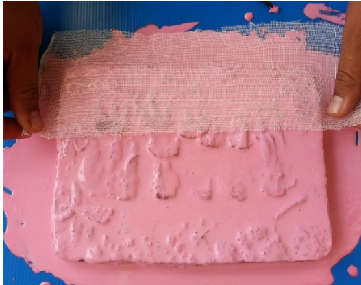
ภาพที่ 7.23 แสดงการปูผ้ากอซเพื่อเสริมแรงและแม่พิมพ์ยางที่ทำเสร็จ ที่มา : สุรศักดิ์ เทพทอง, 2557
