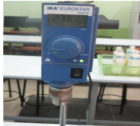
ภาพที่ 6.8 การเตรียมและกวนน้ำยางคอมปาวด์ด้วยการกวนอย่างต่อเนื่อง ที่มา : สุรศักดิ์ เทพทอง, 2557
