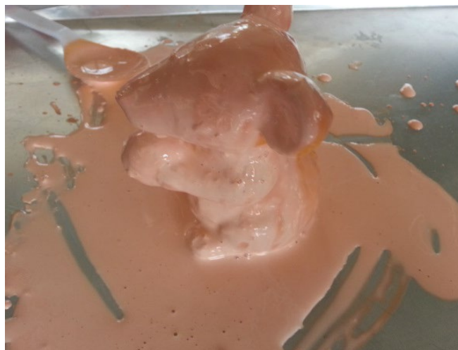
ภาพที่ 7.10 เทน้ำยางคอมปาวด์ลงบนรูปต้นแบบปูนปลาสเตอร์ ที่มา : สุรศักดิ์ เทพทอง, 2557
