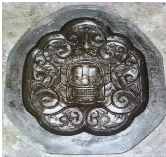
ภาพที่ 4.32 แม่พิมพ์ไฟเบอร์กลาสแบบขึ้นเดียว ที่มา : สุวิทย์ วิทยาจักร (2550: 85)
