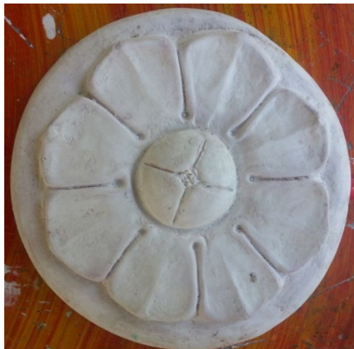
ภาพที่ 4.40 ชิ้นงานหล่อจากแม่พิมพ์ไฟเบอร์กลาส ที่มา : สุรศักดิ์ เทพทอง, 2557
