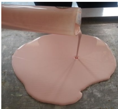
ภาพที่ 3.5 เทน้ำยางลงในถาดแบนและอบแห้งด้วยตู้อบลมร้อน
