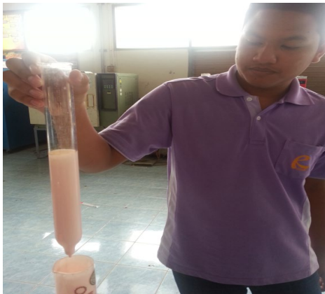
ภาพที่ 3.9 จุ่มหลอดแก้วในน้ำยางผสมสารเคมีและอบแห้ง
