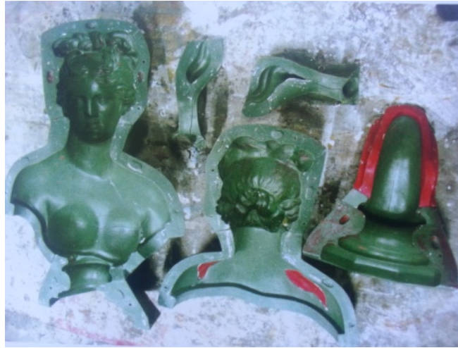
ภาพที่ 4.4 แม่พิมพ์ถาวรหรือแม่พิมพ์ขึ้น
