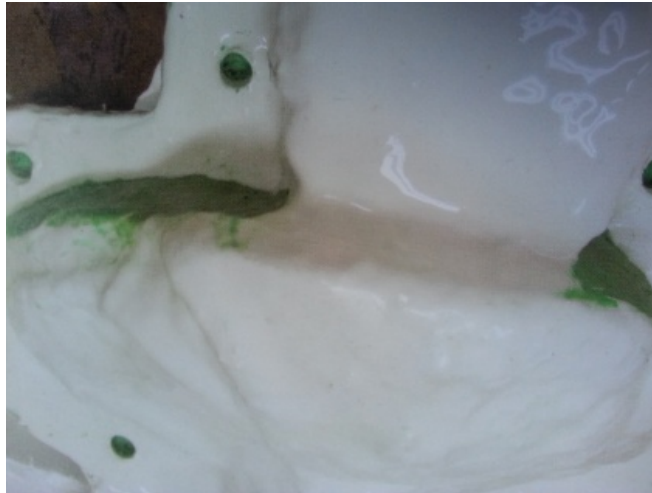
ภาพที่ 5.26 อุดส่วนเว้าของแม่พิมพ์ด้วยดินน้ำมัน ที่มา : สุรศักดิ์ เทพทอง, 2557
