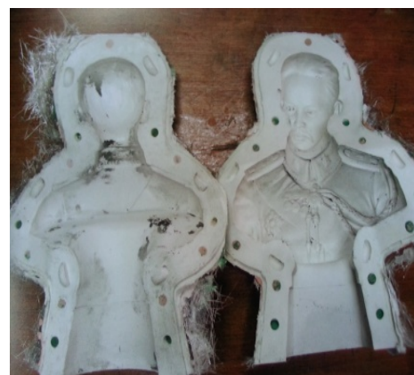
ภาพที่ 5.33 ถอดแม่พิมพ์ยางซิลิโคนและแม่พิมพ์ครอบไฟเบอร์กลาสออกจากรูปต้นแบบ
