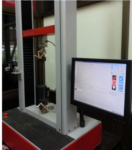
ภาพที่ 3.11 ทดสอบการดึงด้วยเครื่องดึงยาง ที่มา : สุรศักดิ์ เทพทอง, 2557
