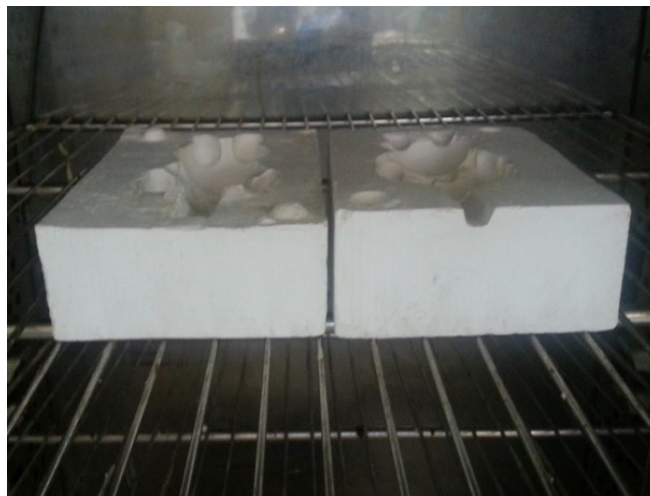
ภาพที่ 5.10 อบแม่พิมพ์ให้แห้งด้วยตู้อบลมร้อน ที่มา : สุรศักดิ์ เทพทอง, 2557
