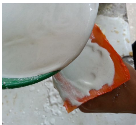
ภาพที่ 7.14 หล่อปูนปลาสเตอร์จากแม่พิมพ์ยางที่มีส่วนชั้นนอกแข็ง ที่มา : สุรศักดิ์ เทพทอง, 2557
