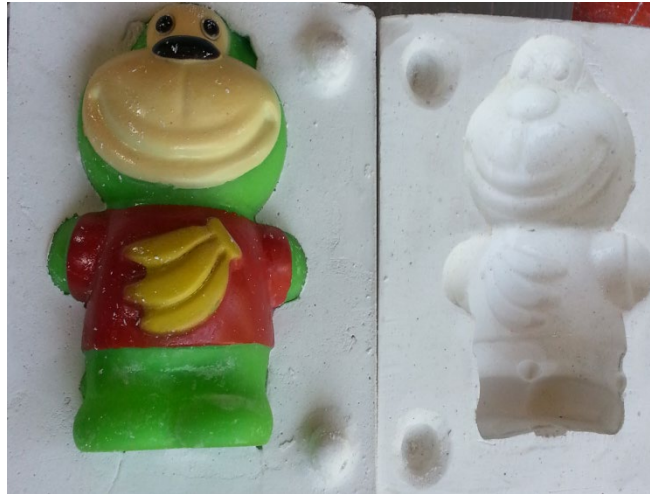
ภาพที่ 5.9 แกะแม่พิมพ์แยกจากกันตักแต่งให้เรียบร้อย ที่มา : สุรศักดิ์ เทพทอง, 2557
