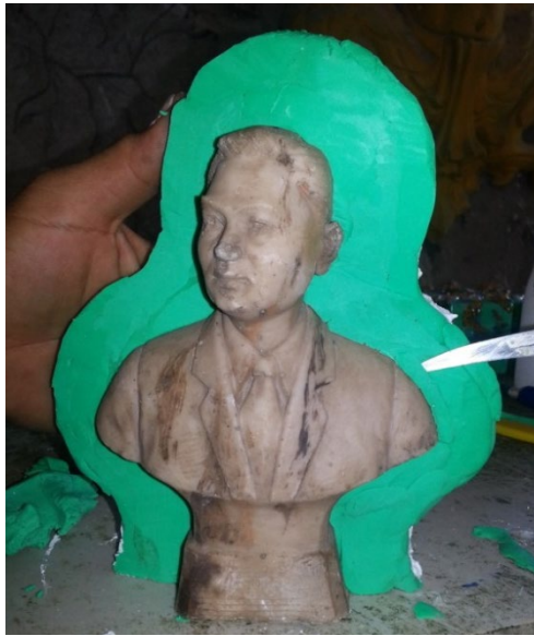
ภาพที่ 5.14 แบ่งซีกพิมพ์โดยการกั้นด้วยดินน้ำมัน ที่มา : สุรศักดิ์ เทพทอง, 2557
