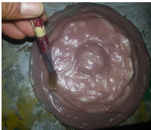
ภาพที่ 4.36 แปรงจุ่มเรซินลงในบริเวณที่ปูใยแก้ว ที่มา : สุรศักดิ์ เทพทอง, 2557
