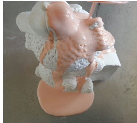
ภาพที่ 7.16 รูปต้นแบบปูนปลาสเตอร์ยึดฐานด้านล่างและเทราดน้ำยาคอมปาวด์ ที่มา : สุรศักดิ์ เทพทอง, 2557
