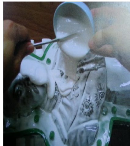
ภาพที่ 5.21 เกลี่ยยางซิลิโคนให้มีความหนาเท่า ๆ กัน และเทชั้นที่ 2 ที่มา : สุรศักดิ์ เทพทอง, 2557
