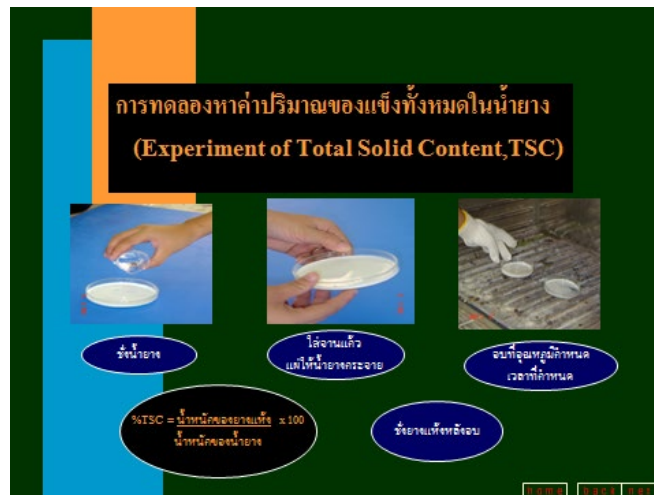
ภาพที่ 1.1.1 การทดสอบหาค่าปริมาณของแข็งทั้งหมดในน้ำยาง
