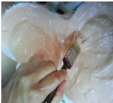
ภาพที่ 5.27 ทาเรซินและปูด้วยใยแก้ว ที่มา : สุรศักดิ์ เทพทอง, 2557
