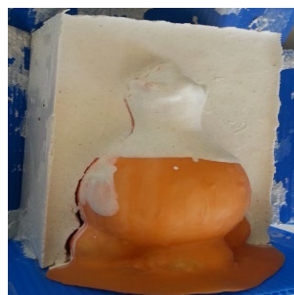
ภาพที่ 7.18 ปูนปลาสเตอร์ครอบแม่พิมพ์ยางเสริมความแข็งแรง ที่มา : สุรศักดิ์ เทพทอง, 2557
