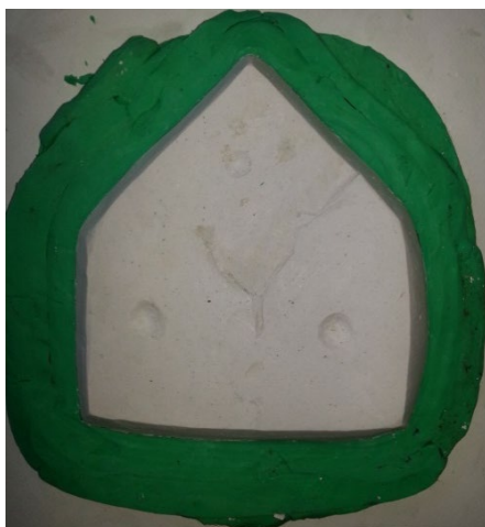
ภาพที่ 4.21 กั้นดินน้ำมันรอบ ๆ พร้อมทาวาสลีนทั่วบริเวณแม่พิมพ์ชั้น ที่มา : สุรศักดิ์ เทพทอง, 2557
