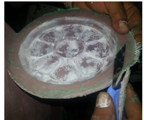
ภาพที่ 4.38 สกัดรูปต้นแบบและตัดขอบของแม่พิมพ์ออก ที่มา : สุรศักดิ์ เทพทอง, 2557
