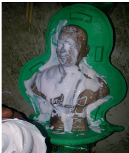
ภาพที่ 5.19 เทยางซิลิโคนลงบนรูปต้นแบบและปาดด้วยฟู่กัน
