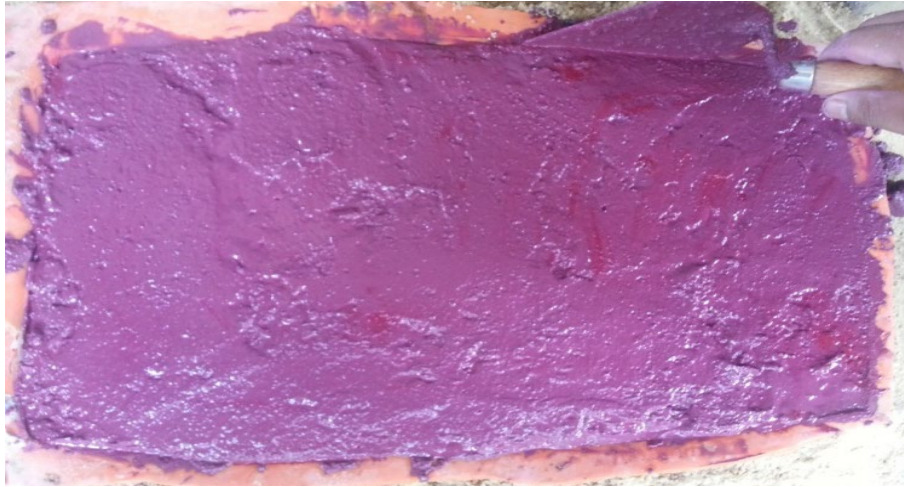
ภาพที่ 7.39 ใช้เกรียงเหล็กเกลี่ยส่วนผสมให้ทั่วและสม่ำเสมอ ที่มา : สุรศักดิ์ เทพทอง, 2557
