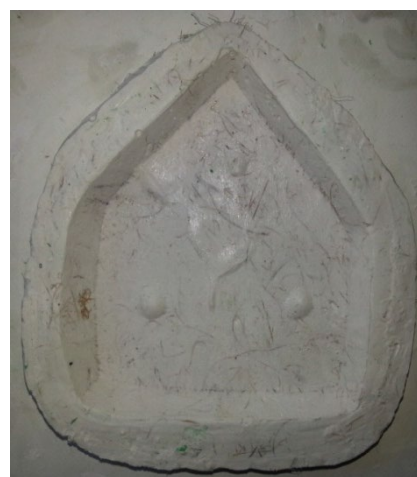
ภาพที่ 4.23 ถอดแม่พิมพ์ครอบและแม่พิมพ์ขึ้นออกจากกัน ที่มา : สุรศักดิ์ เทพทอง, 2557
