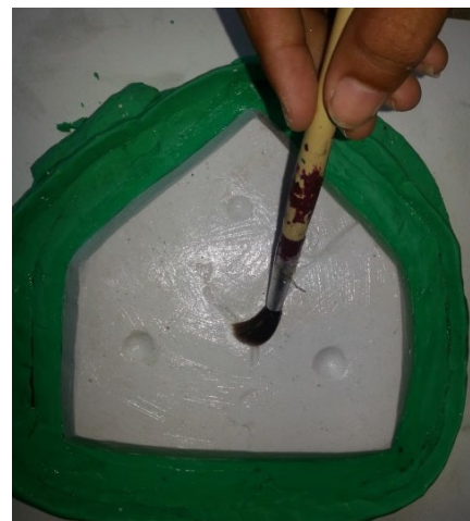
ภาพที่ 4.21 กั้นดินน้ำมันรอบ ๆ พร้อมทาวาสลีนทั่วบริเวณแม่พิมพ์ชั้น ที่มา : สุรศักดิ์ เทพทอง, 2557
