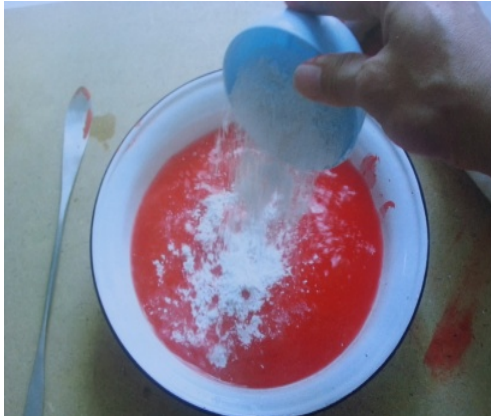
ภาพที่ 4.7 ผสมปูนปลาสเตอร์กับน้ำและสี ที่มา : สุรศักดิ์ เทพทอง, 2557
