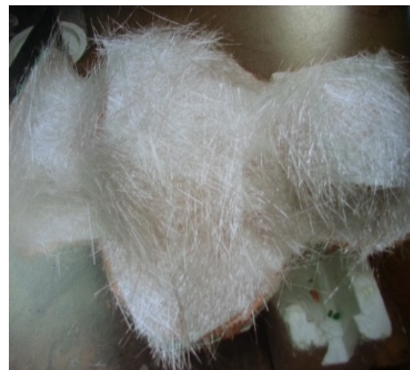
ภาพที่ 5.27 ทาเรซินและปูด้วยใยแก้ว ที่มา : สุรศักดิ์ เทพทอง, 2557
