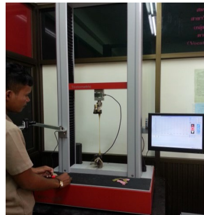
ภาพที่ 3.8 แสดงการทดสอบน้ำยางผสมสารเคมีโดยใช้ Tensile Tester ที่มา : สุรศักดิ์ เทพทอง, 2557
