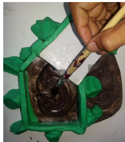
ภาพที่ 4.19 มีดปลายแหลมขูดเป็นร่องรูปสี่เหลี่ยมและทาวาสลีน ที่มา : สุรศักดิ์ เทพทอง, 2557
