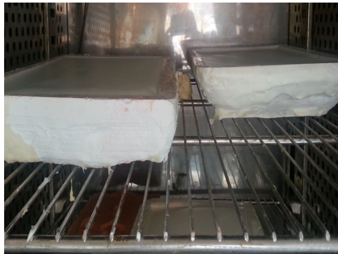
ภาพที่ 4.31 อบแห้งด้วยตู้อบลมร้อน ที่มา : สุรศักดิ์ เทพทอง, 2557
