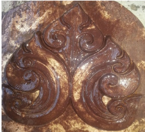
ภาพที่ 4.16 รูปต้นแบบปูนปลาสเตอร์ลากเส้นแบ่งขึ้นพิมพ์ ที่มา : สุรศักดิ์ เทพทอง, 2557
