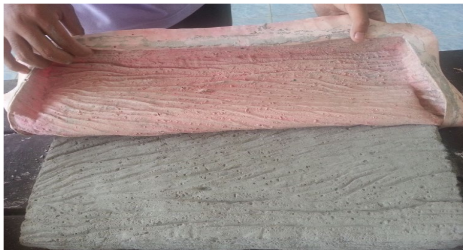
ภาพที่ 7.40 แกะชิ้นงานออกจากแม่พิมพ์ยาง ที่มา : สุรศักดิ์ เทพทอง, 2557
