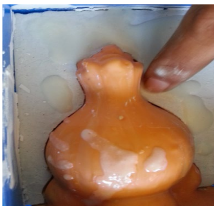
ภาพที่ 7.18 ปูนปลาสเตอร์ครอบแม่พิมพ์ยางเสริมความแข็งแรง ที่มา : สุรศักดิ์ เทพทอง, 2557
