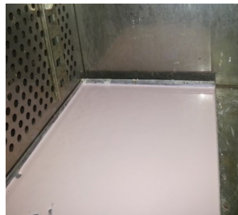
ภาพที่ 3.5 เทน้ำยางลงในถาดแบนและอบแห้งด้วยตู้อบลมร้อน
