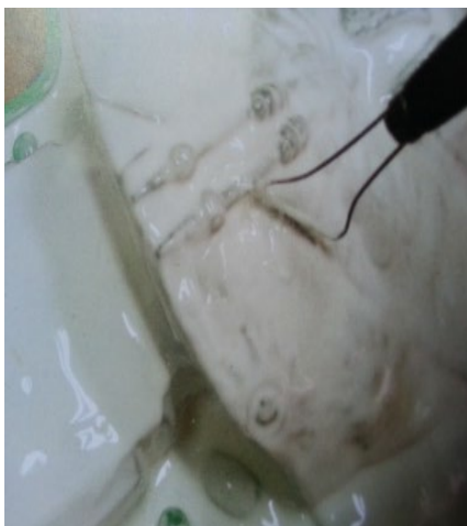
ภาพที่ 5.21 เกลี่ยยางซิลิโคนให้มีความหนาเท่า ๆ กัน และเทชั้นที่ 2 ที่มา : สุรศักดิ์ เทพทอง, 2557
