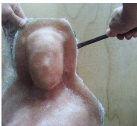
ภาพที่ 5.33 ถอดแม่พิมพ์ยางซิลิโคนและแม่พิมพ์ครอบไฟเบอร์กลาสออกจากรูปต้นแบบ
