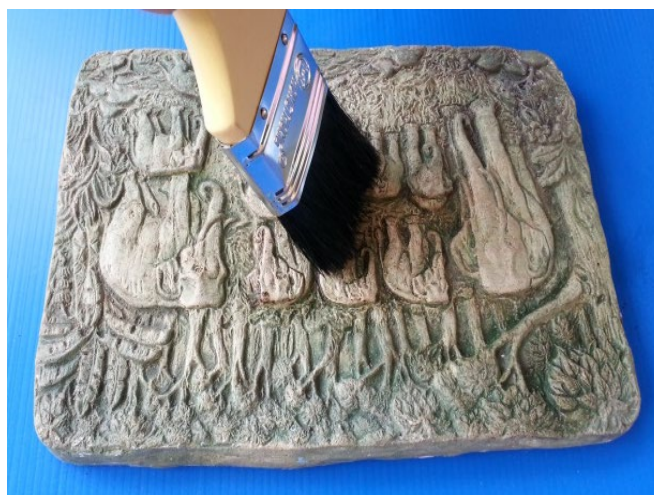
ภาพที่ 7.21 รูปต้นแบบปูนปลาสเตอร์ทาสารแคลเซียมไนเตรด ที่มา : สุรศักดิ์ เทพทอง, 2557
