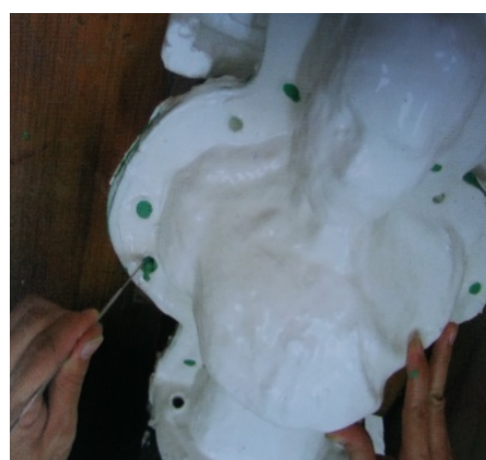
ภาพที่ 5.25 ตัดหัวหมดดินน้ำมันและควักหมดดินน้ำมันออก
