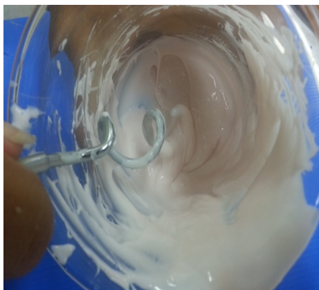
ภาพที่ 7.26 ผสมยางซิลิโคนกับตัวทำแข็งและเทยางให้ทั่วชิ้นงานรูปต้นแบบ ที่มา : สุรศักดิ์ เทพทอง, 2557
