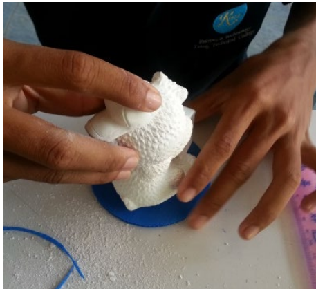
ภาพที่ 7.16 รูปต้นแบบปูนปลาสเตอร์ยึดฐานด้านล่างและเทราดน้ำยาคอมปาวด์ ที่มา : สุรศักดิ์ เทพทอง, 2557
