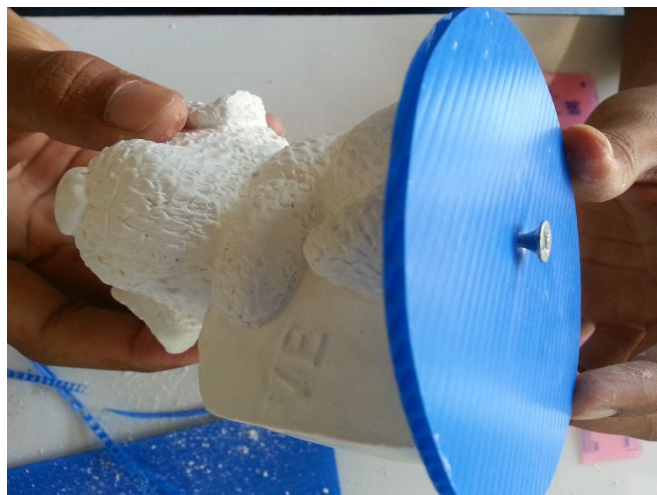
ภาพที่ 7.3 รูปต้นแบบปูนปลาสเตอร์ยึดส่วนฐานด้านล่างด้วยสกรู ที่มา : สุรศักดิ์ เทพทอง, 2557
