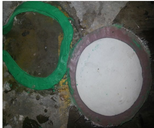
ภาพที่ 4.37 จัดแม่พิมพ์ออกจากไม้กระดานรอง ที่มา : สุรศักดิ์ เทพทอง, 2557
