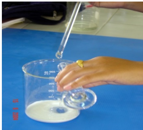
1. เติมกรดเพื่อให้ น้ำยางจับตัว
