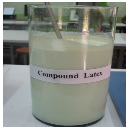
ภาพที่ 6.7 การเตรียมและบ่มน้ำยางคอมปาวด์ ที่มา : สุรศักดิ์ เทพทอง, 2557
