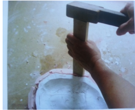
ภาพที่ 4.13 ค้อนไม้ตอกแม่พิมพ์ทุบออกจากผิวของชิ้นงาน ที่มา : สุรศักดิ์ เทพทอง, 2557
