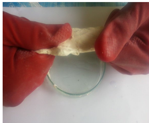
ภาพที่ 3.4 คนจนยางจับตัวกันเป็นก้อน ทดลองดีง ที่มา : สุรศักดิ์ เทพทอง, 2557
