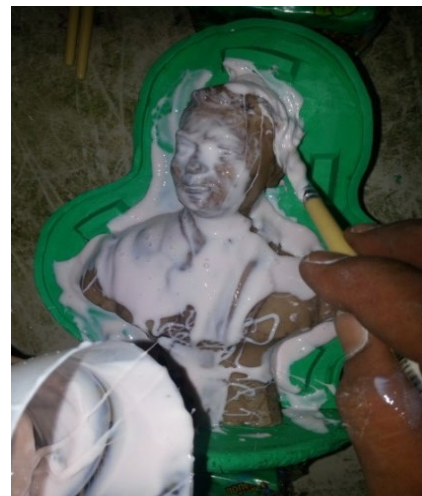
ภาพที่ 5.19 เทยางซิลิโคนลงบนรูปต้นแบบและปาดด้วยฟู่กัน
