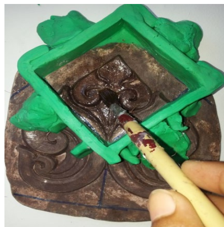
ภาพที่ 4.17 กั้นดินน้ำมันเพื่อทำแม่พิมพ์ขึ้นที่ 1 ที่มา : สุรศักดิ์ เทพทอง, 2557
