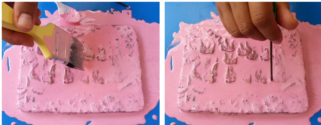
ภาพที่ 7.22 ทาน้ำยางคอมปาวด์ด้วยแปรงให้ทั่วรูปต้นแบบและและจิ้มไล่ฟองอากาศ ที่มา : สุรศักดิ์ เทพทอง, 2557
