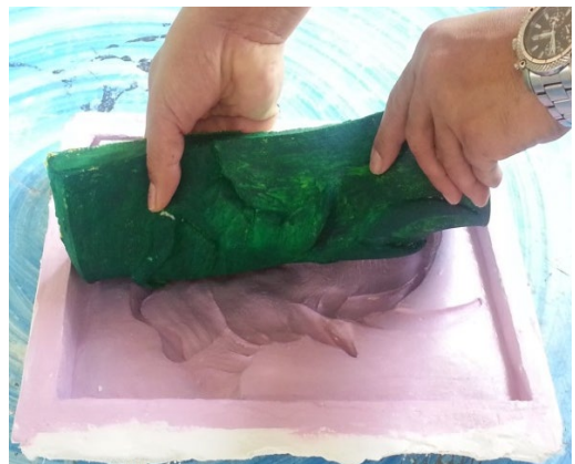
ภาพที่ 4.10 รื้อรูปต้นแบบออกจากแม่พิมพ์
