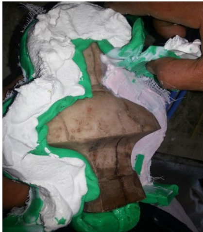
ภาพที่ 5.30 รื้อปูนปลาสเตอร์และดินน้ำมันกันขอบออก ที่มา : สุรศักดิ์ เทพทอง, 2557
