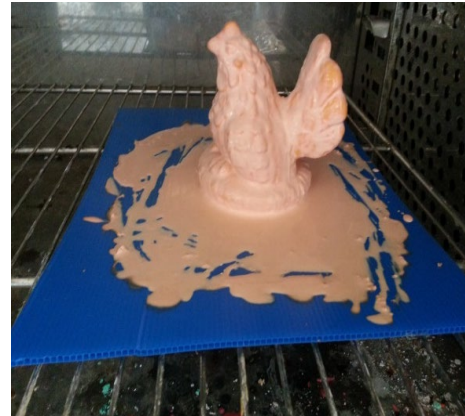
ภาพที่ 7.17 แปรงป้ายน้ำยางเพื่อความสม่ำเสมอและเข้าอบแห้งด้วยตู้อบลมร้อน ที่มา : สุรศักดิ์ เทพทอง, 2557
