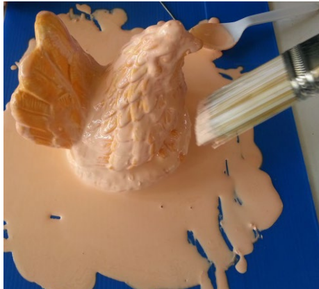
ภาพที่ 7.17 แปรงป้ายน้ำยางเพื่อความสม่ำเสมอและเข้าอบแห้งด้วยตู้อบลมร้อน ที่มา : สุรศักดิ์ เทพทอง, 2557
