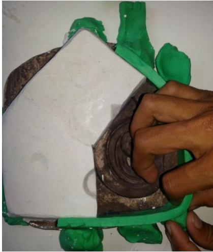
ภาพที่ 4.20 กั้นดินน้ำมันและทาปูนปลาสเตอร์ให้ทั่วพิมพ์ ที่มา : สุรศักดิ์ เทพทอง, 2557
