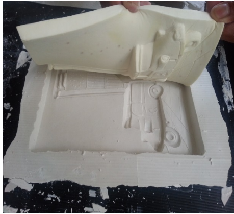
ภาพที่ 4.30 แกะแม่พิมพ์รูปต้นแบบออก ตกแต่งผิว ที่มา : สุรศักดิ์ เทพทอง, 2557
