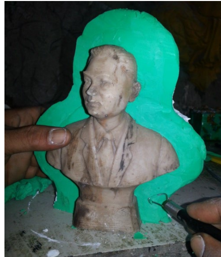
ภาพที่ 5.16 รีดดินน้ำมันให้แนบติดกับรูปต้นแบบ ที่มา : สุรศักดิ์ เทพทอง, 2557
