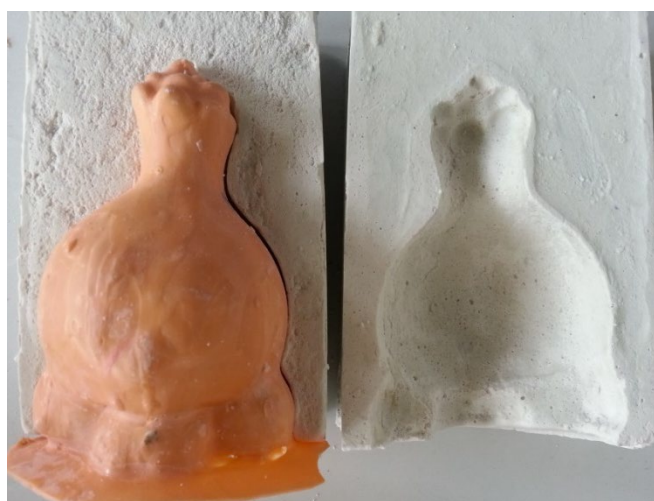
ภาพที่ 7.15 แม่พิมพ์ยางที่มีส่วนเสริมแรงด้วยแม่พิมพ์ครอบปูนปลาสเตอร์ ที่มา : สุรศักดิ์ เทพทอง, 2557
