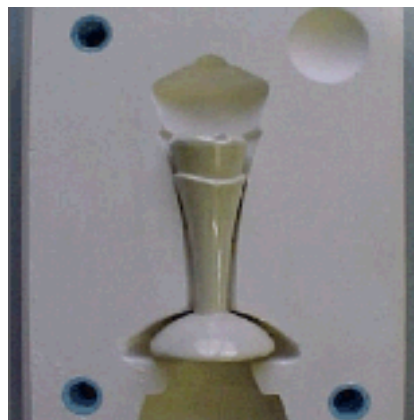
ภาพที่ 6.12 แม่พิมพ์หล่อชิ้นงานแบบกลวง ที่มา : สุรศักดิ์ เทพทอง, 2557
