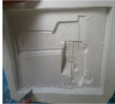
ภาพที่ 4.30 แกะแม่พิมพ์รูปต้นแบบออก ตกแต่งผิว ที่มา : สุรศักดิ์ เทพทอง, 2557
