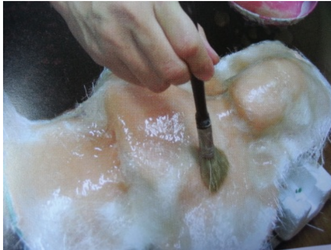
ภาพที่ 5.28 ทาเรซินลงบนใยแก้วให้ทั่วเป็นเนื้อเดียวกัน ที่มา : สุรศักดิ์ เทพทอง, 2557
