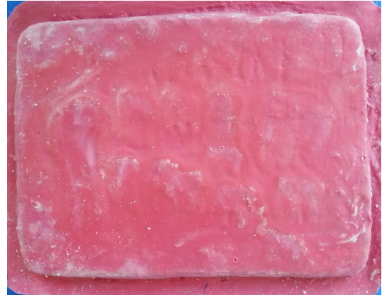
ภาพที่ 7.23 แสดงการปูผ้ากอซเพื่อเสริมแรงและแม่พิมพ์ยางที่ทำเสร็จ ที่มา : สุรศักดิ์ เทพทอง, 2557
