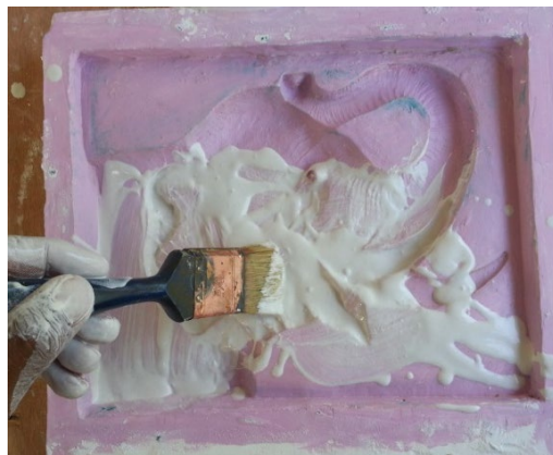
ภาพที่ 4.11 ทาปูนปลาสเตอร์ให้ทั่วแม่พิมพ์ ที่มา : สุรศักดิ์ เทพทอง, 2557
