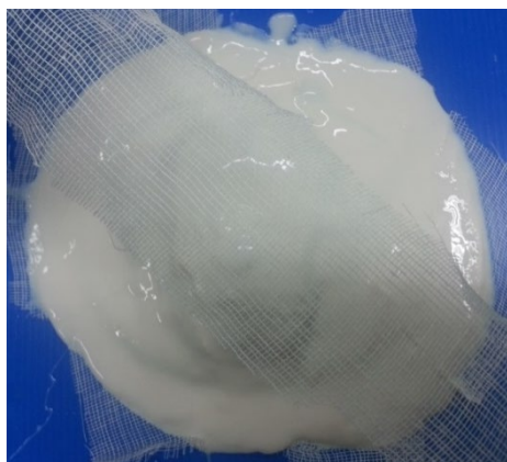
ภาพที่ 7.27 ตัดผ้ากอซให้เป็นชั้นสี่เหลี่ยมปูซ้อนกันวางบริเวณที่ลงยางเอาไว้ ที่มา : สุรศักดิ์ เทพทอง, 2557
