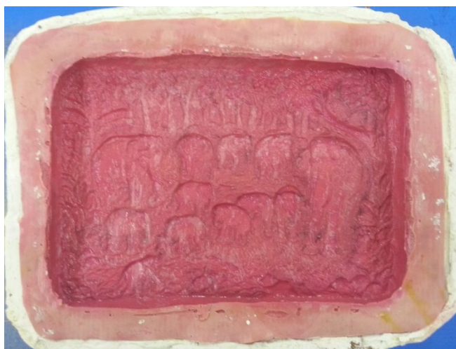
ภาพที่ 7.32 แม่พิมพ์ยางธรรมชาติพร้อมแม่พิมพ์ครอบประกอบ ที่มา : สุรศักดิ์ เทพทอง, 2557
