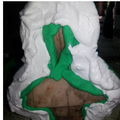
ภาพที่ 5.15 ทาปูนปลาสเตอร์ประกบดินน้ำมัน ที่มา : สุรศักดิ์ เทพทอง, 2557
