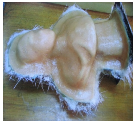
ภาพที่ 5.29 พิมพ์ครอบไฟเบอร์กลาสยังไม่ได้ตกแต่งขอบพิมพ์ ที่มา : สุรศักดิ์ เทพทอง, 2557
