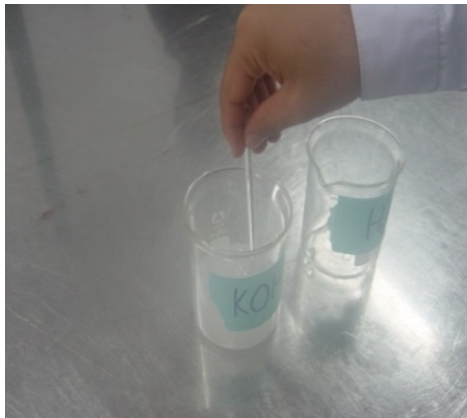
ภาพที่ 2.2.1 การเตรียม 10% โพแทสเซียมไฮดรอกไซด์
