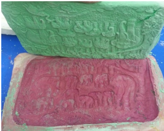
ภาพที่ 7.35 แกะชิ้นงานออกจากแม่พิมพ์ยางได้ชิ้นงานสำเร็จ ที่มา : สุรศักดิ์ เทพทอง, 2557
