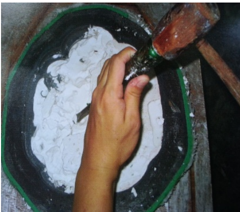
ภาพที่ 4.38 สกัดรูปต้นแบบและตัดขอบของแม่พิมพ์ออก ที่มา : สุรศักดิ์ เทพทอง, 2557
