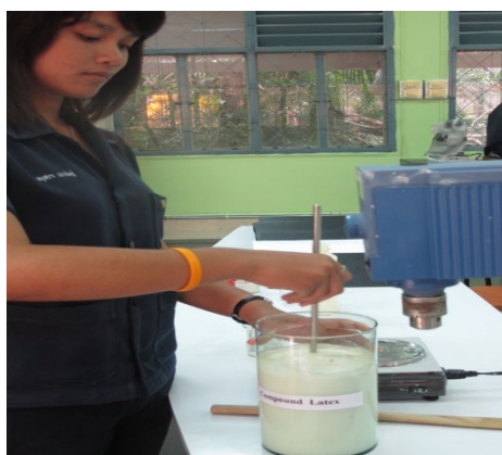
ภาพที่ 3.2 กวนสารเคมีด้วยมือและเครื่องกวนอย่างต่อเนื่อง
