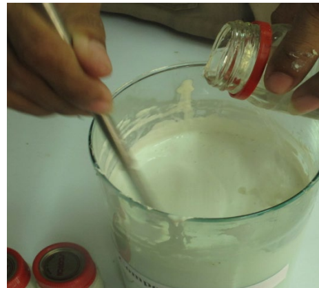
ภาพที่ 3.1 เตรียมสารเคมีและเติมลงในน้ำยางตามลำดับ
