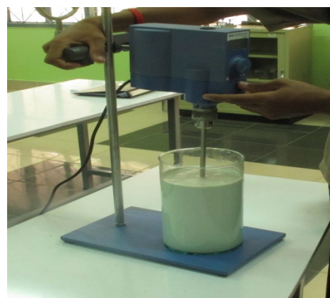
ภาพที่ 3.2 กวนสารเคมีด้วยมือและเครื่องกวนอย่างต่อเนื่อง
