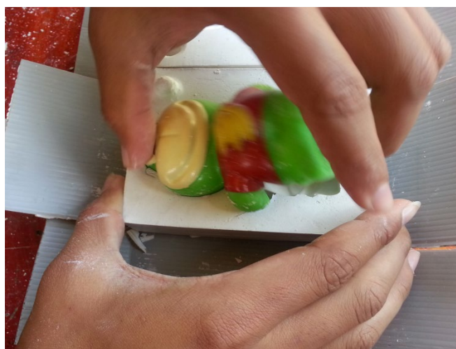
รูปที่ 5.7 แกะชิ้นงานรูปต้นแบบออกจากแม่พิมพ์ ที่มา : สุรศักดิ์ เทพทอง, 2557
