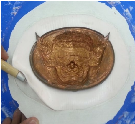
ภาพที่ 7.29 จัดพิมพ์ครอบออกจากแม่พิมพ์ยางซิลิโคน ที่มา : สุรศักดิ์ เทพทอง, 2557
