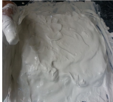
ภาพที่ 4.28 ผสมปูนปลาสเตอร์และพอกบนแม่พิมพ์รูปต้นแบบ ที่มา : สุรศักดิ์ เทพทอง, 2557
