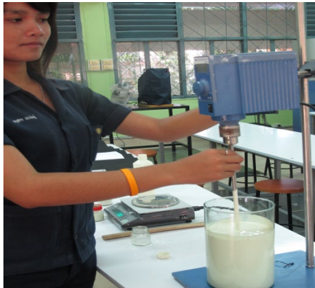
ภาพที่ 6.8 การเตรียมและกวนน้ำยางคอมปาวด์ด้วยการกวนอย่างต่อเนื่อง ที่มา : สุรศักดิ์ เทพทอง, 2557
