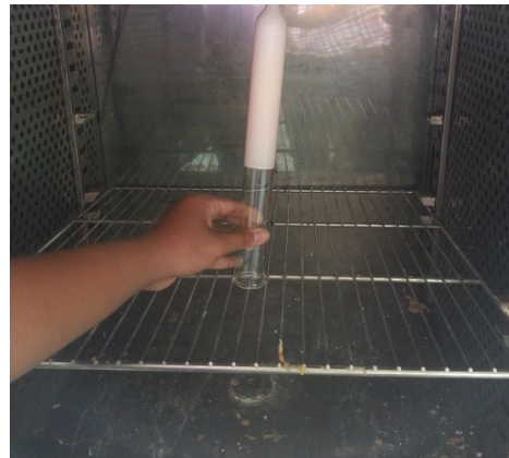
ภาพที่ 3.9 จุ่มหลอดแก้วในน้ำยางผสมสารเคมีและอบแห้ง
