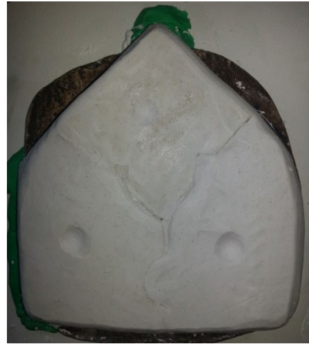
ภาพที่ 4.20 กั้นดินน้ำมันและทาปูนปลาสเตอร์ให้ทั่วพิมพ์ ที่มา : สุรศักดิ์ เทพทอง, 2557
