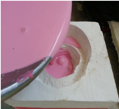
ภาพที่ 6.5 การหล่อผลิตภัณฑ์ยางด้วยแม่พิมพ์ปูนปลาสเตอร์ ที่มา : สุรศักดิ์ เทพทอง, 2557
