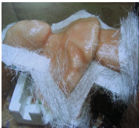
ภาพที่ 5.29 พิมพ์ครอบไฟเบอร์กลาสยังไม่ได้ตกแต่งขอบพิมพ์ ที่มา : สุรศักดิ์ เทพทอง, 2557
