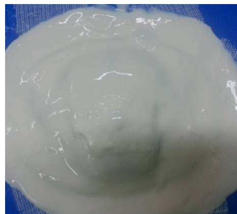
ภาพที่ 7.27 ตัดผ้ากอซให้เป็นชั้นสี่เหลี่ยมปูซ้อนกันวางบริเวณที่ลงยางเอาไว้ ที่มา : สุรศักดิ์ เทพทอง, 2557
