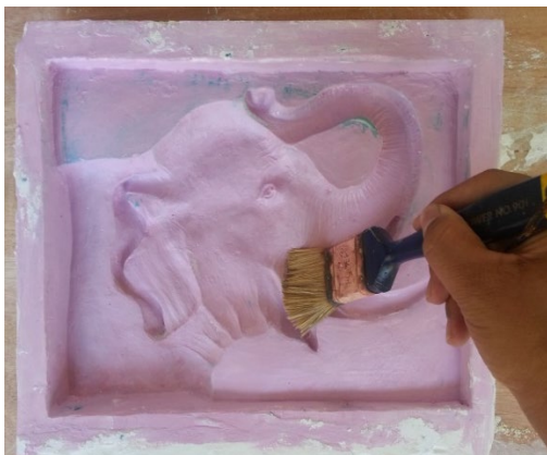
ภาพที่ 4.11 ทาปูนปลาสเตอร์ให้ทั่วแม่พิมพ์ ที่มา : สุรศักดิ์ เทพทอง, 2557
