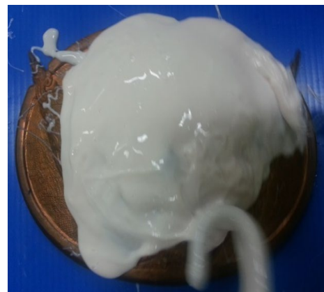
ภาพที่ 7.26 ผสมยางซิลิโคนกับตัวทำแข็งและเทยางให้ทั่วชิ้นงานรูปต้นแบบ ที่มา : สุรศักดิ์ เทพทอง, 2557
