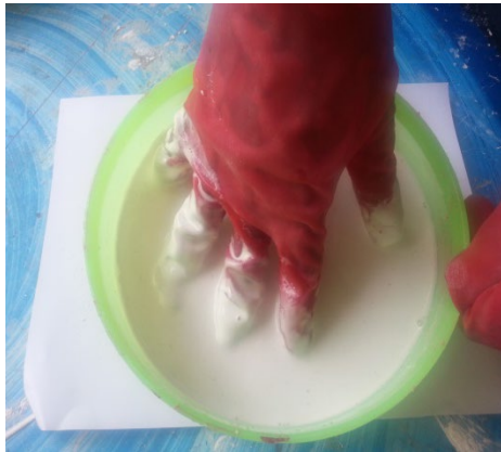
ภาพที่ 4.28 ผสมปูนปลาสเตอร์และพอกบนแม่พิมพ์รูปต้นแบบ ที่มา : สุรศักดิ์ เทพทอง, 2557
