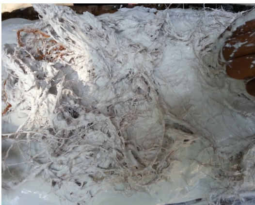
ภาพที่ 7.24 ปูนปลาสเตอร์ผสมเส้นใยมะพร้าวเสริมแรงแม่พิมพ์ครอบ ที่มา : สุรศักดิ์ เทพทอง, 2557
