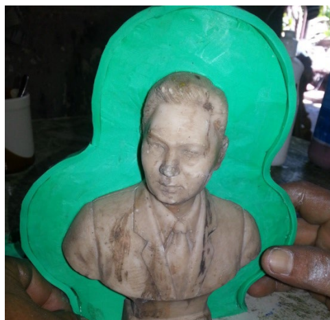
ภาพที่ 5.17 กั้นแนวรอบขอบด้วยดินน้ำมัน ที่มา : สุรศักดิ์ เทพทอง, 2557
