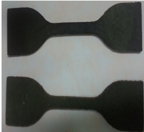
ภาพที่ 3.8 แสดงการทดสอบน้ำยางผสมสารเคมีโดยใช้ Tensile Tester ที่มา : สุรศักดิ์ เทพทอง, 2557
