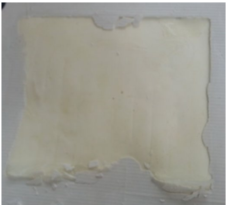
ภาพที่ 4.29 ด้านหลังของแม่พิมพ์ต้นแบบปูนปลาสเตอร์ ที่มา : สุรศักดิ์ เทพทอง, 2557
