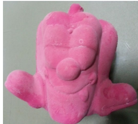
ภาพที่ 6.5 การหล่อผลิตภัณฑ์ยางด้วยแม่พิมพ์ปูนปลาสเตอร์ ที่มา : สุรศักดิ์ เทพทอง, 2557
