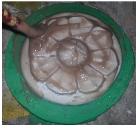
ภาพที่ 4.35 ทาเรซินและเสริมแรงด้วยใยแก้ว
