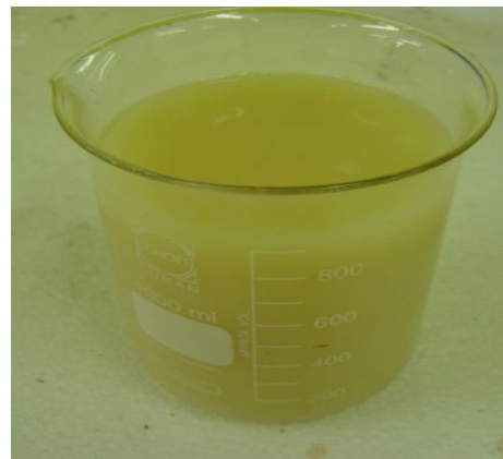
ภาพที่ 2.3.1 การเตรียม 20% สบู่โพแทสเซียมโอเลต
