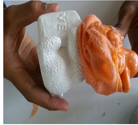
ภาพที่ 7.7 ชิ้นงานปูนปลาสเตอร์ที่หล่อจากแม่พิมพ์ยาง ที่มา : สุรศักดิ์ เทพทอง, 2557
