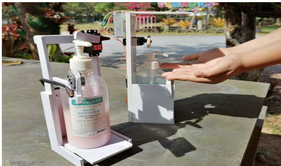
ภาพที่ 8 เครื่องกดเจลแอลกอฮอล์แบบไม่สัมผัส
