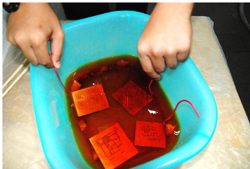
ภาพที่ 3.24 ขั้นตอนการกัดแผ่นวงจรพิมพ์หรือแผ่นปริ้นท์
