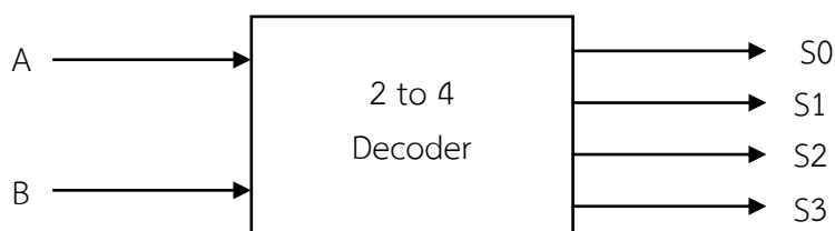
ภาพที่ 5.1 บล็อกไดอะแกรมหลักการแปลงสัญญาณ 2 to 4 Decoder
