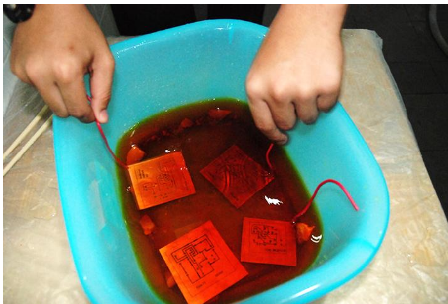
ภาพที่ ก.2 กัดแผ่นลายวงจรพิมพ์ที่ออกแบบไว้
