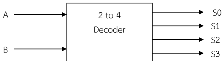
ภาพที่ 2.13 บล็อกไดอะแกรมหลักการแปลงสัญญาณ 2 to 4 Decoder
