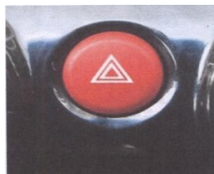
(ข) สวิตช์ไฟฉุกเฉิน
