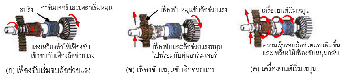
รูปที่ 5.11 การทำงานของชุดเฟืองขับแบบเบนดิก
