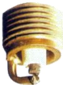
รูปที่ 6.12 หัวเทียนมีสภาพไหม้และกร่อน
