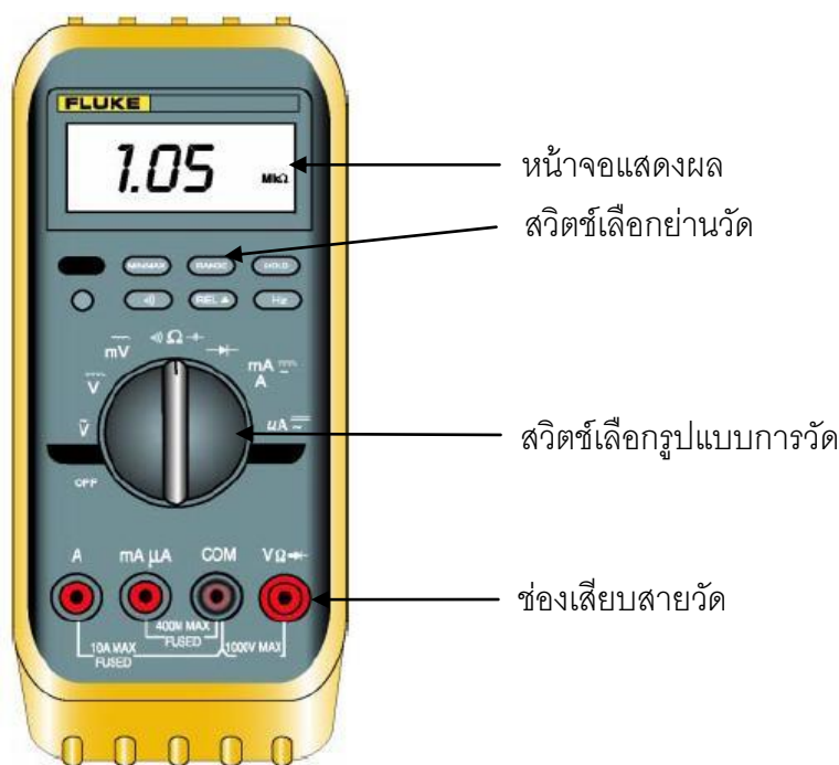
รูปที่ 3.8 ส่วนประกอบของมัลติมิเตอร์แบบดิจิทัล
