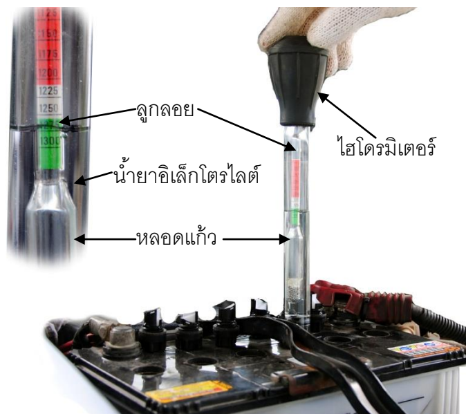
รูปที่ 4.22 การตรวจวัดความถ่วงจำเพาะของน้ำยาอิเล็กโทรไลต์แบตเตอรี่
