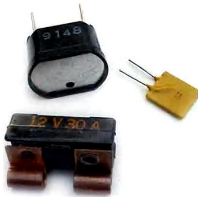
รูปที่ 2.16 เซอร์กิตเบรกเกอร์
