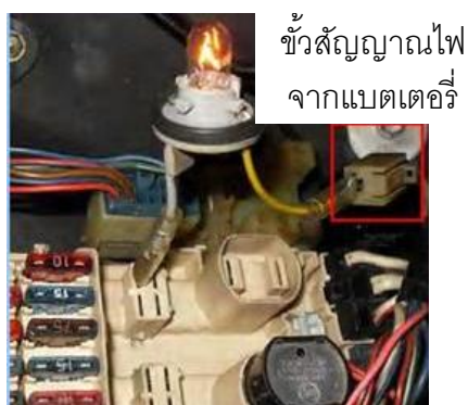
รูปที่ 3.14 การใช้หลอดไฟทดสอบ
