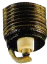
รูปที่ 6.9 หัวเทียนมีสภาพแห้ง มีสีน้ำตาลอ่อน
