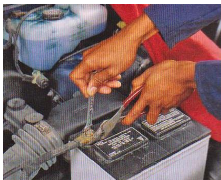
รูปที่ 4.18 การขันขั้วแบตเตอรี่ให้แน่น
