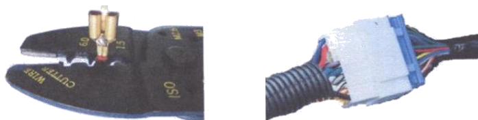
รูปที่ 2.13 การต่อโดยใช้ขั้วต่อแบนและปลั๊กเสียบ
