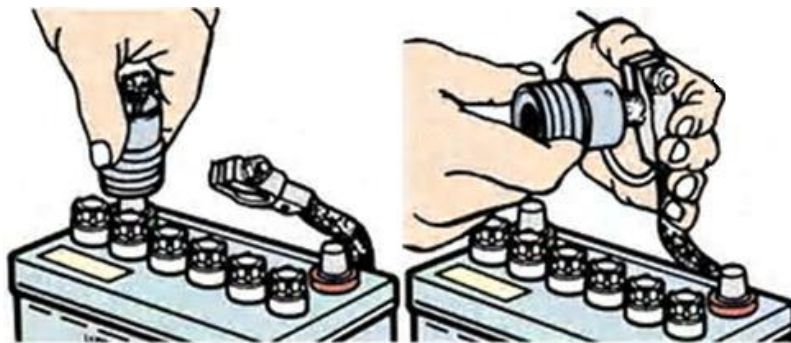
รูปที่ 4.17 การใช้เครื่องมือทำความสะอาดขั้วแบตเตอรี่และขั้วสายแบตเตอรี่
