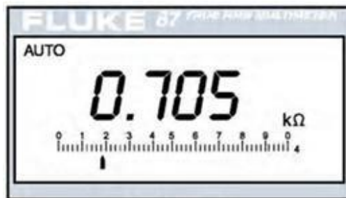
รูปที่ 3.12 ผลการวัดค่าอัตโนมัติต่อมัลติมิเตอร์วัดตัวต้านทาน 700 โอห์ม
