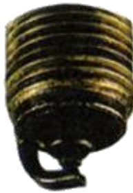
รูปที่ 6.11 หัวเทียนมีสภาพคราบน้ำมันเครื่องติดเปียก
