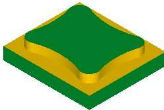
ภาพที่ 6.14 แสดงชิ้นงานเมื่อกัดตามเส้นรอบรูปด้วยคำสั่ง Multi passes ที่มา : ศักดิ์ดา สิมเสมอ, 2559
