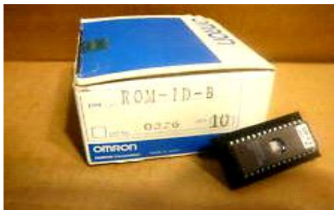
ภาพที่ 2-8 แสดงหน่วยความจำ ROM เครื่องโปรแกรมเมเบิล (PLC)
