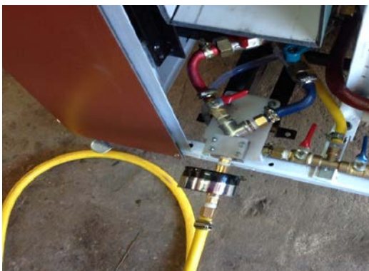
ภาพที่ ข.16 แสดงตำแหน่งในการติดตั้งชุดสายยางฉีดล้างทำความสะอาดที่ถูกต้อง
