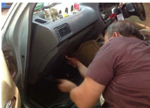
ภาพที่ ค.12 ถอดคอนโซลด้านหน้าตำแหน่งที่นั่งผู้โดยสารข้างคนขับออก
