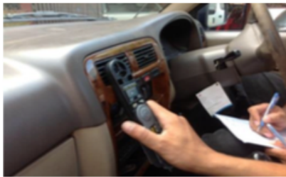
รูปที่ 15 เก็บผลการทดลองวัดค่าอุณหภูมิและความเร็วลมภายในห้องโดยสารหลังทำการล้างทำความสะอาดชุดคอยล์เย็น
