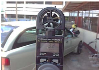
ภาพที่ 3.16 วัดอุณหภูมิและความเร็วลมภายนอกห้องโดยสารรถยนต์
