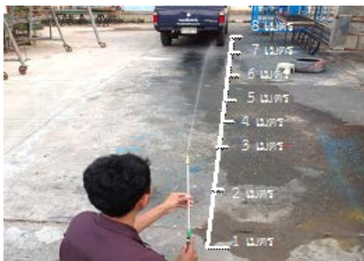
ภาพที่ ค.18 ทดสอบแรงดันการฉีดล้างของหัวฉีดล้างทำความสะอาด
