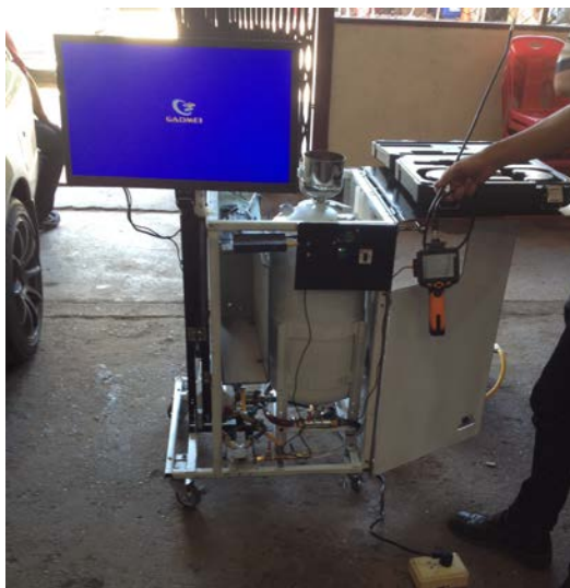
ภาพที่ ค.34 นำรถผู้ใช้บริการเข้ามาทดลองล้างทำความสะอาดด้วยเครื่องล้างทำความสะอาดชุดคอยล์เย็นรถยนต์
