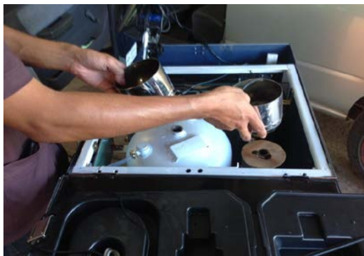
ภาพที่ ข.43 ถอดกรวยรองน้ำออกจากถังบรรจุน้ำ
