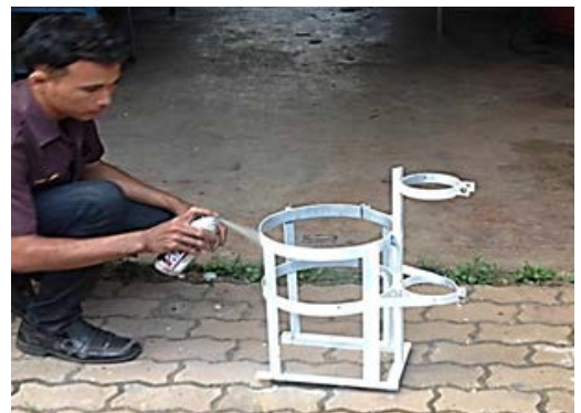
ภาพที่ ก.6 พ่นสีแท่นจับยึดถังบรรจุน้ำและ ถังบรรจุน้ำยา
