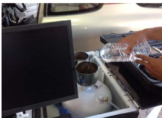
ภาพที่ ข.8 เติมน้ำเปล่าลงในถังบรรจุน้ำในปริมาณ 20 ลิตรต่อการล้างหนึ่งครั้ง
