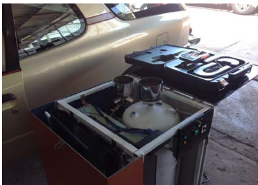
ภาพที่ ข.7 การติดตั้งอุปกรณ์พร้อมเติมน้ำและน้ำยาล้างทำความสะอาดลงถัง
