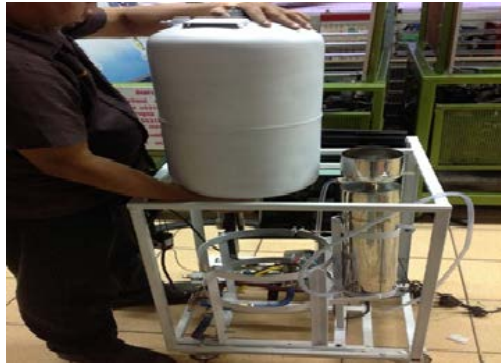
ภาพที่ ก.9 ประกอบถังน้ำและถังน้ำยาเข้ากับโครงสร้างหลัก
