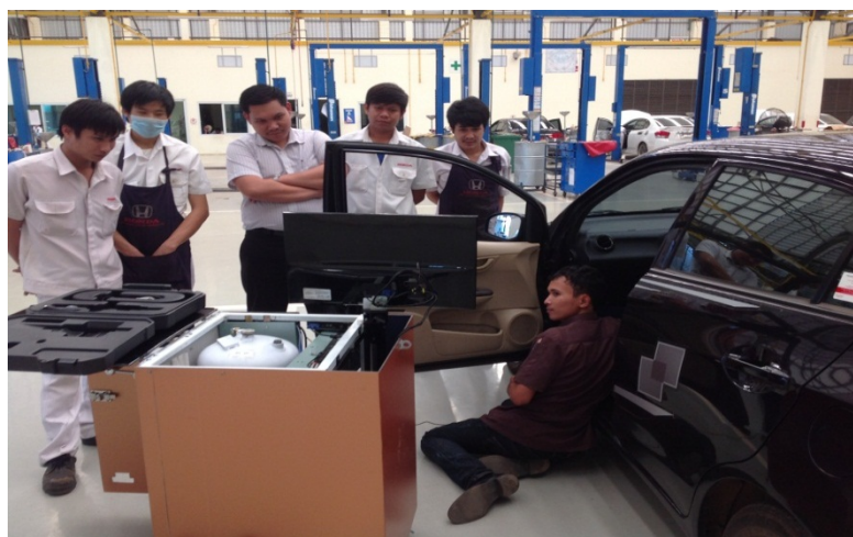
ภาพที่ ค.31 ทำการล้างชุดคอยล์เย็นโดยใช้เครื่องล้างทำความสะอาดชุดคอยล์เย็นรถยนต์ ให้ช่างประจำศูนย์บริการซ่อมรถยนต์ที่บริษัทหนองคายฮอนด้าอโตบิล จำกัด โดยทำการทดลองกับรถยนต์ ยี่ห้อ HONDA รุ่น CIVIC SEDAN COMPACT CAR และให้ช่างผู้เชี่ยวชาญช่วยประเมินแบบสอบถามความคิดเห็นสำหรับผู้เชี่ยวชาญ ที่มีต่อเครื่องนี้
