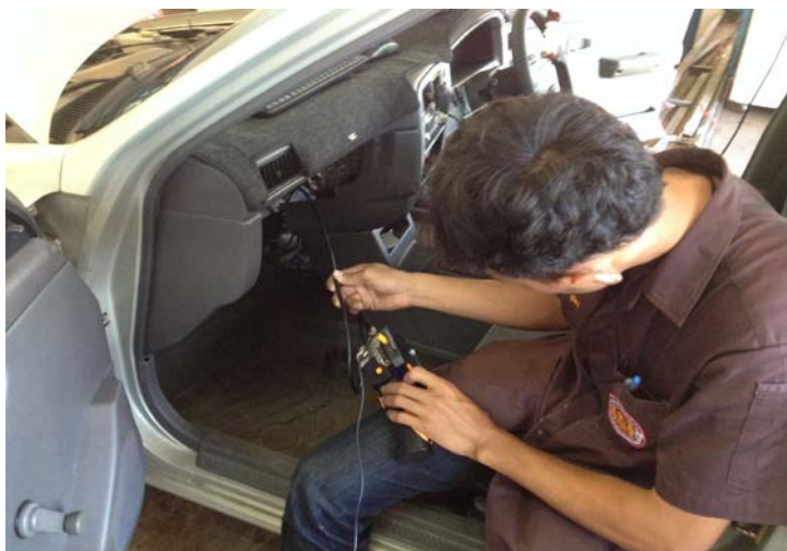
ภาพที่ ค.35 ทำการล้างชุดคอยล์เย็นโดยใช้เครื่องล้างทำความสะอาดชุดคอยล์เย็นรถยนต์ ให้ผู้ใช้บริการดู ณ วิทยาลัยเทคนิคหนองคาย โดยทำการทดลองกับรถยนต์ยี่ห้อ NISSAN รุ่น NV และให้ผู้ใช้บริการช่วยประเมินแบบสอบถามความพึงพอใจของผู้ใช้บริการที่มีต่อเครื่องนี้
