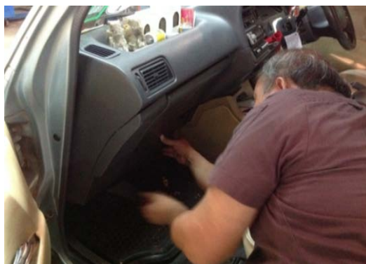
ภาพที่ ข.21 ถอดชุดคอนโซลด้านหน้าตำแหน่งที่นั่งด้านข้างคนขับออก
