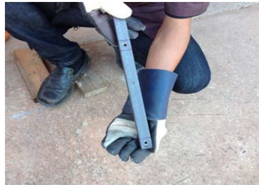
ภาพที่ ก.4 ตัดและเจาะเหล็กตามขนาดที่กำหนด
