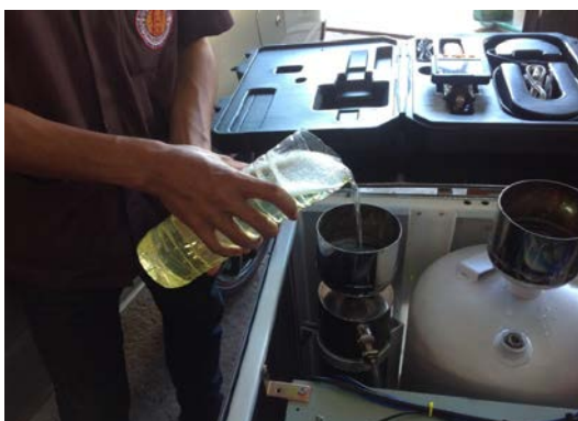
ภาพที่ ข.11 เติมน้ำยาที่ใช้ล้างทำความสะอาดชุดคอยล์เย็นลงในถังประมาณ 1 ลิตร
