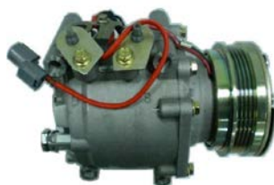
ภาพที่ 2.2 คอมเพรสเซอร์ (Compressor) (ที่มา : ชินภัทร แก้วโกมินทองษ์. 2560)
