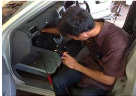
ภาพที่ 3.21 ตรวจสอบชุดคอยล์เย็นด้วยกล้อง Snake Scope ก่อนทำการล้าง
