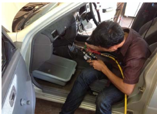
ภาพที่ ค.19 ล้างทำความสะอาดชุดคอยล์เย็นด้วยน้ำและน้ำยาล้างชุดคอยล์เย็น
