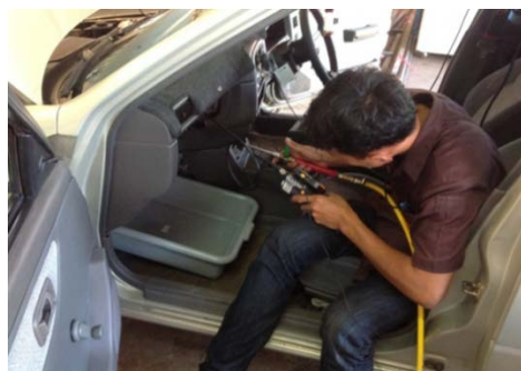
ภาพที่ 3.23 ใช้หัวฉีดน้ำแรงดันต่ำฉีดล้างทำความสะอาดชุดคอยล์เย็น
