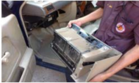
รูปที่ 6 อดดลินซ์กที่เก็บของออกจากคอนโซลหน้ารถยนต์
