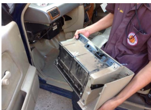
ภาพที่ ข.22 ถอดลิ้นชักที่เก็บของออกจากคอนโซลหน้ารถยนต์
