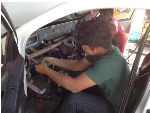
ภาพที่ 2.14 การล้างตู้แอร์รถยนต์แบบถอดตู้ (ที่มา : ชินภัทร แก้วโกมินทวงษ์. 2560)
