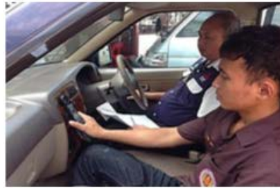
รูปที่ 4 เก็บผลการทดลองวัดค่าอุณหภูมิและความเร็วลมภายในห้องโดยสารก่อนทำการล้างทำความสะอาดชุดคอยล์เย็น
