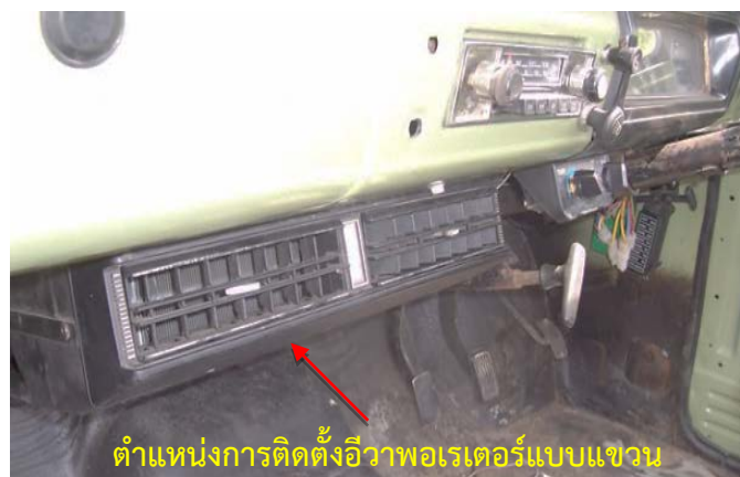
ภาพที่ 2.11 ตำแหน่งการติดตั้งชุดอีวาพอเรเตอร์แบบแขวน (ที่มา : ชินภัทร แก้วโกมินทวงษ์. 2560)
