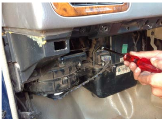
ภาพที่ ค.14 ถอดเทอร์โมสตัทออกจากชุดคอยล์เย็น
