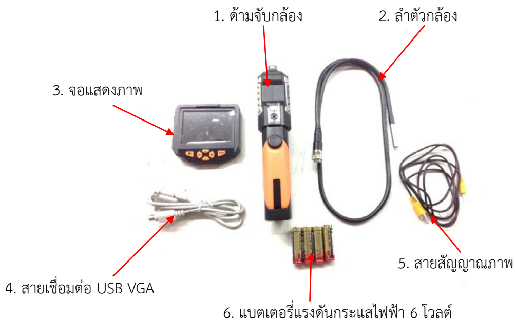
ภาพที่ 2.22 ส่วนประกอบของกล้อง Snake Scope แบบไม่มีสาย (ที่มา : ชินภัทร แก้วโกมินทวงษ์. 2560)
