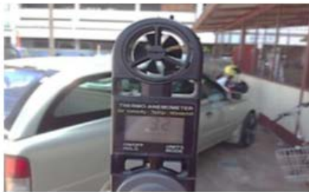
รูปที่ 3 วัดอุณหภูมิและความเร็วลมภายนอกห้องโดยสารรถยนต์
