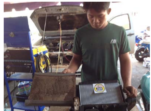
ภาพที่ 2.14 การล้างตู้แอร์รถยนต์แบบถอดตู้ (ที่มา : ชินภัทร แก้วโกมินทวงษ์. 2560)
