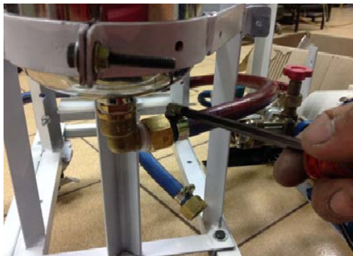
ภาพที่ ก.10 ประกอบวาล์วน้ำทางด้านส่งออกไป
