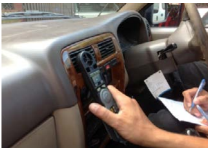
ภาพที่ 3.28 เก็บผลการทดลองวัดค่าอุณหภูมิและความเร็วลมภายในห้องโดยสาร หลังทำการล้างทำความสะอาดชุดคอยล์เย็นรถยนต์
