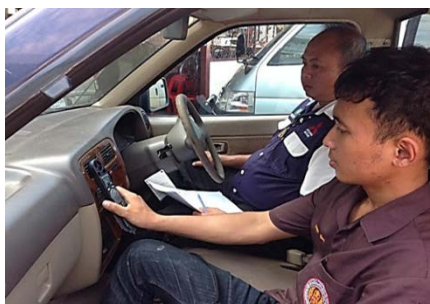
ภาพที่ 3.17 เก็บผลการทดลองวัดค่าอุณหภูมิและความเร็วลมภายในห้องโดยสาร
