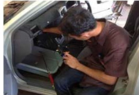
รูปที่ 8 การตรวจสอบชุดคอยล์เย็นด้วยกล้อง Snake Scope ก่อนทำการล้าง
