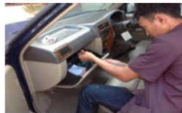
รูปที่ 14 ประกอบลีนซิกที่เก็บของเข้ากับชุดคอนโซลหน้ารถยนต์และทำการตรวจสอบความเรียบร้อยอีกครั้ง
