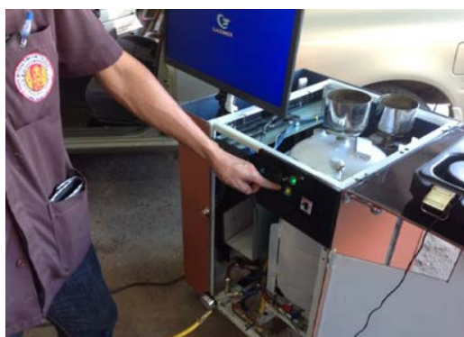
ภาพที่ ข.26 เปิดสวิตซ์ปั๊มตำแหน่ง ON ปั๊มก็จะทำงาน
