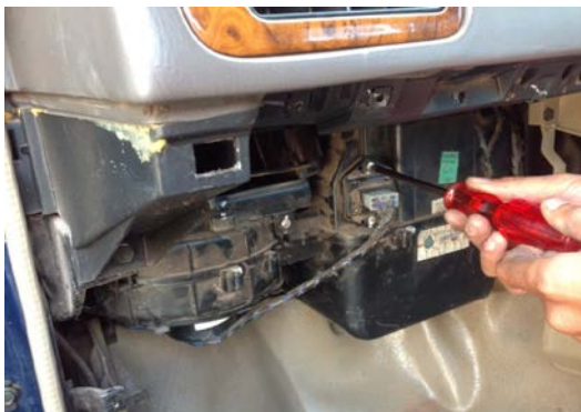
ภาพที่ ค.23 ประกอบติดตั้งเทอร์โมสแตตเข้าตำแหน่งเดิม
