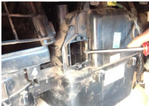
ภาพที่ ข.23 ถอดเทอร์โมสตัทออกจากชุดคอยล์เย็น
