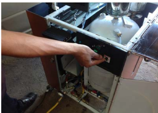
ภาพที่ ข.36 ทำการปิดสวิตซ์ตำแหน่ง OFF ให้เครื่องหยุดการทำงาน
