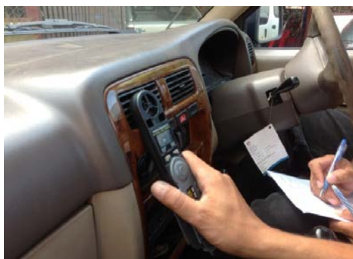
ภาพที่ ค.25 เก็บผลการทดลองหลังทำการล้างทำความสะอาดชุดคอยล์เย็น
