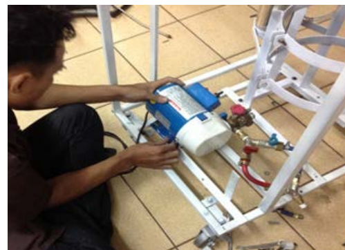
ภาพที่ ก.13 ประกอบปั๊มเข้ากับแท่นยึดปั๊ม
