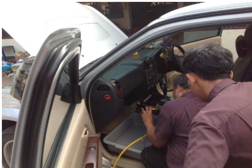
ภาพที่ ค.26 ทำการล้างทำความสะอาดชุดคอยล์เย็นรถยนต์ให้กับรถยนต์ยี่ห้อ ISUZU รุ่น NEW 7
