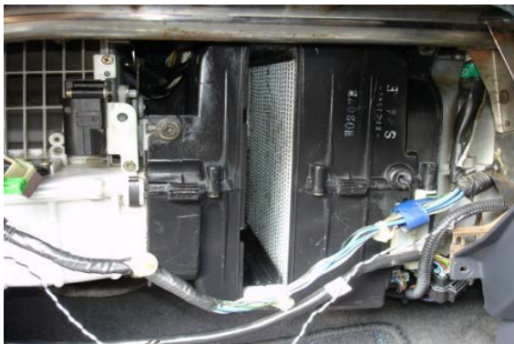
ภาพที่ 2.12 ตำแหน่งการติดตั้งชุดอีวาพอเรเตอร์แบบฝัง (ที่มา : ชินภัทร แก้วโกมินทวงษ์. 2560)
