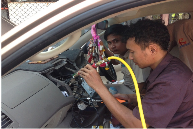
ภาพที่ ค.28 ทำการล้างทำความสะอาดชุดคอยล์เย็นรถยนต์ให้กับรถยนต์ ยี่ห้อ TOYOTA รุ่น VIGO CHAMP
