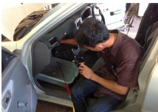
ภาพที่ ค.16 การตรวจสอบสภาพชุดคอยล์เย็นด้วยกล้อง Snake Scope
