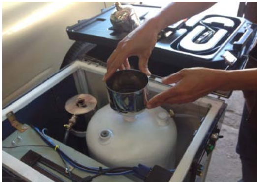
ภาพที่ ข.5 ติดตั้งกรวยเติมน้ำเข้ากับถังบรรจุน้ำสะอาด
