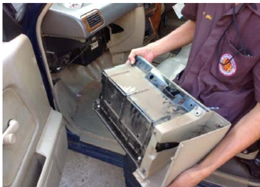
ภาพที่ ค.13 ถอดลิ้นชักออกจากคอนโซลหน้า
