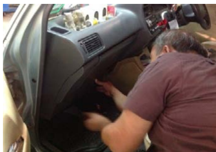
ภาพที่ 3.18 ถอดชุดคอนโซลด้านหน้าตำแหน่งที่นั่งด้านข้างคนขับออก
