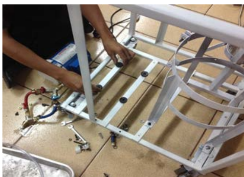
ภาพที่ ก.12 ใช้ยางรองป้องกันแรงสั่นสะเทือน
