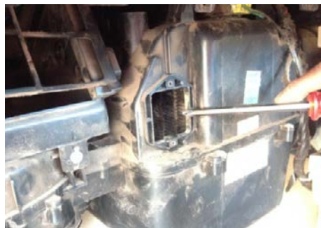
ภาพที่ 3.20 ถอดเทอร์โมสตัทออกจากชุดคอยล์เย็น
