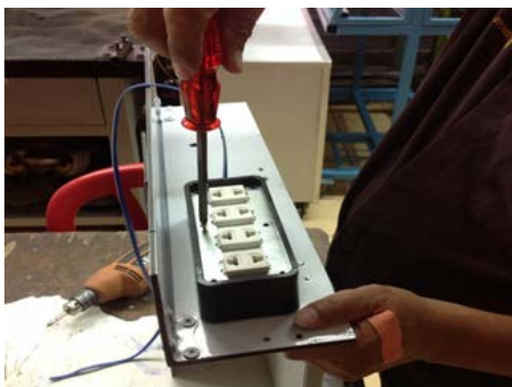
ภาพที่ ก.17 ประกอบชุดวงจรไฟฟ้าเข้ากับเครื่องล้างทำความสะอาดชุดคอยล์เย็นรถยนต์
