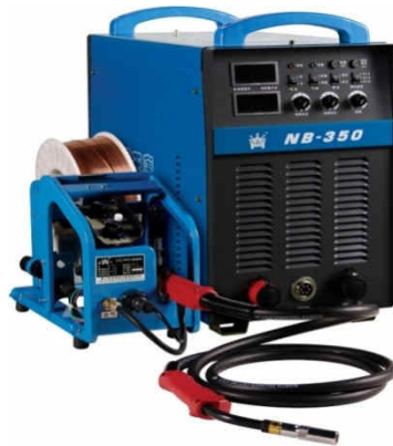
รูปที่ 2.3 แสดงลักษณะเครื่องเชื่อมแบบอาร์คโลหะแก๊สคลุม
