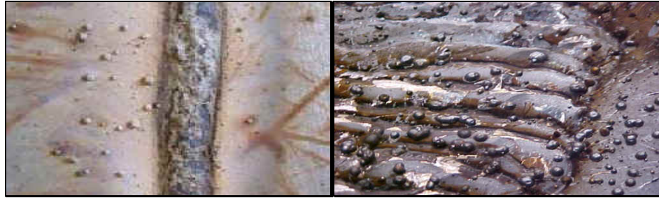
รูปที่ 8.25 แสดงลักษณะเม็ดน้ำโลหะกระเด็น (Spatter)
