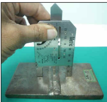
รูปที่ 3.19 แสดงลักษณะการวัดความสูงของแนวเชื่อมด้วยเกจวัด
