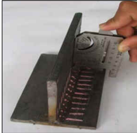
รูปที่ 3.20 แสดงลักษณะการวัดขนาดของ Leg of a Fillet Weld ด้วยเกจวัด
