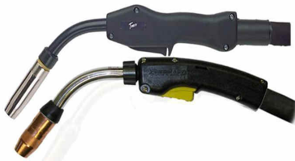
รูปที่ 2.16 แสดงลักษณะหัวเชื่อมแบบหล่อเย็นด้วยน้ำ
