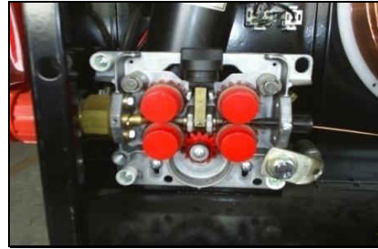
รูปที่ 2.6 แสดงลักษณะของชุดป้อนลวดแบบ 4 ล้อ
