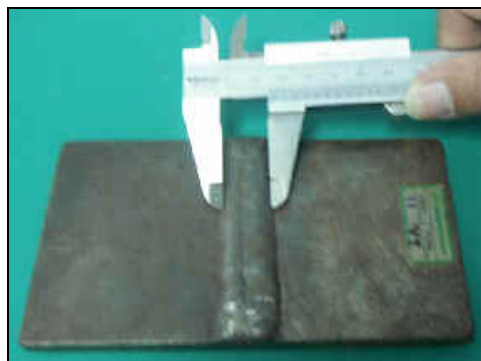
รูปที่ 3.17 แสดงลักษณะการตรวจสอบความกว้างของแนวเชื่อมด้วยเวอร์เนีย
