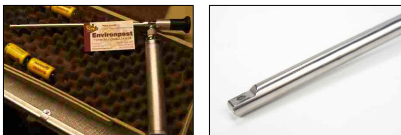
รูปที่ 3.12 แสดงลักษณะของโรคิตโบสโคป (Rigid Borescope)
