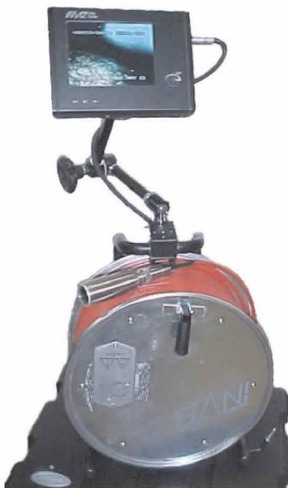
รูปที่ 3.15 แสดงลักษณะของ Miniature Camera
