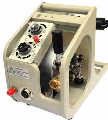
รูปที่ 2.4 แสดงลักษณะของชุดป้อนลวดเชื่อม
