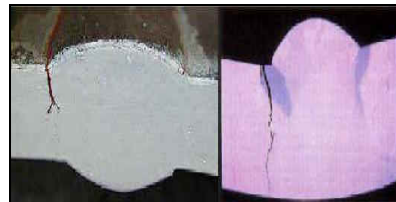
รูปที่ 8.7 แสดงการเกิดการแตกร้าเย็น (Hydrogen Crack/Cold Cracking)
