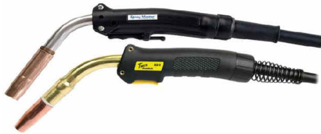
รูปที่ 2.15 แสดงลักษณะหัวเชื่อมแบบหล่อเย็นด้วยอากาศ
