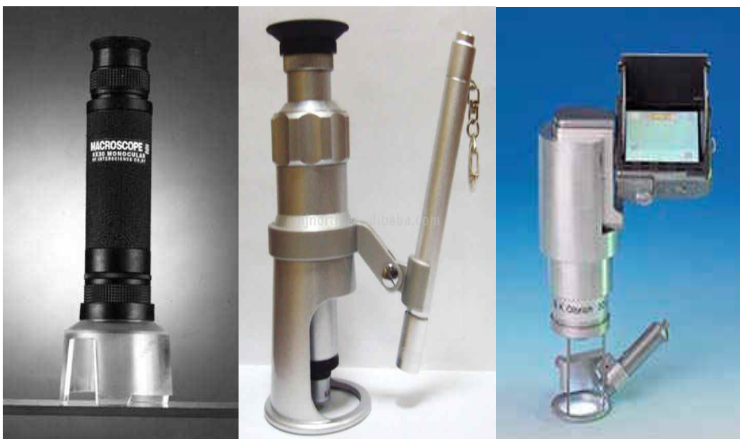
รูปที่ 3.4 แสดงลักษณะของกล้องไมโครสโคปแบบพกพา
