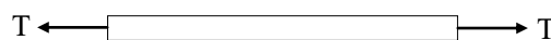
ภาพที่ 1.5 แรงตามแนวแกน ที่มา : เดชชัย ด่านวรรณกิจ (2546:2)
