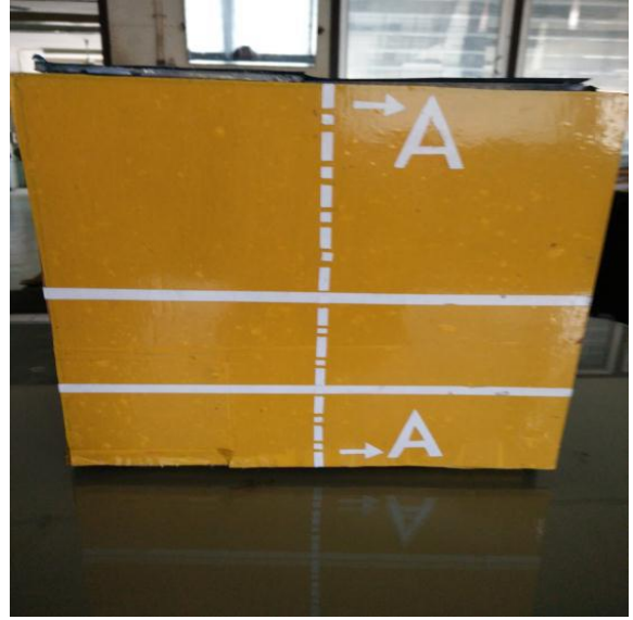
ตัวอย่างโมเดลภาพตัดเต็มที่พัฒนาขึ้นใช้ประกอบการจัดการเรียนรู้ เรื่องการเขียนภาพตัด วิชาเขียนแบบเทคนิคเบื้องต้น รหัสวิชา 2100 -1001
