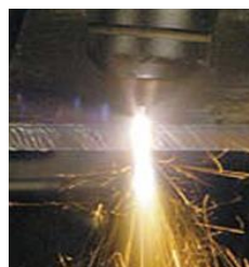
(ง) การตัดขึ้นรูปวัสดุด้วยพลาสมา
