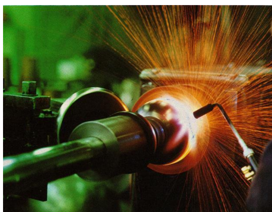
รูปที่ 4.23 การหมุนขึ้นรูปร้อน (Hot Spinning)
