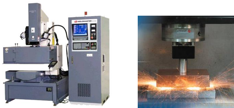
ภาพที่ 8.2 เครื่องกัดเซาะขึ้นรูปโลหะด้วยอิเล็กโตรด
