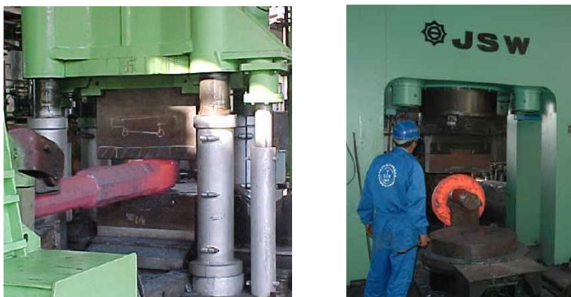
ภาพที่ 4.9 การตีด้วยค้อน
