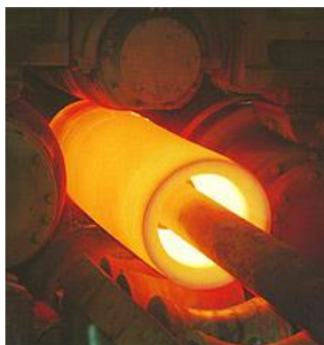
ภาพที่ 4.21 การผลิตท่อที่ไม่มีตะเข็บ (Piercing)
