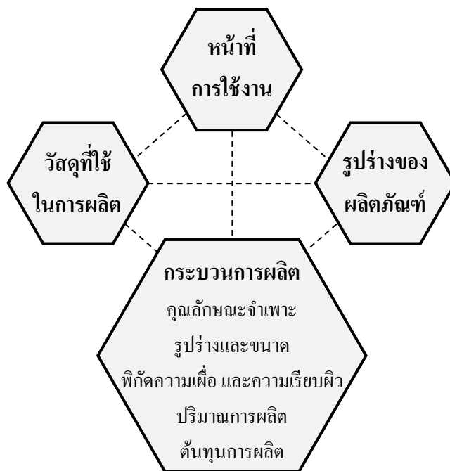
ภาพที่ 1.9 แผนภาพการเลือกกรรมวิธีการผลิต
