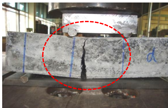
รูปที่ 1.8 การทดสอบแรงดึงของคอนกรีตโดยวิธีการดัด
