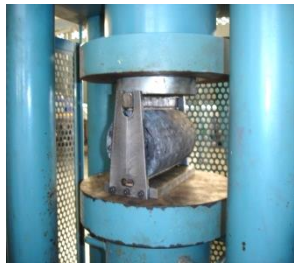
ค) การทดสอบแรงดึงแบบวิธีผ่าซีก
