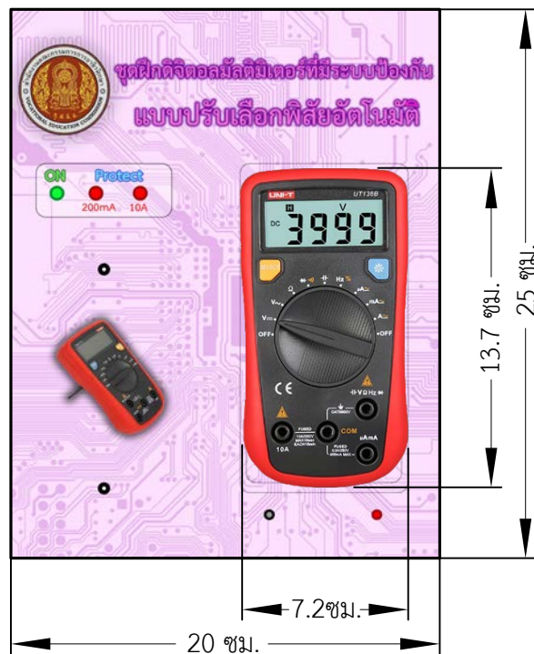
รูปที่ 3.45 การออกแบบด้านหน้าของชุดฝึกดิจิทัลมัลติมิเตอร์แบบปรับเลือกพิสัยอัตโนมัติที่มีระบบป้องกัน
