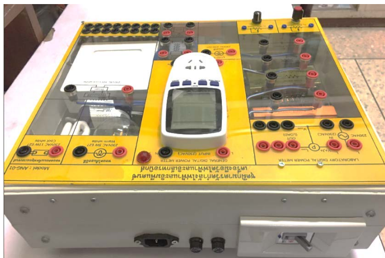
(ข) ด้านบนชุดฝึกมาตรวัดกำลังไฟฟ้าและอิมพีแดนซ์ เครื่องมือวัดไฟฟ้าและอิเล็กทรอนิกส์
