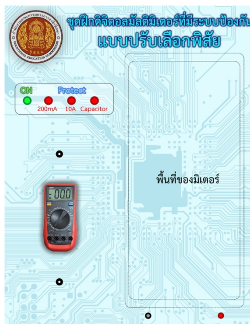
รูปที่ 3.27 หน้าปัดของชุดฝึกดิจิตอลมัลติมิเตอร์แบบปรับเลือกพิสัยที่มีระบบป้องกัน
