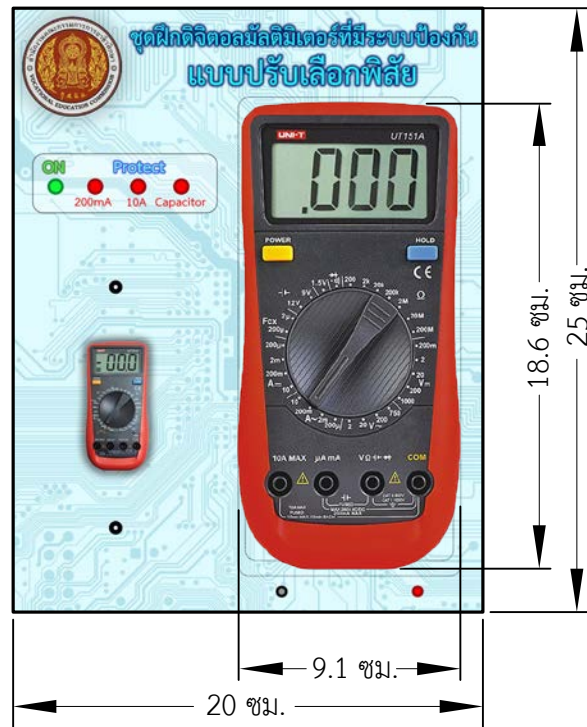
รูปที่ 3.30 การออกแบบด้านหน้าของชุดฝึกดิจิทัลมัลติมิเตอร์แบบปรับเลือกพิสัยที่มีระบบป้องกัน
