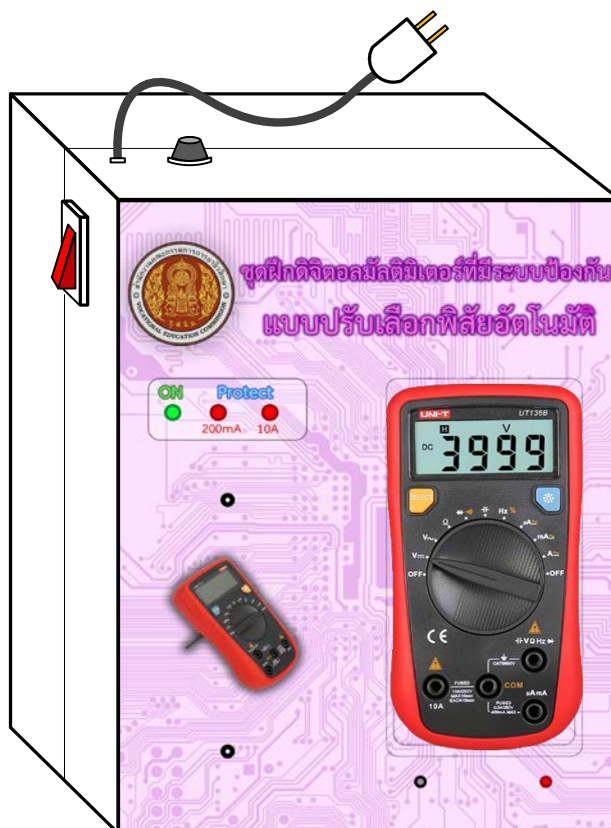
รูปที่ 3.48 ลักษณะภายนอกของชุดฝึกดิจิทัลมัลติมิเตอร์แบบปรับเลือกพิสัยอัตโนมัติที่มีระบบป้องกัน
