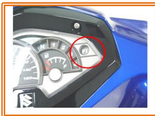
รูปที่ 7-63 แสดงตำแหน่งติดตั้งของหลอดไฟเช็คเครื่องยนต์ ที่มา : สื่อ Power Point ประกอบการอบรมรถจักรยานยนต์ Suzuki
