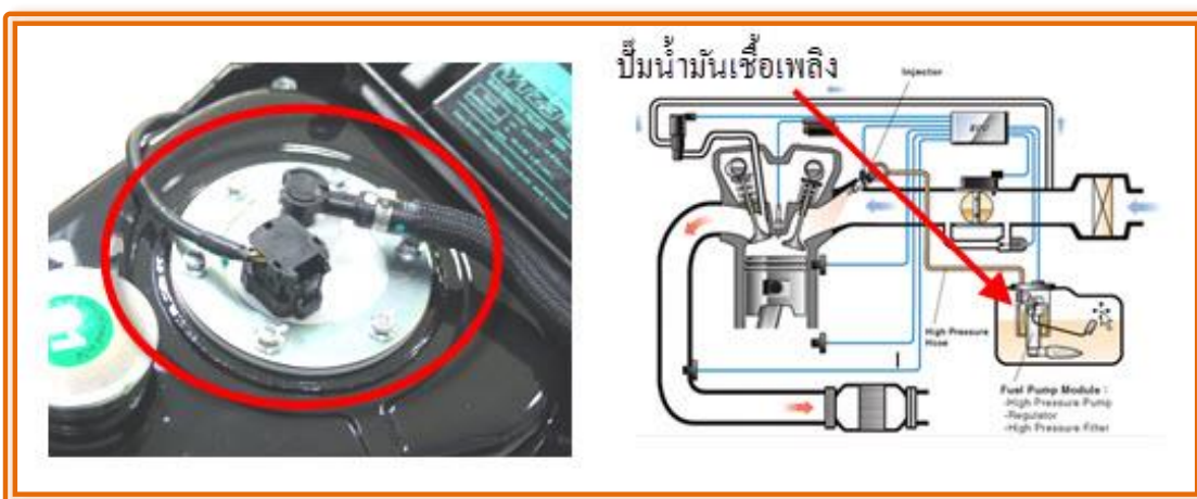
รูปที่ 7-50 แสดงตำแหน่งติดตั้งของปั๊มน้ำมันเชื้อเพลิง
