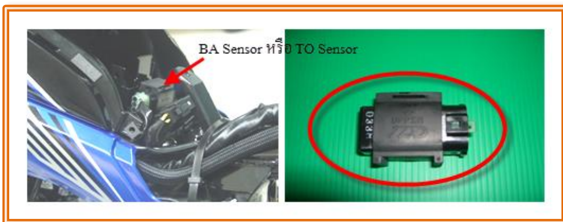
รูปที่ 7-45 แสดงตำแหน่งติดตั้งของ BA Sensor หรือ TO Sensor ที่มา : สื่อ Power Point ประกอบการอบรมรถจักรยานยนต์ Suzuki
