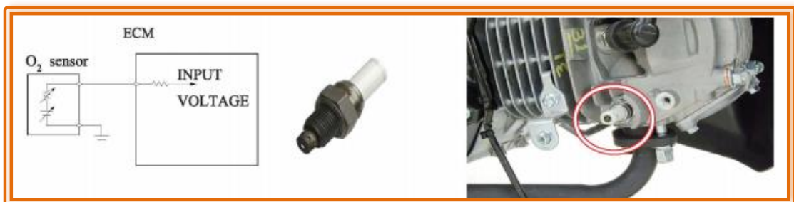
รูปที่ 7-32 แสดงการทำงาน การส่งสัญญาณทางไฟฟ้าและตำแหน่ง O 2 Sensor ที่มา : คู่มือประกอบการอบรมรถจักรยานยนต์ Honda Click125i
