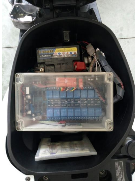
ภาพที่ 1.4 แสดงชุดควบคุมเพื่อจำลองสถานการณ์ปัญหาชุดฝึกปฏิบัติ
