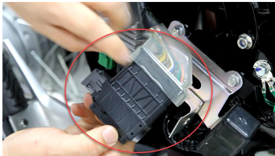
ภาพที่ 1.5 แสดงปลั๊กต่อระหว่างกล่อง ECU หรือ ECM กับชุดควบคุมจำลองสถานการณ์ปัญหา
