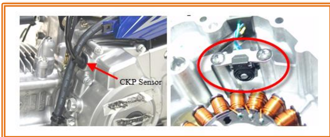
รูปที่ 7-41 แสดงตำแหน่งติดตั้งของ CKP Sensor ที่มา : สื่อ Power Point ประกอบการอบรมรถจักรยานยนต์ Suzuki
