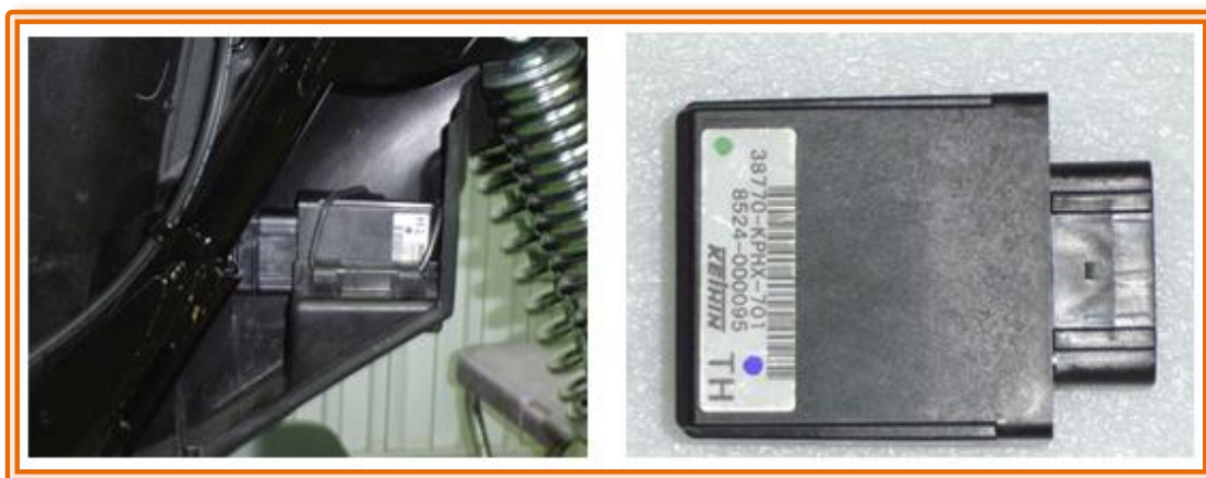
รูปที่ 7-56 แสดงตำแหน่งการติดตั้งและกล่อง ECM
