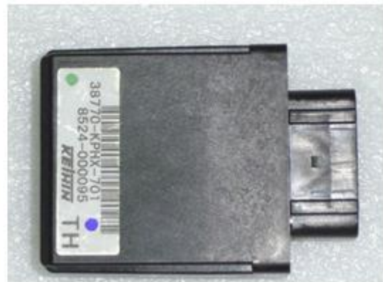
ภาพที่ 2-26 แสดงตำแหน่งการติดตั้ง และกล่อง ECM
