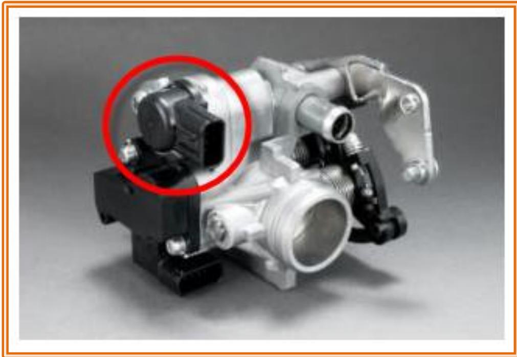
รูปที่ 7-72 แสดงมอเตอร์ตัวคุมรอบเดินเบา หรือมอเตอร์ ISC รถจักรยานยนต์ Yamaha ที่มา : สื่อ Power Point ประกอบการอบรมรถจักรยานยนต์ Yamaha Mixture Jet-Fuel Injection
