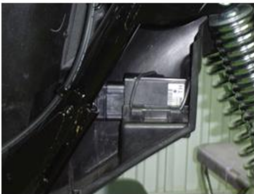
ภาพที่ 2-26 แสดงตำแหน่งการติดตั้ง และกล่อง ECM
