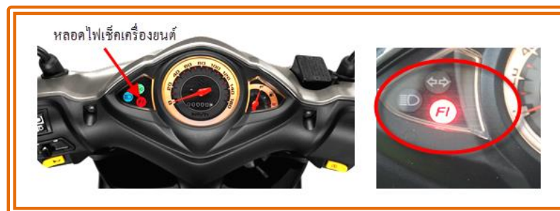
รูปที่ 7-62 แสดงหลอดไฟเช็คเครื่องยนต์ และตำแหน่งที่ติดตั้ง ที่มา : สื่อ Power Point ประกอบการอบรมรถจักรยานยนต์ Suzuki
