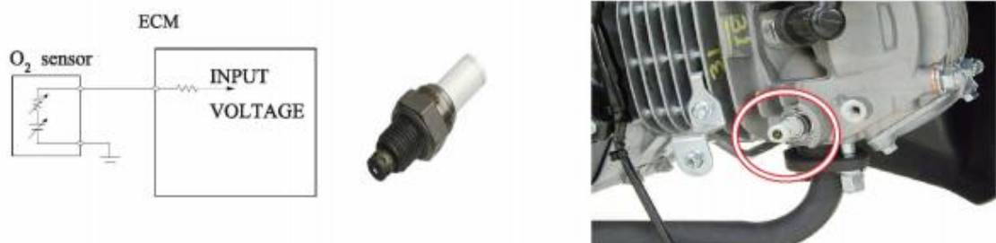
ภาพที่ 2-16 แสดงการทำงาน การส่งสัญญาณทางไฟฟ้าและตำแหน่ง O 2 Sensor
