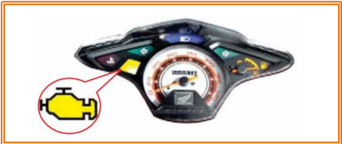
รูปที่ 7-60 แสดงหลอดไฟเช็คเครื่องยนต์ (FI-Indicator) ที่มา : คู่มือประกอบการอบรมรถจักรยานยนต์ Honda Click110i
