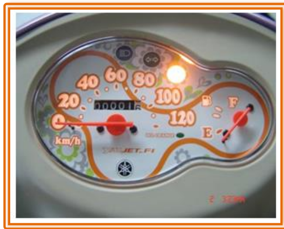
รูปที่ 7-61 แสดงหลอดไฟเช็คเครื่องยนต์ของ YMJET-FI
