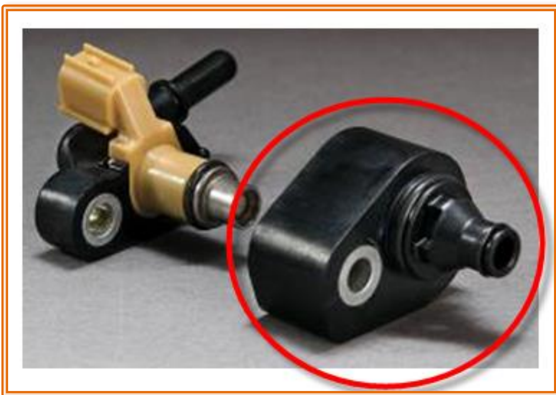
รูปที่ 7-71 แสดงห้องผสมไอดี ระบบ YMJET-FI รถจักรยานยนต์ Yamaha ที่มา : สื่อ Power Point ประกอบการอบรมรถจักรยานยนต์ Yamaha Mixture Jet-Fuel Injection
