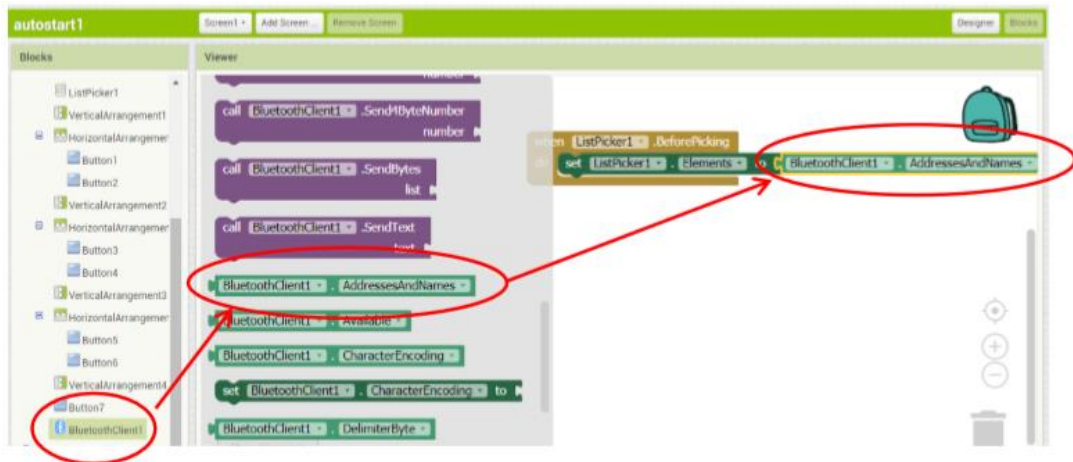
ภาพที่ 2-71 แสดงเลือก Bluetooth client เลือก address and name
