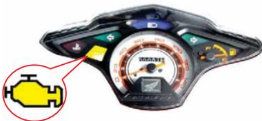
ภาพที่ 2-27 แสดงหลอดไฟเช็ครถยนต์ (FI-Indicator)
