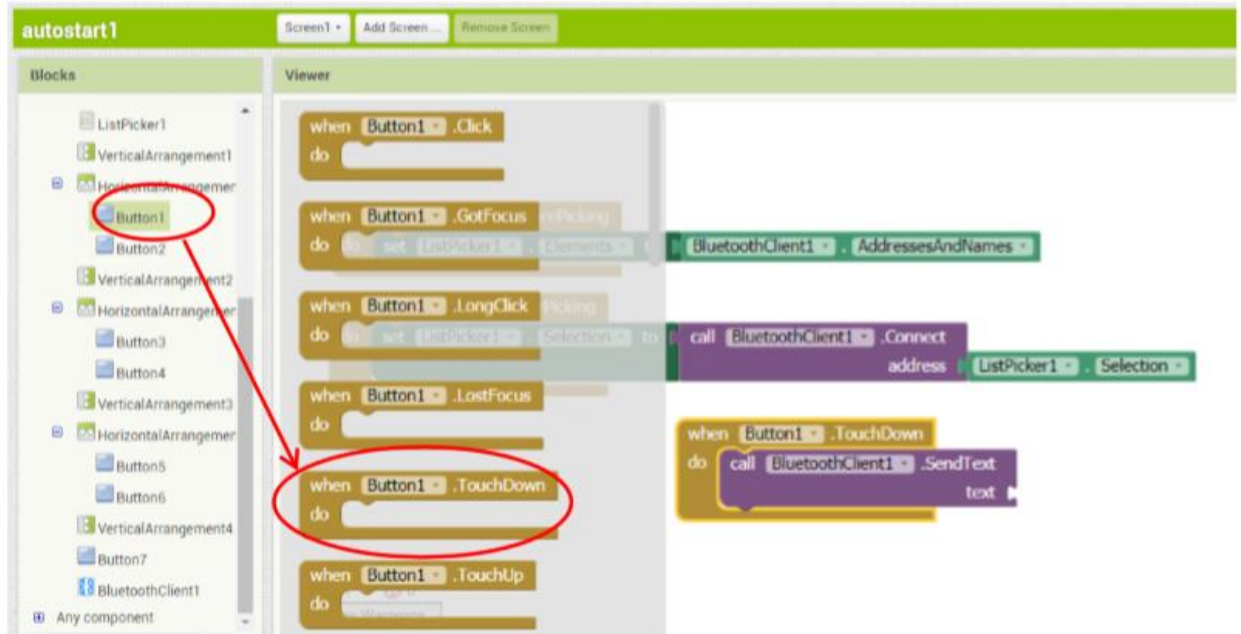
ภาพที่ 2-77 แสดงเลือก button1 เลือก Bluetooth client ..send Text
