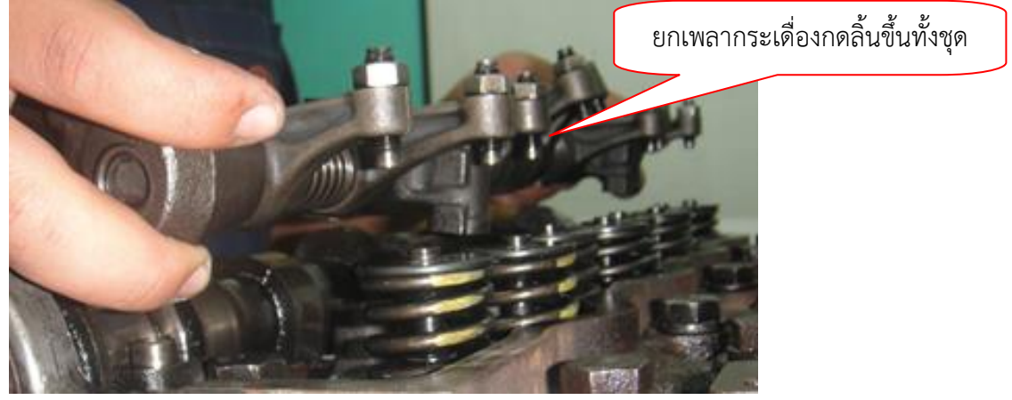
7.3 ถอดเพลลากระต่องกดลิ้น โดยยกเพลลากระต่องกดลิ้นขึ้นทั้งชุดห้ามถอดแยกกระต่องกดลิ้นออกจากเพลลากระต่องกดลิ้น
