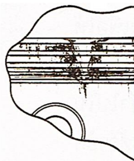
สีกรรหูเนื่องจากความร้อนสูงจากแก๊สในห้องเผาไหม้รั่วไหลลงมาผ่านแหวนลูกสูบ
