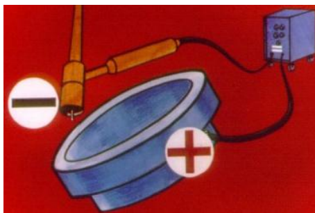
ภาพที่ 2-10 แสดงการต่อขั้วไฟเชื่อมหัวทอร์ชเป็นขั้วลบ
