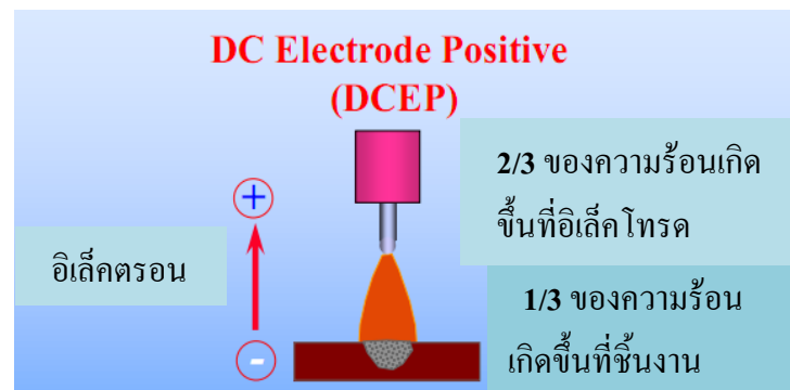
ภาพที่ 2-13 แสดงความร้อนที่เกิดจากการต่อขั้วเชื่อม DCEP
