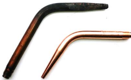
ภาพที่ 2.23 แสดงลักษณะของหัวทิพเชื่อม
