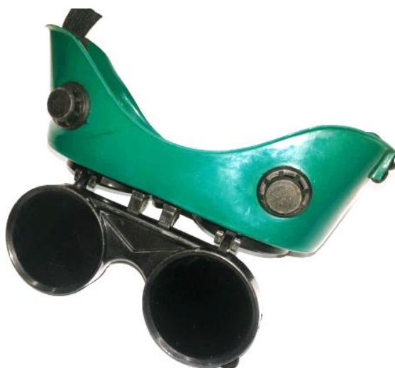
ภาพที่ 2.28 แสดงลักษณะของแว่นตาเชื่อมแก๊ส
