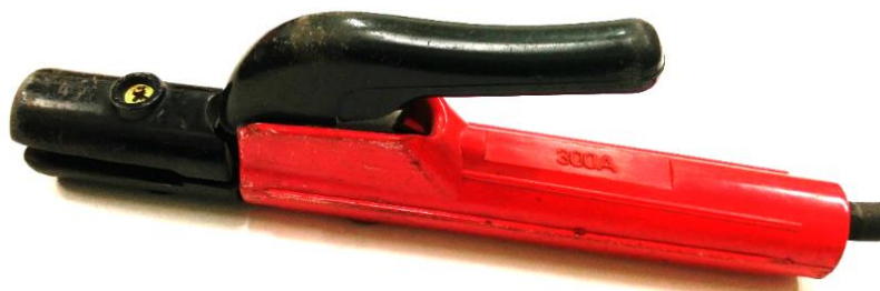
ภาพที่ 2.5 แสดงลักษณะตัวจับลวดเชื่อม (Electrode Holder)
