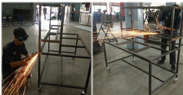
ภาพที่ 3.4 แสดงภาพการเจียระไนตกแต่งรอยเชื่อมโครงชุดฝึก ฯ
