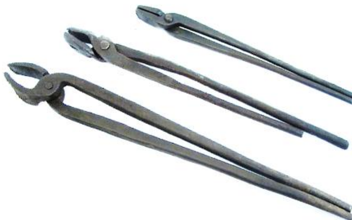
ภาพที่ 2.12 แสดงลักษณะของคีมจับชิ้นงานร้อน
