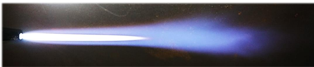
ภาพที่ 2.33 แสดงลักษณะของเปลวคาร์บอนมาก
