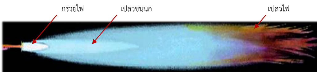
ภาพที่ 2.32 แสดงลักษณะโครงสร้างของเปลวคาร์บอนมาก
