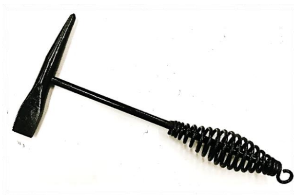
ภาพที่ 2.10 แสดงลักษณะของค้อนเคาะสแลก
