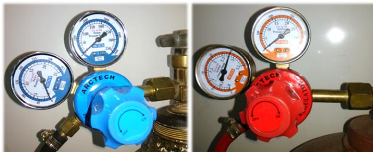
ภาพที่ 2.20 แสดงภาพอุปกรณ์คุมค่าความดันแก๊สออกซิเจน (ซ้าย) และอะเซทิลีน (ขวา)
