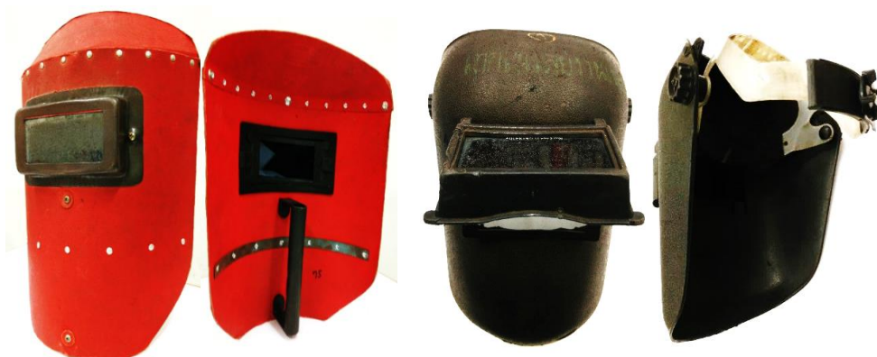
ภาพที่ 2.8 แสดงหน้ากากเชื่อมแบบมือถือและแบบสวมศีรษะ
