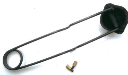
ภาพที่ 2.26 แสดงลักษณะของอุปกรณ์จุดเปลวไฟพร้อมถ่าน
