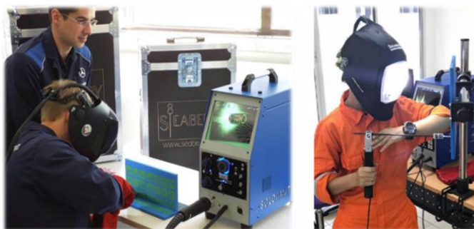
ภาพที่ 5.2 แสดงเครื่องฝึกทักษะการเชื่อมเสมือนจริง (Welding Simulator) (ที่มา : http://enterprise-ar-vr.com/system/wp-content/uploads/2017/06/Soldamatic-Mercedes.jpg (Online))
