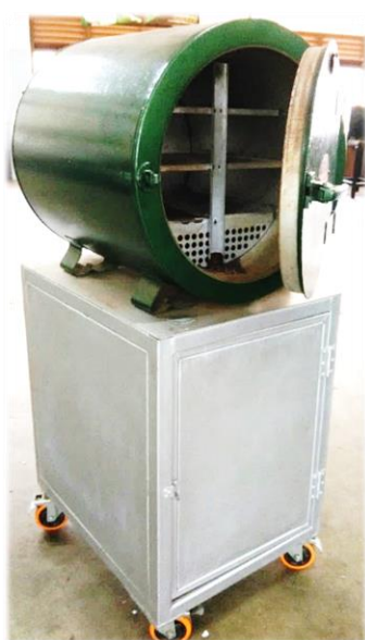
ภาพที่ 2.4 แสดงลักษณะของตู้อบหลอดเชื่อมหุ้มฟลักซ์
