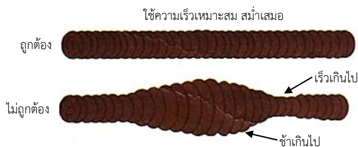
ภาพที่ 2.40 แสดงการใช้ความเร็วในการเคลื่อนหัวทิพที่ถูกต้องและไม่ถูกต้อง
