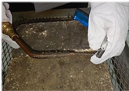
ภาพที่ 2.25 แสดงการทำความสะอาดรูหัวทิฟเชื่อมด้วยเข็มแยงหัวทิฟเชื่อม
