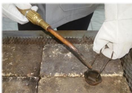
ภาพที่ 2.27 แสดงการจุดเปลวไฟเชื่อมด้วยอุปกรณ์จุดเปลวไฟ
