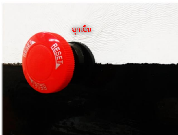
ภาพที่ 3.21 แสดงภาพปุ่มฉุกเฉิน เพื่อตัดวงจรการทำงานของชุดขับเคลื่อน และกระแสไฟฟ้าเข้าเครื่องเชื่อม
