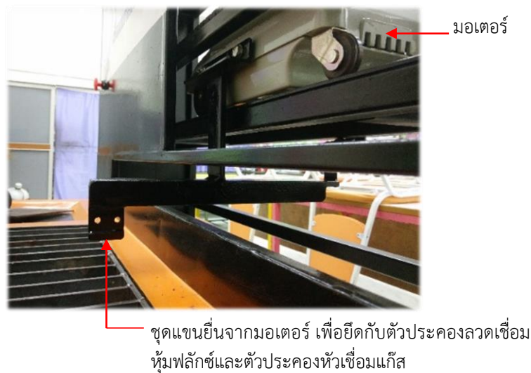
ภาพที่ 1.2 แสดงชุดแขนยื่นจากมอเตอร์เพื่อยึดกับตัวประกอบลวดเชื่อมหุ้มฟลักซ์ และตัวประกอบหัวเชื่อมแก๊ส
