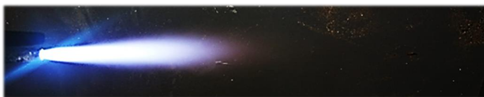
ภาพที่ 2.37 แสดงลักษณะของเปลวออกซิเจนมากหรือเปลวเพิ่ม
