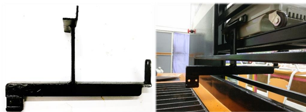
ภาพที่ 3.15 แสดงชุดแขนยื่นจากมอเตอร์ที่ยึดเข้ากับตัวประกอบลวดเชื่อมหุ้มฟลักซ์ และตัวประกอบหัวเชื่อมแก๊ส ที่สร้างขึ้นใหม่
