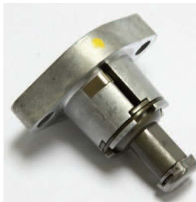
รูปที่ 2-22 แสดงตัวปรับความตึงโซ่ แบบธรรมดา ที่มา : คู่มือประกอบการอบรมรถจักรยานยนต์ Honda
