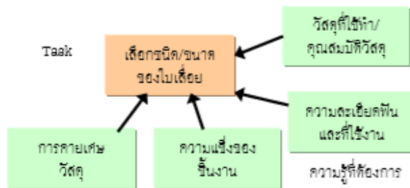
ภาพที่ 2-35 แสดงความรู้ที่จำเป็นในการเลือกชนิดและขนาดของใบเลื่อย
