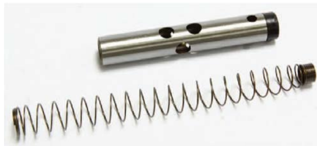
รูปที่ 2-23 แสดงตัวปรับความตึงโซ่ แบบอัตโนมัติ ที่มา : คู่มือประกอบการอบรมรถจักรยานยนต์ Honda
