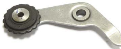
รูปที่ 2-23 แสดงตัวปรับความตึงโซ่ แบบอัตโนมัติ ที่มา : คู่มือประกอบการอบรมรถจักรยานยนต์ Honda
