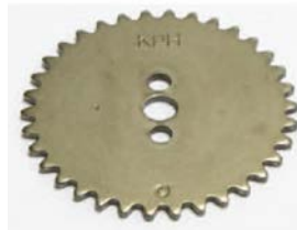
รูปที่ 2-20 แสดงเฟืองเพลาลูกเบี้ยว ที่มา : คู่มือประกอบการอบรมรถจักรยานยนต์ Honda
