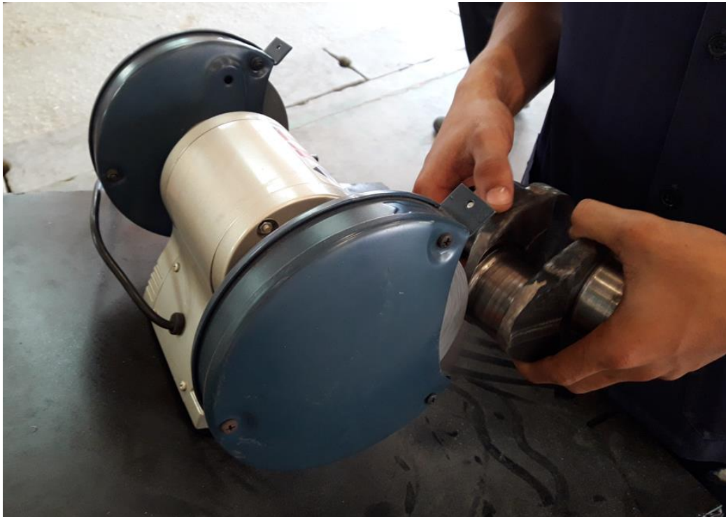
ภาพที่ 3-20 เจียร์ไนตคแต่งข้อหลักและข้อก้านของเพลาช้อเหวียง
