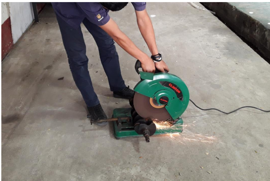
ภาพที่ 3-19 ตัดเพลลาข้อเหวี่ยงให้เหลือ 1 ช่วง
