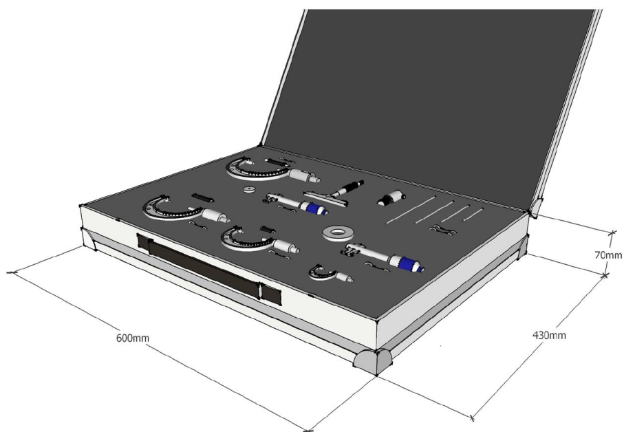
ภาพที่ 3-7 ด้านในชุดเครื่องมือไมโครมิเตอร์พร้อมขนาดที่ชัดเจน
