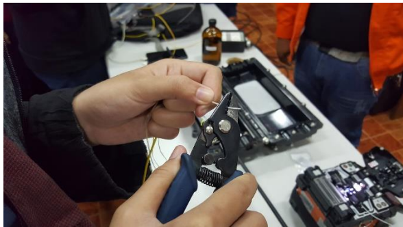
ภาพที่ 9.4 การปอกสาย Fiber
