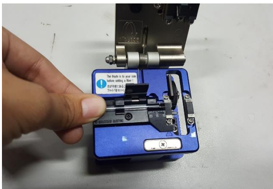
ภาพที่ 9.6 การตัด Fiber Core
