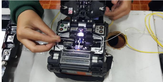
ภาพที่ 9.8 การสายใยแก้วนำแสงลงบนร่องตัว V
