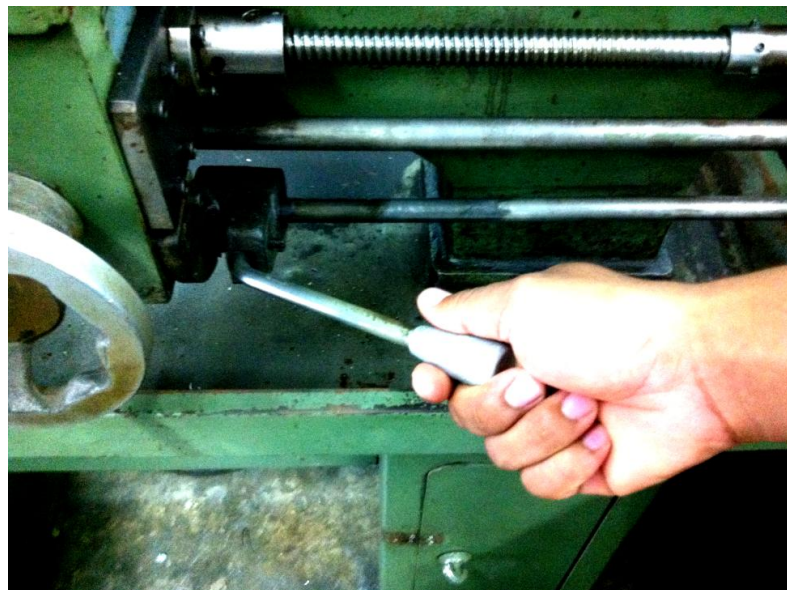
ภาพที่ 1-92 แสดงการยกแขนโยกขึ้น เปิด Spindle เครื่องกลึง
