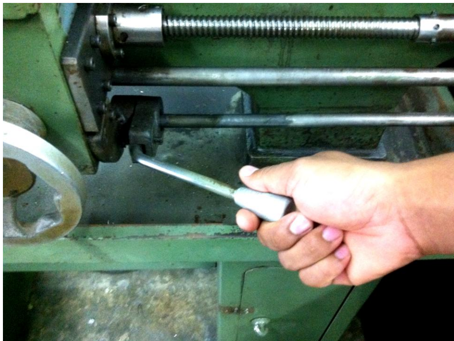
ภาพที่ 1-70 แสดงการยกแขนโยกขึ้น เปิด Spindle เครื่องกลึง
