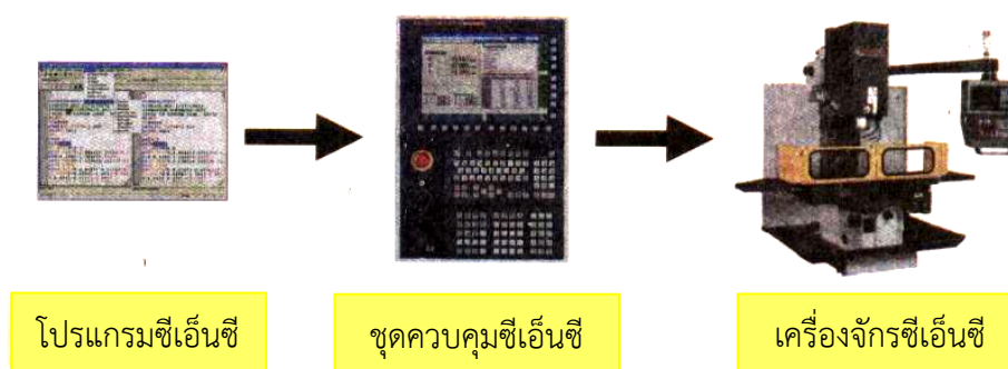
ภาพที่ 2-1 แสดงหลักการทำงานของเครื่องจักรกลซีเอ็นซี
