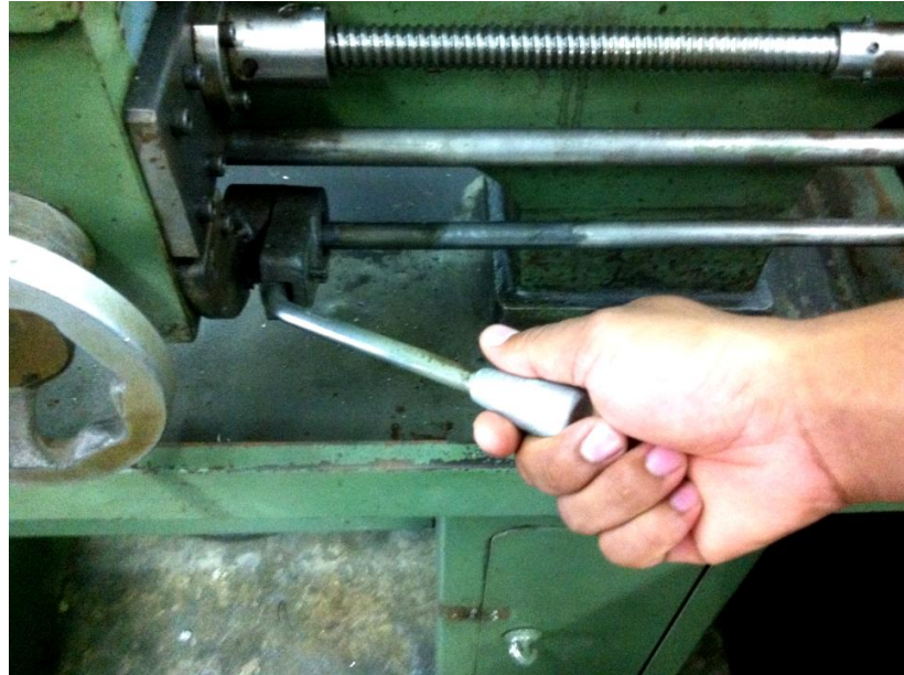
ภาพที่ 1-62 แสดงการยกแขนโยกขึ้น เปิด Spindle เครื่องกลึง
