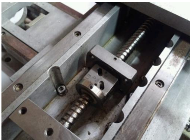
ภาพที่ 2-18 แสดงลักษณะการใช้งานและโครงสร้างของ Ball Screw
