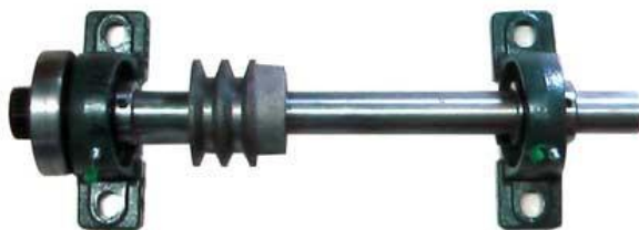
ภาพที่ 2-15 แสดงเพลลาสำหรับสวมสิ่งที่เหมาะสมได้ ที่มา : เอกชัย ไก่แก้ว (2563)
