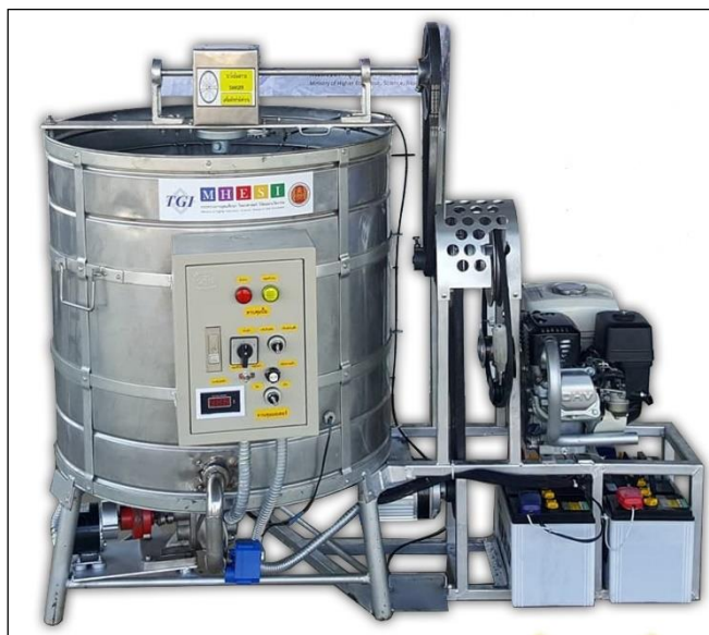
ภาพที่ 3-13 ชุดฝึกสมรรถนะเครื่องสลัดน้ำฝิ่งแบบอัตโนมัติ ที่มา : เอกชัย ไก่แก้ว (2563)
