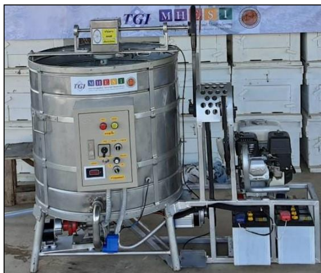
ภาพที่ 4-2 แสดงชุดฝึกสมรรถนะเครื่องสลัดน้ำผึ้งแบบอัตโนมัติที่ได้ดำเนินการเสร็จสมบูรณ์ ที่มา : เอกชัย ไก่แก้ว (2563)
