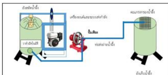
ภาพที่ 2 ภาพเครื่องสไลต์น้ำฝิ่งแบบอัตโนมัติ
