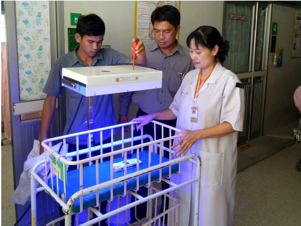
ภาพที่ ก-11 ทดสอบความเข้มของแสงเมื่อนำไปใช้ส่องไฟบนเตียงนอนทารกแบบไม่คลุมผ้า
