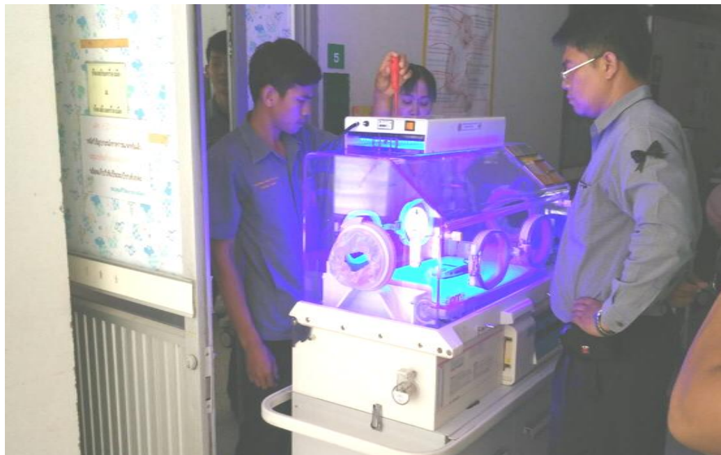
รูปแสดง การทดสอบวัดค่าความเข้มของเครื่องส่องไฟรักษาทารกภาวะตัวเหลืองแบบประหยัด รุ่น 2 เมื่อนำไปใช้ส่องไฟบนตู้อบทารกแรกเกิดวิกฤต
