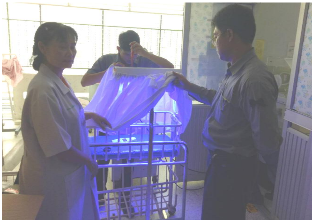
รูปแสดง การทดสอบวัดค่าความเข้มของเครื่องส่องไฟรักษาทารกภาวะตัวเหลืองแบบประหยัด รุ่น 2 เมื่อนำไปใช้ส่องไฟบนเตียงนอนทารกแบบคลุมผ้า
