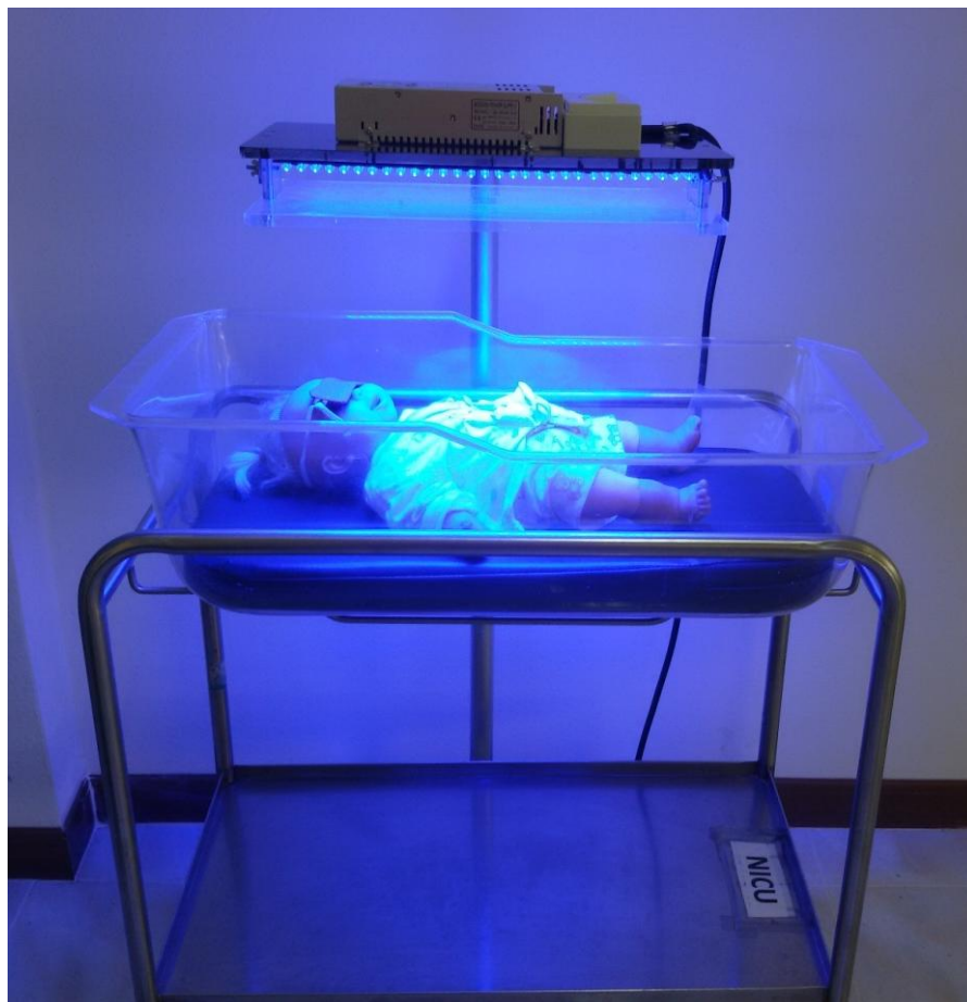
ภาพที่ ก-17 เครื่องส่องไฟรักษาทารกแรกเกิดภาวะตัวเหลืองแบบประหยัด รุ่น 1 ที่ผลิตขึ้น
