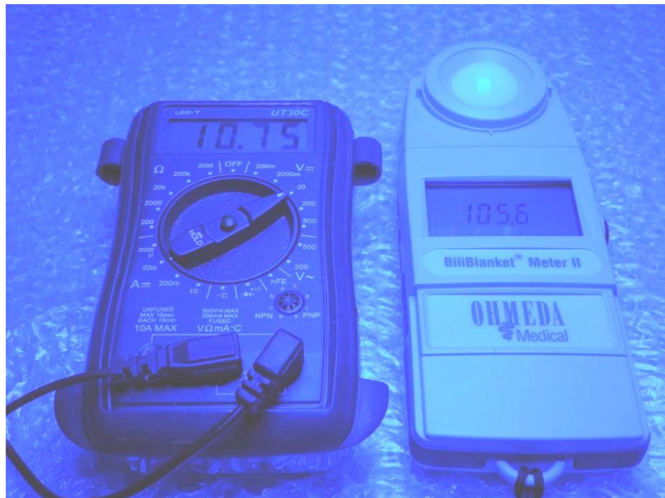
รูปแสดง การทดสอบวัดค่าความเข้มแสงและแรงดันไฟฟ้าของเครื่องส่องไฟรักษาทารกภาวะ ตัวเหลืองแบบประหยัด รุ่น 1
