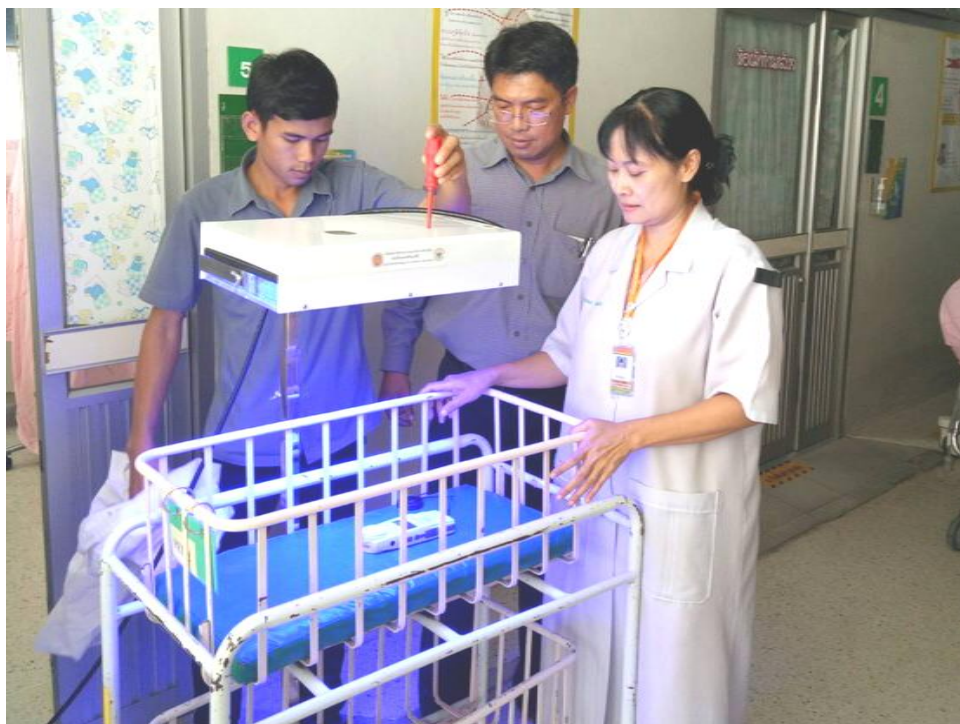
รูปแสดง การทดสอบวัดค่าความเข้มของเครื่องส่องไฟรักษาทารกภาวะตัวเหลืองแบบประหยัด รุ่น 2 เมื่อนำไปใช้ส่องไฟบนเตียงนอนทารกแบบไม่คลุมผ้า
