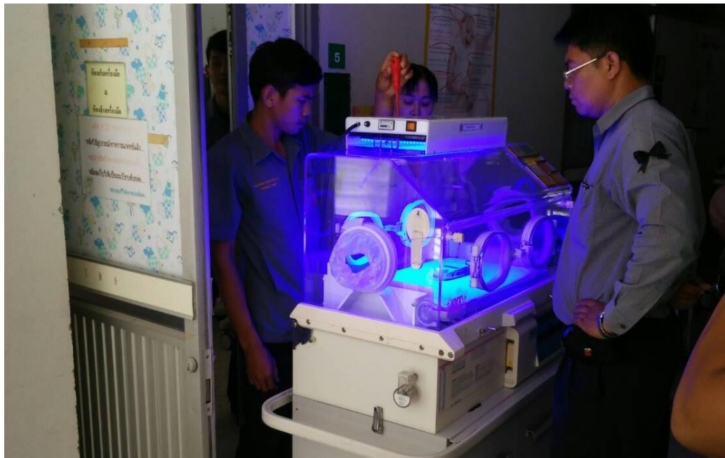
ภาพที่ ก-10 ทดสอบความเข้มของแสงเมื่อนำไปใช้ส่องไฟบนตู้อบทารกแรกเกิดวิกฤต
