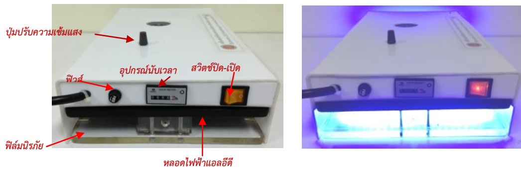
ภาพที่ 3.12 สร้างเครื่องส่องไฟรักษาทารกแรกเกิดภาวะตัวเหลืองแบบประหยัด รุ่น 2
