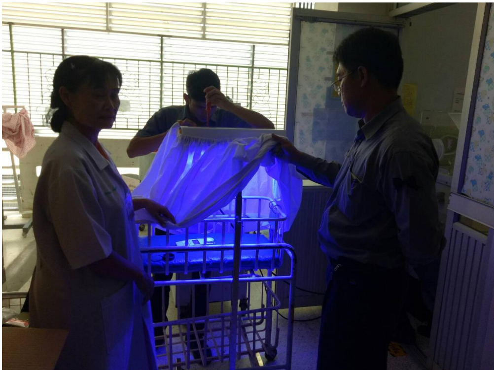
ภาพที่ ก-12 ทดสอบความเข้มของแสงเมื่อนำไปใช้ส่องไฟบนเตียงนอนทารกแบบคลุมผ้า
