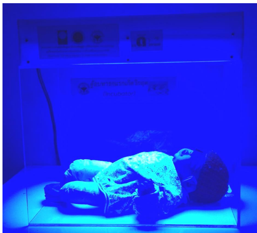
รูปแสดง การใช้งานเครื่องส่งไฟรักษาทารกแรกเกิดภาวะตัวเหลืองแบบประหยัด รุ่น 2 แบบใช้งานส่งไฟบนตู้อบทารกวิกฤต (Incubator)
