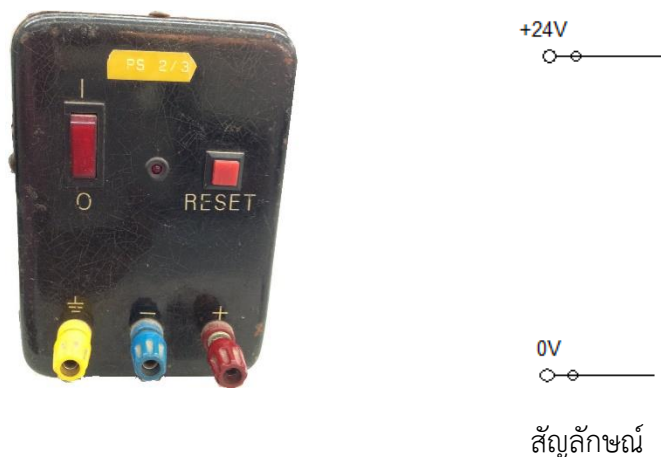
รูปภาพที่ 5.1.5 แหล่งจ่ายไฟฟ้ากระแสตรง 24 โวลต์
