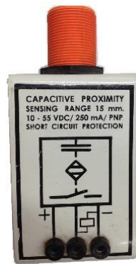
รูปภาพที่ 3.4 Capacitive Proximity Switch และวงจรการต่อใช้งาน
