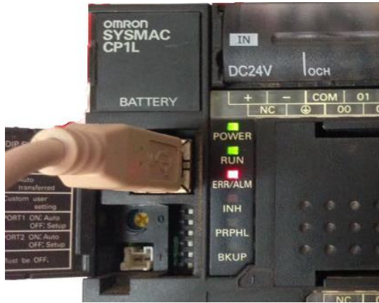
รูปภาพที่ 1.29 เชื่อมต่อ PLC OMRON รุ่น CP1L กับ PC
