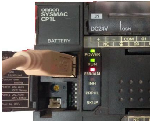
รูปภาพที่ 1.14 การเชื่อมต่อสาย USB กับ PLC
