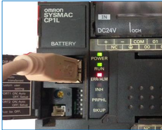
รูปภาพที่ 8.1.5 เชื่อมต่อ PLC OMRON รุ่น CP1L กับ PC
