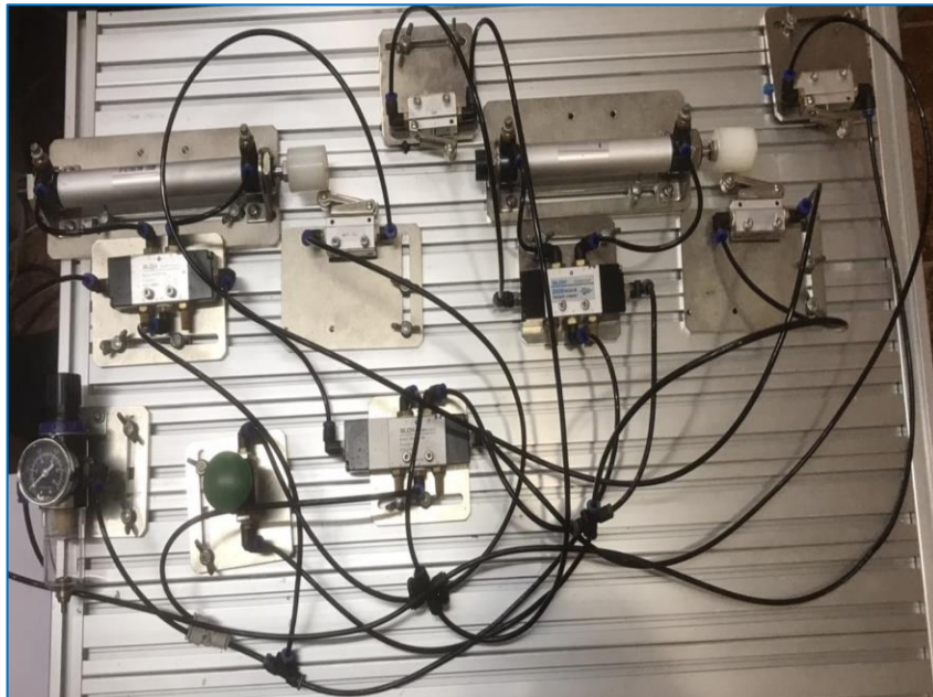
รูปภาพที่ 4.2.2 ภาพถ่ายวงจรควบคุมกระบอกสูบแบบแคสเคด เงื่อนไข 1+2+2-1-
