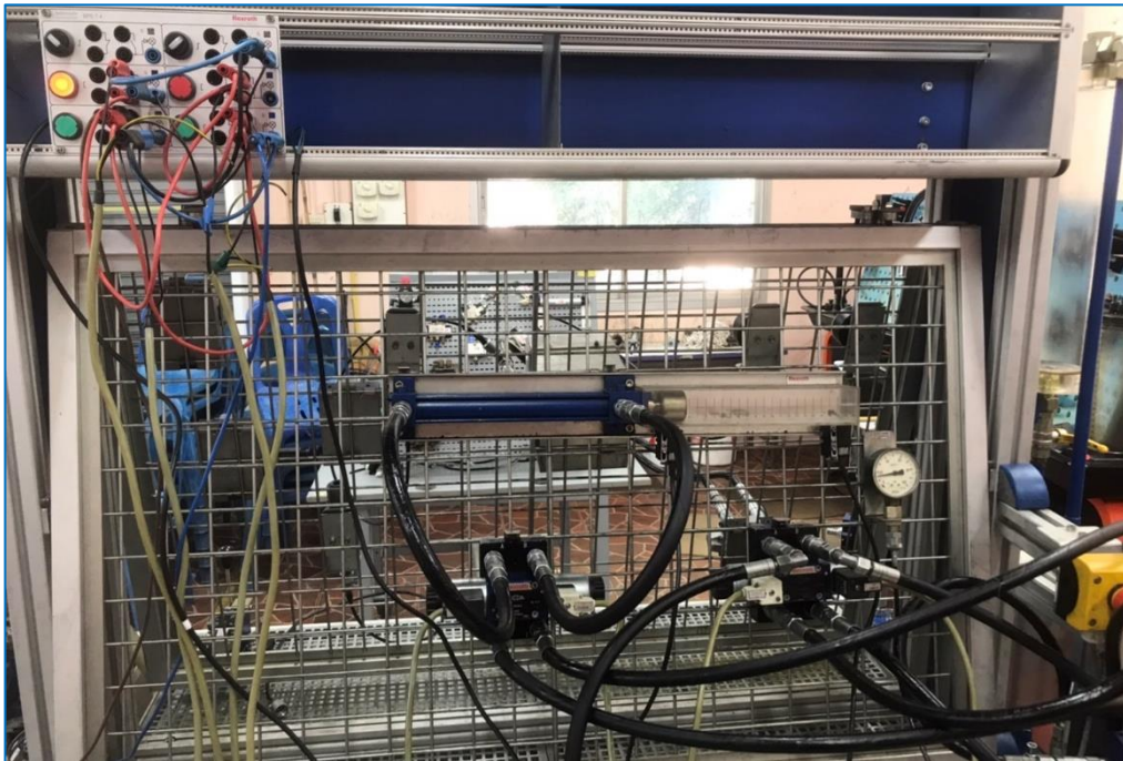
รูปภาพที่ 6.1.2 ภาพถ่ายวงจรไฮดรอลิกไฟฟ้าเบื้องต้น
