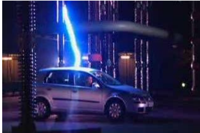
รูปที่ 5.21 การทดลองกับตัวถังของรถยนต์ 21
