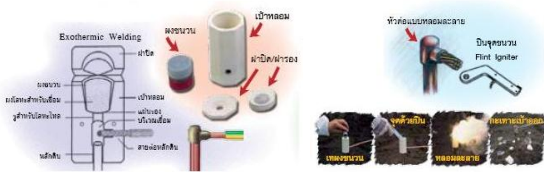
รูปที่ 4.12 การเชื่อมต่อด้วยผงทองแดงโดยเผาให้หลอมละลาย 10
