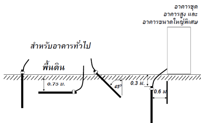
รูปที่ 4.14 การฝังแท่งหลักดิน 12
