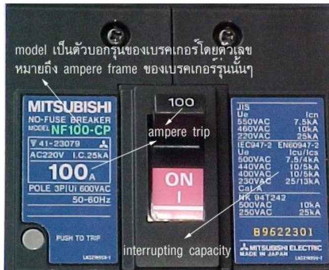
รูปที่ 3.22 ค่ากระแสต่างๆ ของเซอร์กิตเบรกเกอร์ 18
