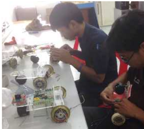
รูปที่ 3.3 การประกอบบอร์ดวงจรเข้ากับตัวหุ่นยนต์
