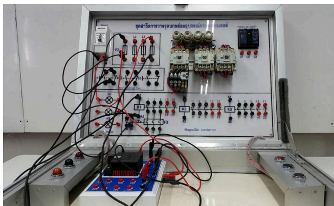
ภาพที่ 3-19 ทดสอบวงจรควบคุมการสตาร์ทมอเตอร์โดยตรง
