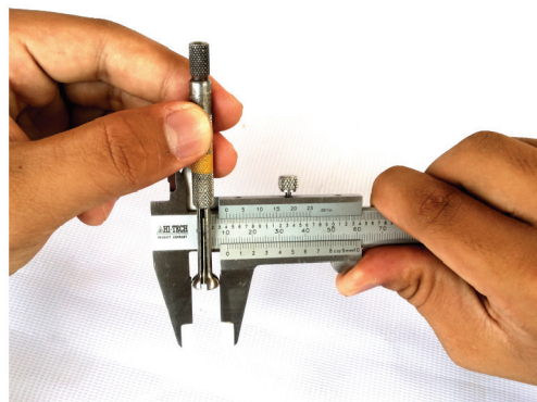
รูปที่ 5-19 การใช้เวอร์เนียวัดขนาดหัววัดถ่ายขนาด
