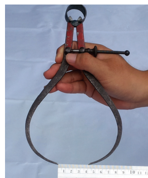
รูปที่ 5-4 การใช้คาลิปเปอร์ถ่ายขนาดชิ้นงานไปเปรียบเทียบกับบรรทัดเหล็ก
