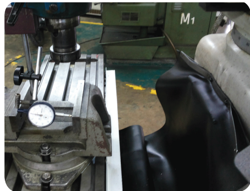
รูปที่ 8-20 การใช้นาฬิกาวัดตรวจสอบปากก้าบนเครื่องกัด
