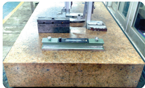
รูปที่ 6-45 การใช้ระดับน้ำเครื่องกลตรวจสอบระดับแท่นระดับ
