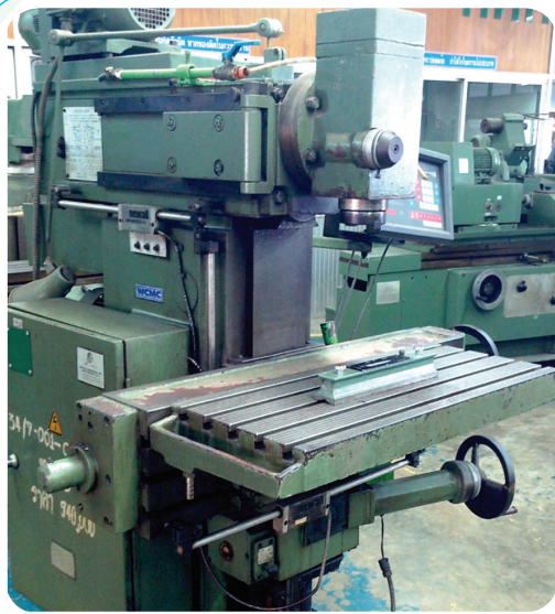
รูปที่ 6-46 การใช้ระดับน้ำเครื่องกลตรวจสอบระดับเครื่องกัด
