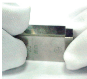
รูปที่ 7-44 ประกอบเกจแผ่นบางแผ่นแรกเข้ากับแผ่นหนาก่อนเต็มหน้า
