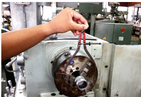
รูปที่ 5-4 การใช้คาลิปเปอร์ถ่ายขนาดชิ้นงานไปเปรียบเทียบกับบรรทัดเหล็ก
