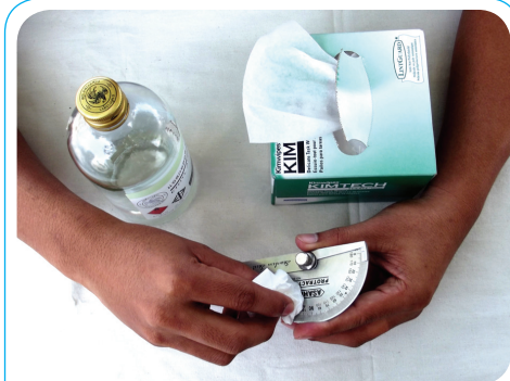
รูปที่ 6-28 การเช็ดทำความสะอาดใบวัดมุม
