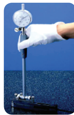
รูปที่ 7-51 ใช้เกจเหลี่ยมสอบเทียบบอร์เกจ
