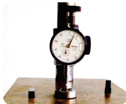
รูปที่ 8-24 คอมพาริเตอร์ตรวจสอบชิ้นงานกับเกจบล็อก
