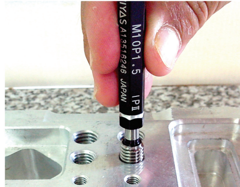
รูปที่ 7-18 เกลียวในผ่านด้านเสียไม่ได้ (No Go Side)
