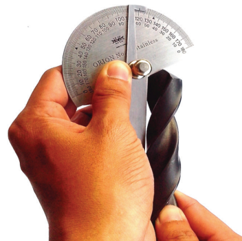
รูปที่ 6-24 การใช้ใบวัดมุมวัดขนาดมุมคมตัดดอกสว่าน
