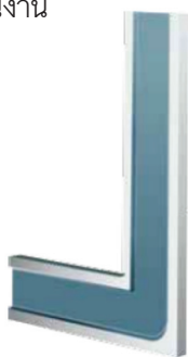
รูปที่ 6-5 ลักษณะของฉากเครื่องกลแบบตัวไอ
