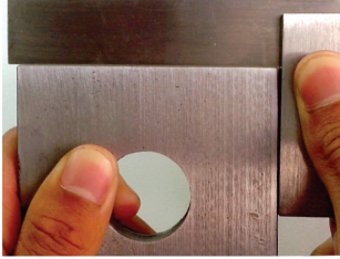
รูปที่ 6-9 ไบฉากสัมผัสแน่นตลอดผิวงาน
