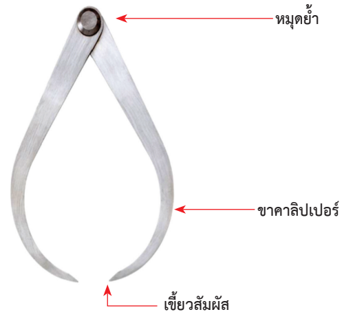
รูปที่ 5-1 คาลิเปอร์วัดนอกแบบปรับด้วยความฝืด
