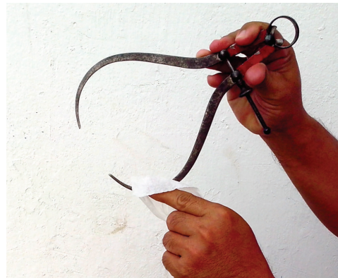
รูปที่ 5-24 ใช้ผ้าสะอาดเช็ดทำความสะอาด คาลิปเปอร์วัดนอกหลังใช้งาน
