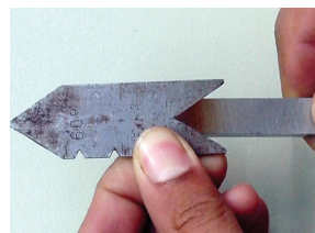
รูปที่ 7-9 การใช้เกจตรวจสอบมิดกึ่งเกลียวสามเหลี่ยม
