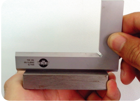
รูปที่ 6-16 ลักษณะการใช้ฉากตรวจสอบความเรียบของผิวชิ้นงาน
