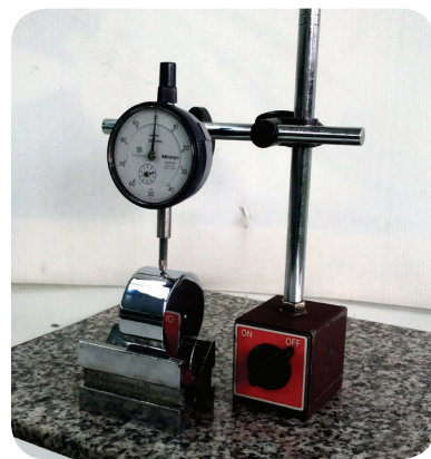
รูปที่ 8-21 การใช้นาฬิกาวัดตรวจสอบความกลมชิ้นงาน
