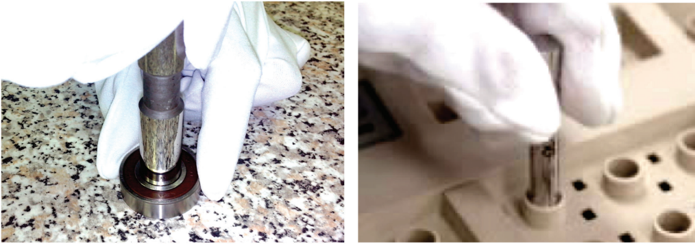
รูปที่ 7-58 ลักษณะการใช้พินเกจตรวจสอบขนาดชิ้นงาน
