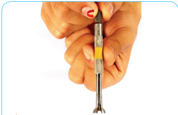
รูปที่ 5-15 การหมุนปรับขนาดเกจถ่ายขนาดรูในขนาดเล็ก
