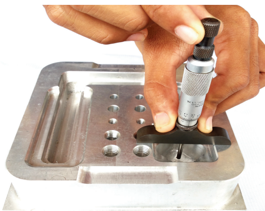
รูปที่ 4-54 การใช้ไมโครมิเตอร์วัดลึกวัดขนาดชิ้นงาน
