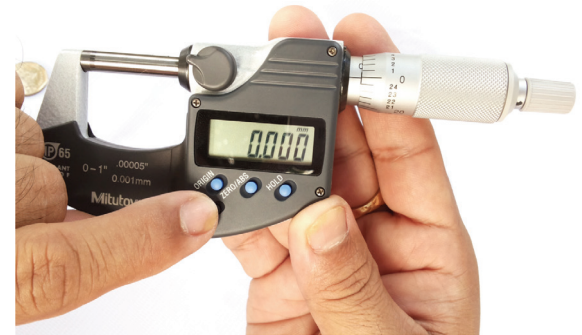
รูปที่ 4-28 การตั้งค่าใช้งานระบบเมตริกของไมโครมิเตอร์รุ่น 293-340
