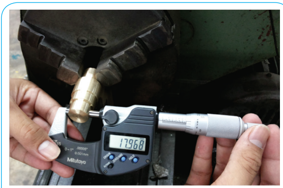
รูปที่ 4-31 การใช้ไมโครมิเตอร์ดิจิตอลวัดขนาดชิ้นงานบนเครื่องกลึง
