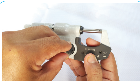
รูปที่ 4-25 การเปิดฝาครอบแบตเตอรี่ไมโครมิเตอร์แบบดิจิทัล
