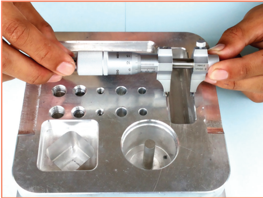
การใช้ไมโครมิเตอร์วัดในวัดขนาดภายในร่องชิ้นงาน
