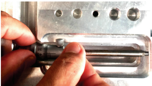
รูปที่ 4-48 การใช้ไมโครมิเตอร์วัดในวัดขนาดชิ้นงาน
