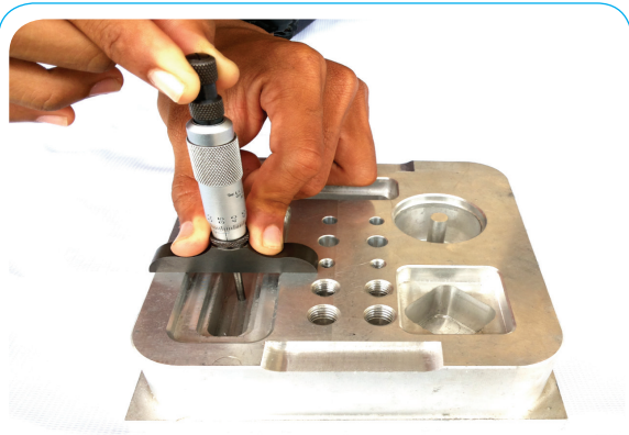
รูปที่ 4-53 การใช้ไมโครมิเตอร์วัดลึกวัดขนาดชิ้นงาน
