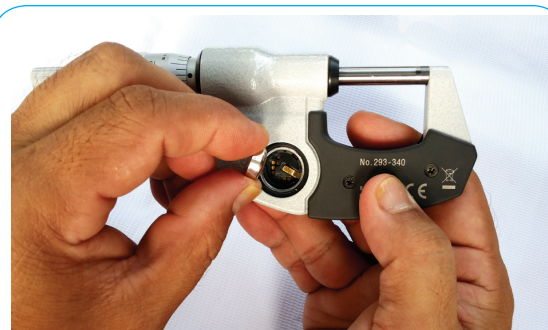
รูปที่ 4-26 การใส่แบตเตอรี่ไมโครมิเตอร์รุ่น 293-340
