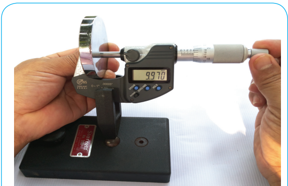
รูปที่ 4-30 การใช้ไมโครมิเตอร์ดิจิตอลร่วมกับอุปกรณ์จับยึดวัดขนาดชิ้นงาน
