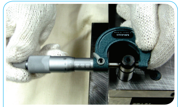
รูปที่ 4-18 การใช้ไมโครมิเตอร์วัดนอกวัดชิ้นงานที่อยู่กับที่
