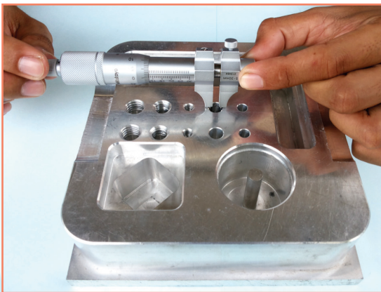
การใช้ไมโครมิเตอร์วัดในวัดขนาดความโตของรูชิ้นงาน
