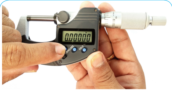
รูปที่ 4-27 การตั้งค่า Origin ให้กับไมโครมิเตอร์รุ่น 293-340
