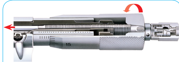
รูปที่ 4-2 หลักการทำงานของเกลียวไมโครมิเตอร์
