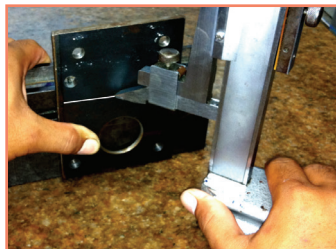
รูปที่ 3-40 การใช้เวอร์เนียไฮเกจตั้งขนาดความสูงแล้วนำมาขีดร่างแบบลงบนชิ้นงาน
