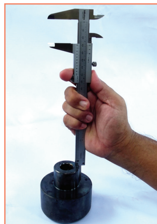
รูปที่ 3-20 การใช้ก้านวัดลึกวัดขนาดชิ้นงาน
