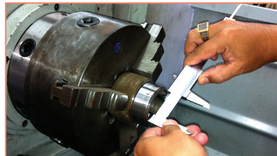
รูปที่ 3-19 การใช้เวอร์เนียร์วัดขนาดภายในชิ้นงานกลึง
