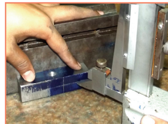
รูปที่ 3-40 การใช้เวอร์เนียไฮเกจตั้งขนาดความสูงแล้วนำมาขีดร่างแบบลงบนชิ้นงาน
