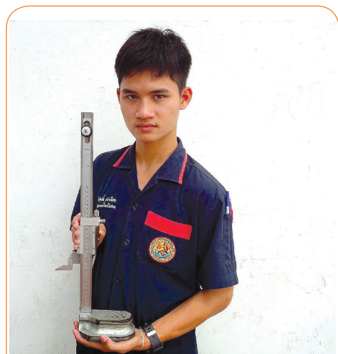
รูปที่ 3-43 การเคลื่อนย้ายเวอร์เนียไฮเกจ
