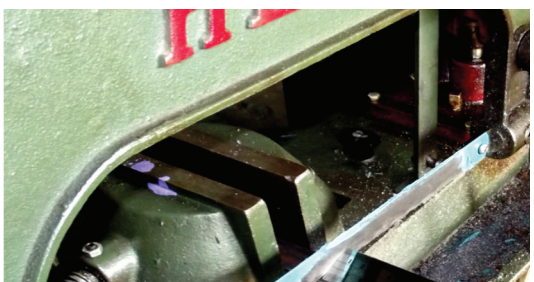
รูปที่ 2-21 การใช้บรรทัดเหล็กถ่ายขนาดลงชิ้นงานให้ได้ระยะความยาวที่ต้องการตัด
