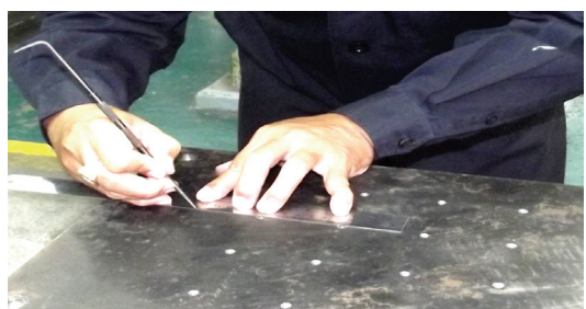
รูปที่ 2-22 การใช้บรรทัดเหล็กขีดร่างแบบชิ้นงาน
