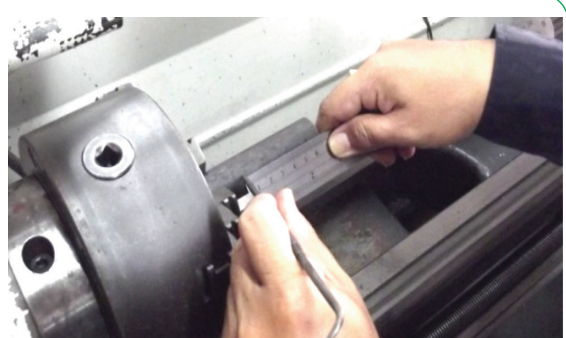
รูปที่ 2-19 การใช้บรรทัดเหล็กถ่ายขนาดลงชิ้นงานเพื่อขีดหมายระยะความยาวที่ต้องการกลึงปอก
