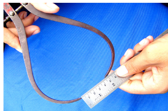
รูปที่ 1-3 ลักษณะการวัดชิ้นงานด้วยคาลิเปอร์แล้วไปถ่ายขนาดกับบรรทัดเหล็ก
