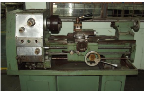
ภาพที่ 3-3 นำเครื่องกลึงมาทำความสะอาด และทำการปรับซ่อมให้อยู่ในสภาพใช้งาน
