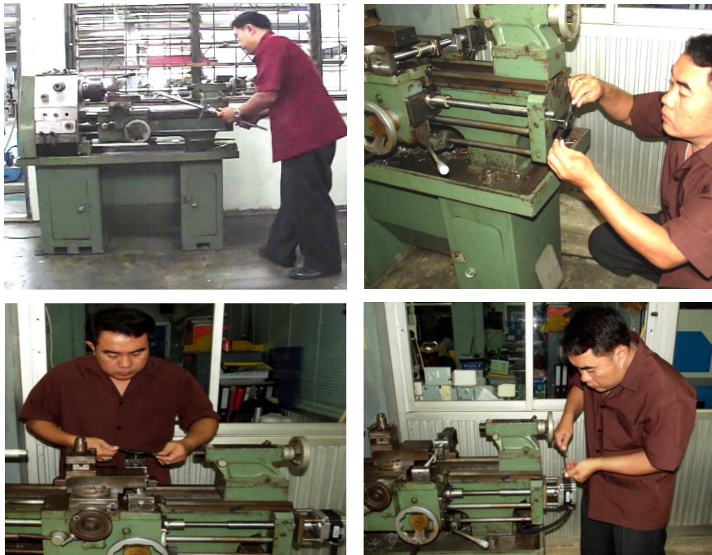
ภาพที่ 3-5 แสดงการติดตั้งสเต็ปมอเตอร์และชุดบอลสกรูทั้งแกน X และแกน Z
