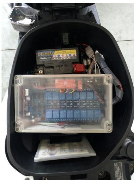
ภาพที่ 3-6 แสดงชุดควบคุมเพื่อจำลองปัญหาชุดฝึกปฏิบัติระบบฉีดเชื้อเพลิงอิเล็กทรอนิกส์รถจักรยานยนต์ สั่งการจากสมาร์ทโฟน
