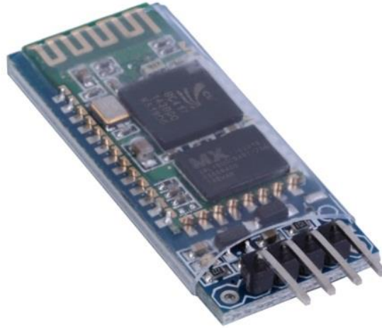
ภาพที่ 2-37 แสดง Bluetooth Serial Module (HC-06 Slave mode)
