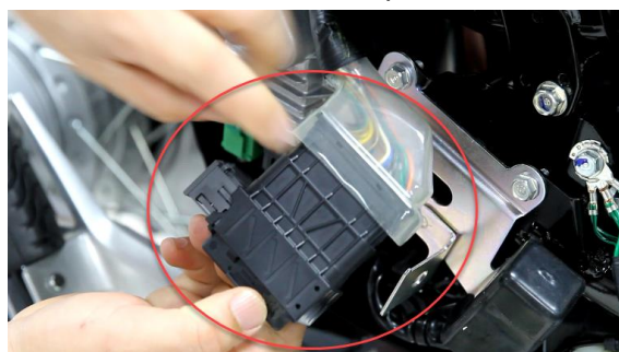
ภาพที่ 2-93 แสดงปลั๊กต่อระหว่างกล่อง ECU หรือ ECM กับชุดควบคุมจำลองสถานการณ์ปัญหา
