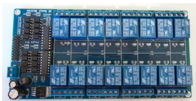
ภาพที่ 2-36 แสดง Relay 16 CH 12V 10A
