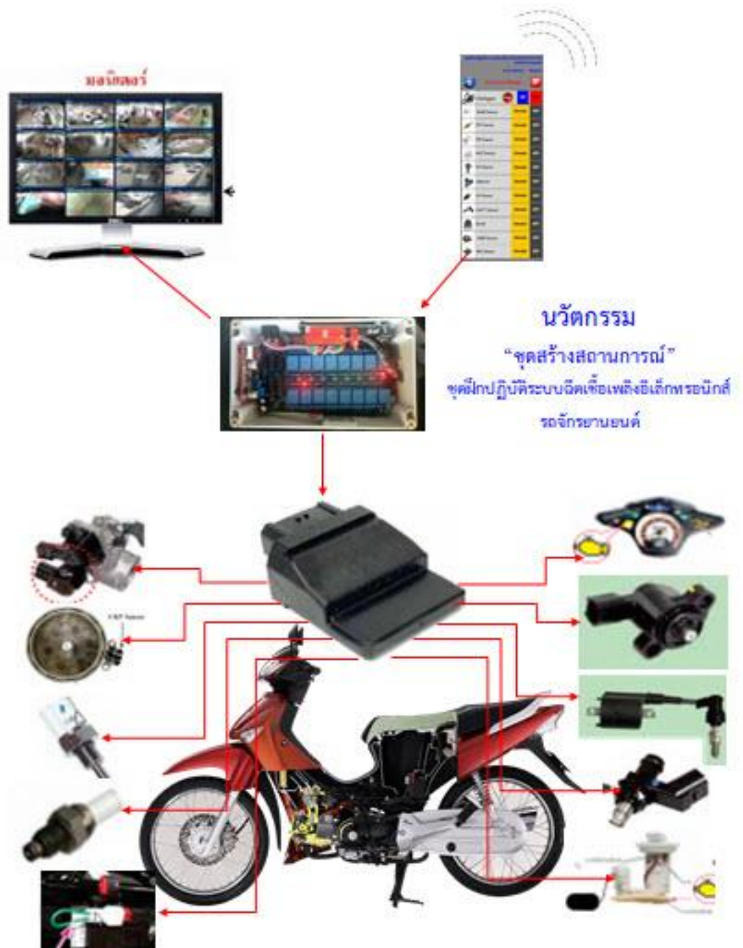
ภาพที่ 2-88 แสดงส่วนประกอบชุดฝึกปฏิบัติระบบฉีดเชื้อเพลิงอิเล็กทรอนิกส์รถจักรยานยนต์
