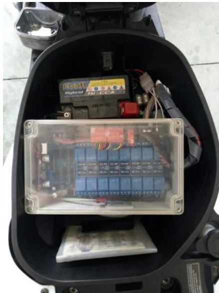
ภาพที่ 2-92 แสดงชุดควบคุมเพื่อจำลองสถานการณ์ปัญหาชุดฝึกปฏิบัติ
